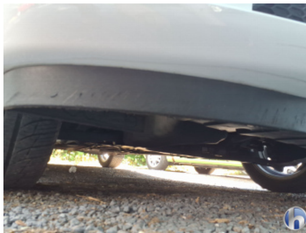
8. Frontspoiler Beschädigt - Erneuern
