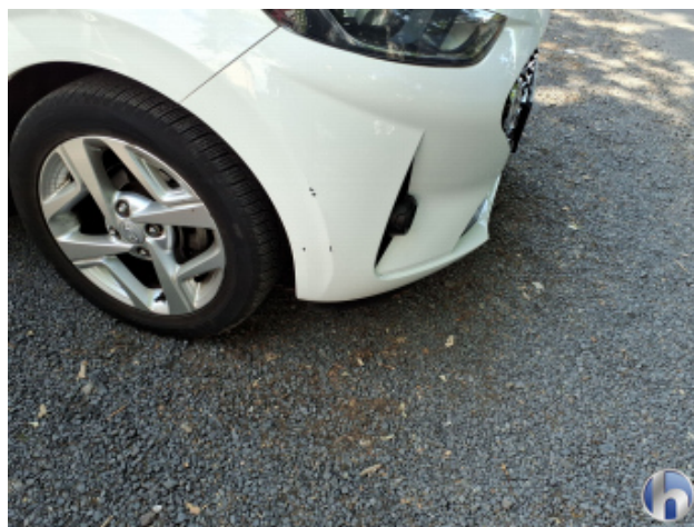
2. Stoßfänger Vorne Lackabplatzer - Lackieren
