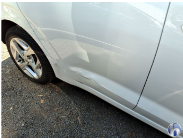
10. Fahrzeug rechts hinten Unfallschaden - Siehe Kalkulation
