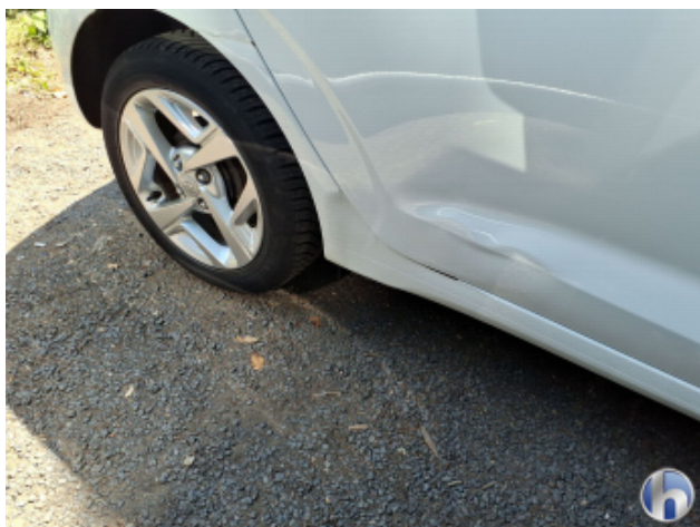
10. Fahrzeug rechts hinten Unfallschaden - Siehe Kalkulation
