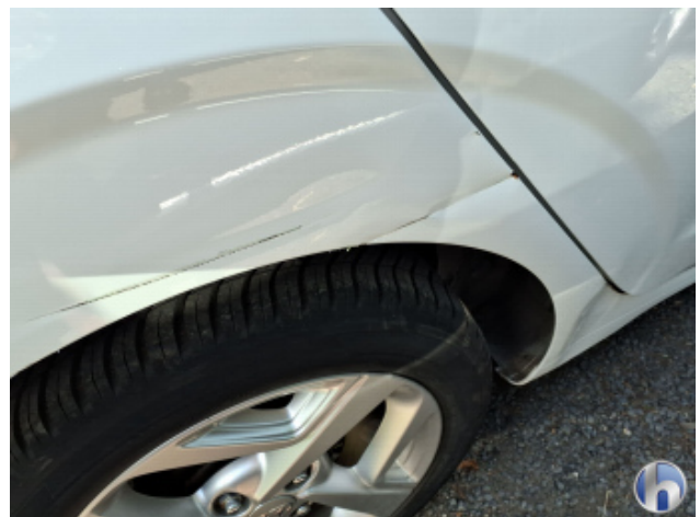
10. Fahrzeug rechts hinten Unfallschaden - Siehe Kalkulation
