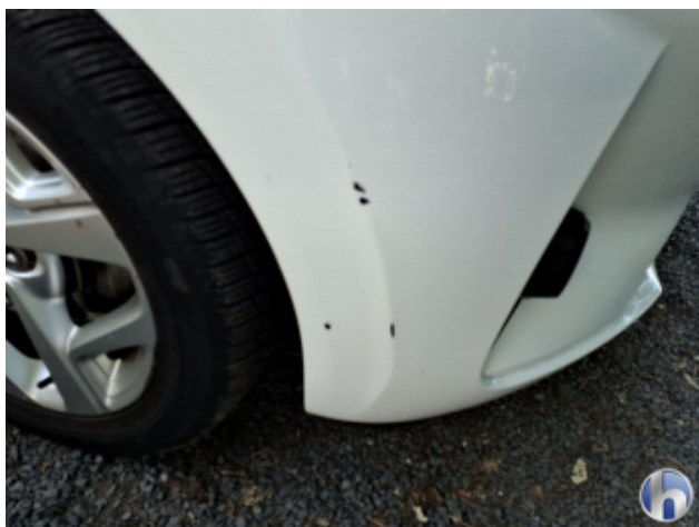
2. Stoßfänger Vorne Lackabplatzer - Lackieren
