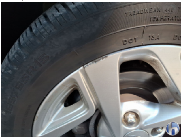
3. Felge Vorne - Links Kratzer - Smart Repair
