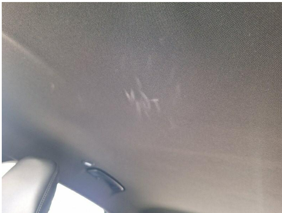
Bild 13 : Dachhimmel, verschmutzt, reinigen
