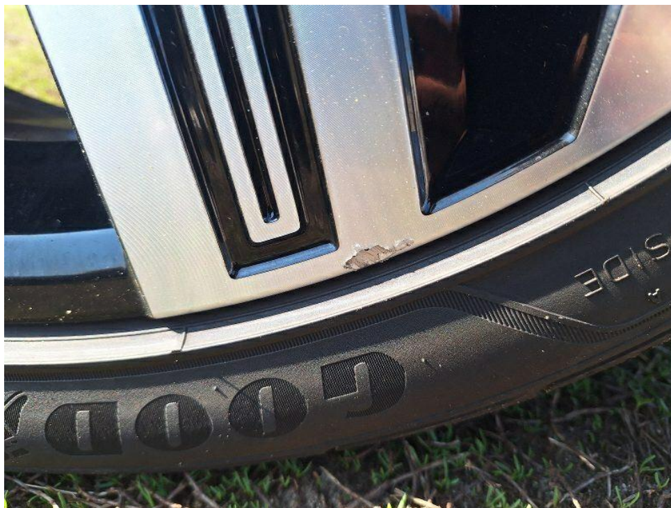
Bild 12 : Felge hinten rechts, eingekerbt, erneuern
