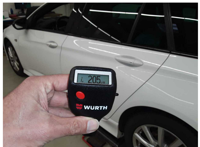
Door - rear left side: 205 µm
