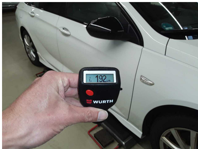
Door - front right side: 192 µm
