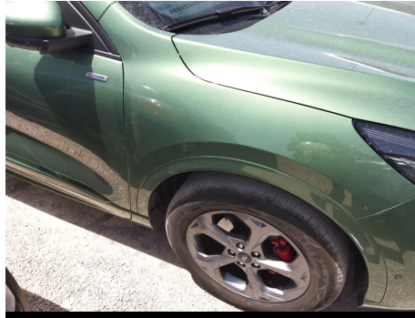
Aleta / Delantero Derecho / Abolladura
