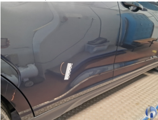
5. Tür Hinten - Rechts Delle - Smart Repair
