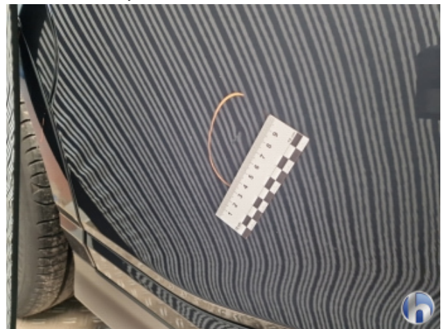
5. Tür Hinten - Rechts Delle - Smart Repair
