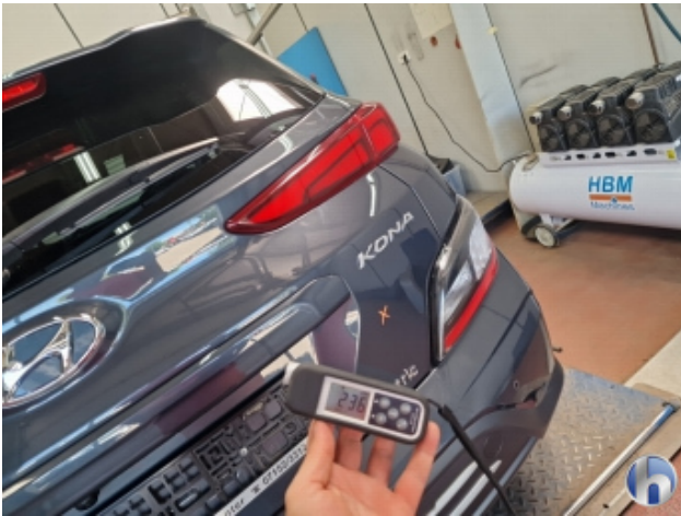
1. Heckklappe Nachlackiert - Ohne Reparatur
