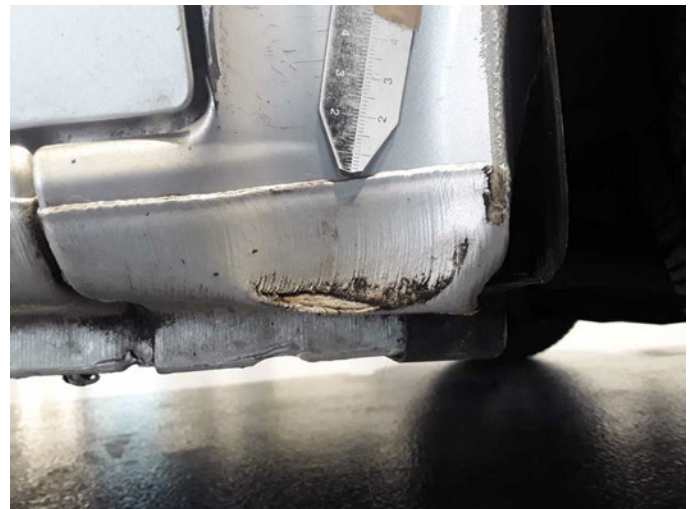
Beschädigung 23: Schweller rechts: Verkleidung - beschädigt - erneuern
