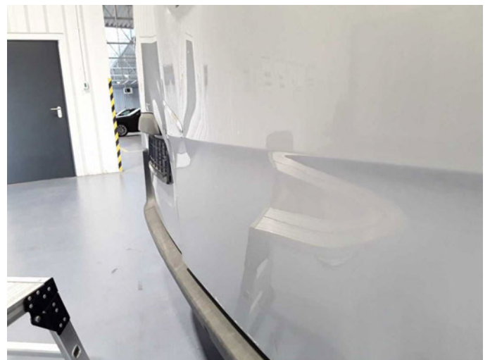
Beschädigung 16: Heckklappe/-tür: Hecktür rechts - verformt - erneuern
