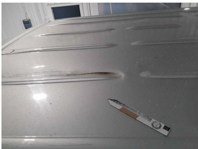
Beschädigung 33: Fahrzeugdach: Dach - Korrosion - erneuern
