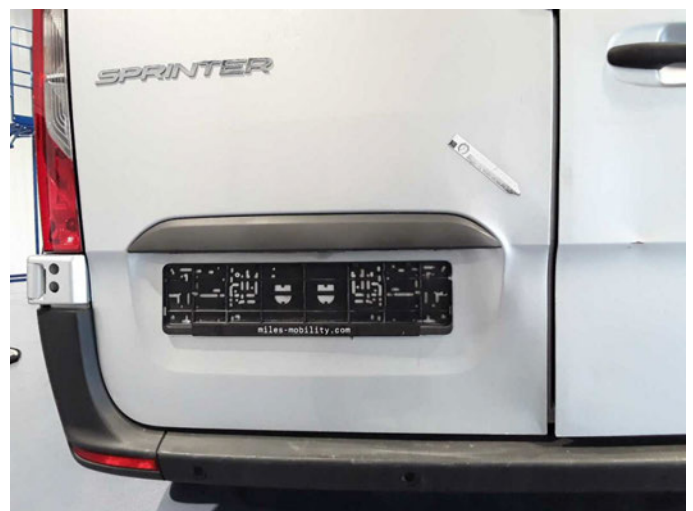
Beschädigung 15: Heckklappe/-tür: Hecktür links - verformt - erneuern
