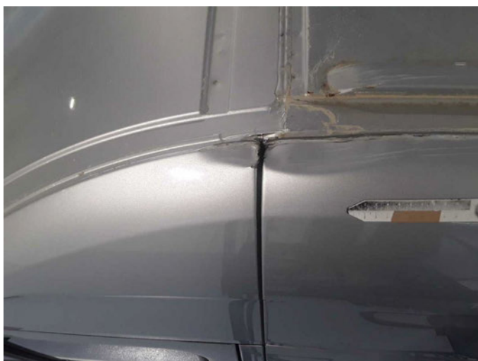
Beschädigung 28: Fahrzeugdach: Dach - beschädigt - erneuern
