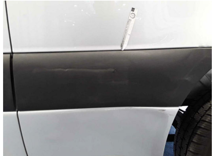
Beschädigung 10: Seitenwand links: Schutzleiste - beschädigt - erneuern
