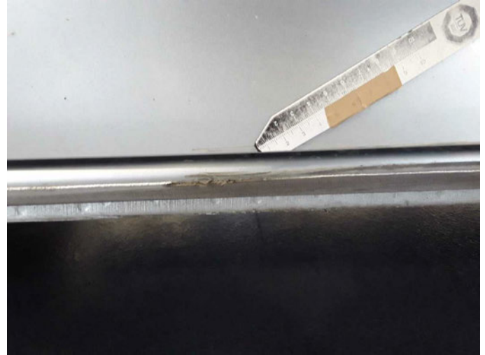
Beschädigung 20: Schweller rechts: Schweller - verformt - erneuern
