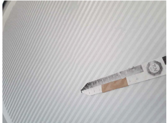
Beschädigung 18: Seitenwand rechts: Seitenwand - verformt - instandsetzen/lackieren (S3)
