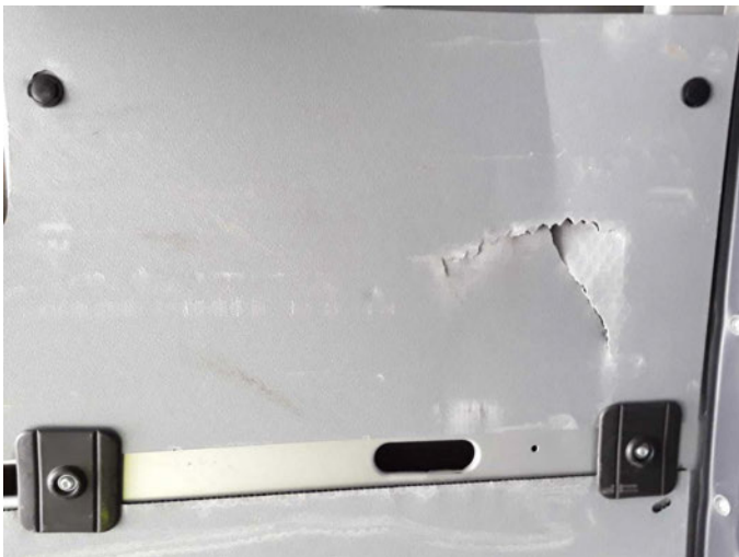
Beschädigung 3: Verkleidungen/Abdeckungen: Laderaumverkleidung links - beschädigt - erneuern
