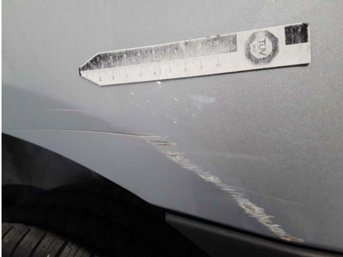
Beschädigung 8: Seitenwand links: Seitenwand - Delle / Lackschaden - instandsetzen/lackieren (S3)
