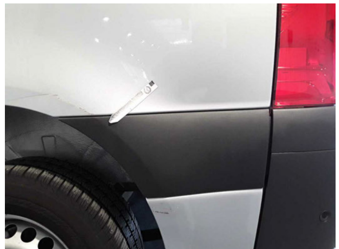
Beschädigung 12: Seitenwand links: Schutzleiste - verkratzt / verschürft - erneuern
