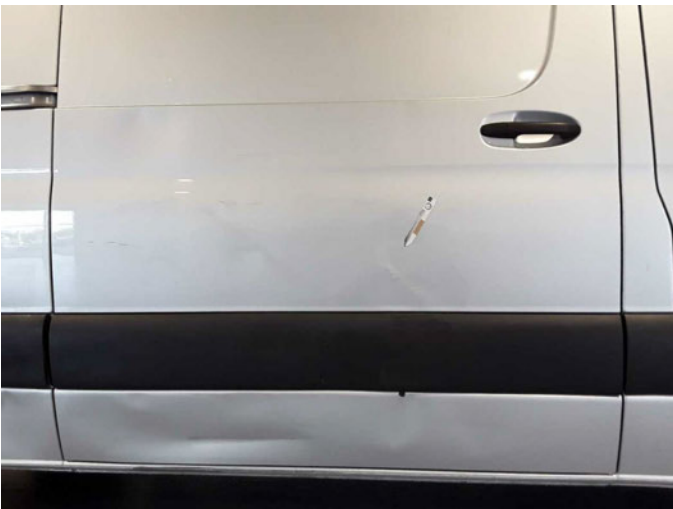
Beschädigung 19: Schiebetür rechts: Schiebetür - verformt - erneuern
