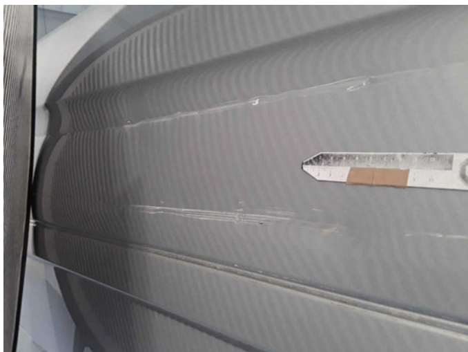
Beschädigung 31: Fahrzeugdach: Dachholm links - beschädigt - erneuern
