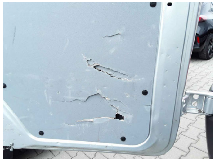
Beschädigung 2: Heckklappe/-tür: Verkl. Hecktür Sperrholz unten - beschädigt - erneuern
