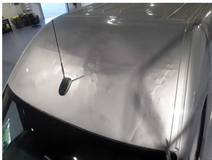
Beschädigung 28: Fahrzeugdach: Dach - beschädigt - erneuern
