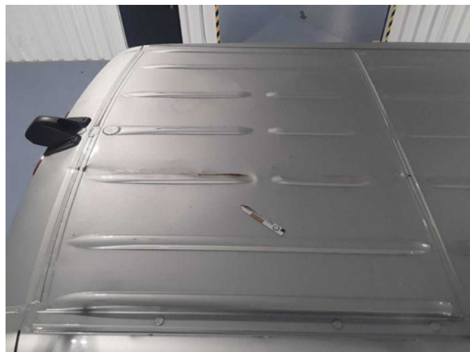
Beschädigung 33: Fahrzeugdach: Dach - Korrosion - erneuern
