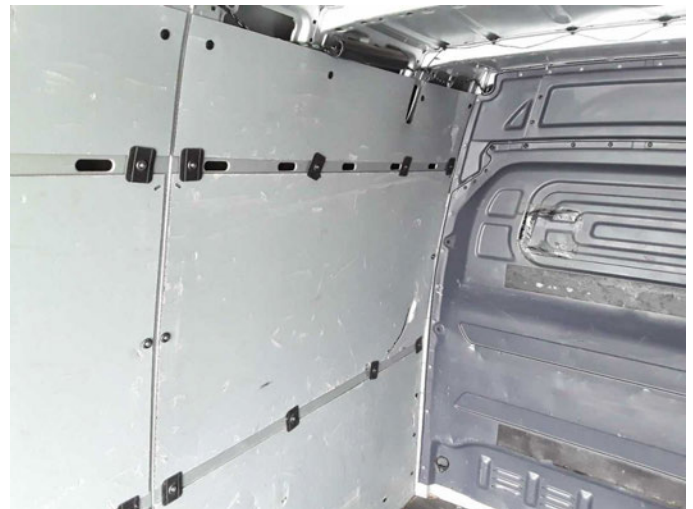
Beschädigung 3: Verkleidungen/Abdeckungen: Laderaumverkleidung links - beschädigt - erneuern
