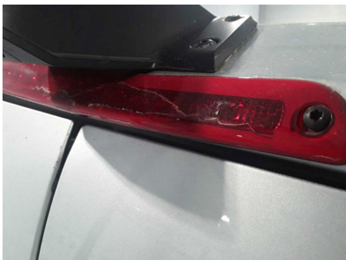
Beschädigung 32: Heckleuchte: Zusatzbremsleuchte - beschädigt - erneuern
