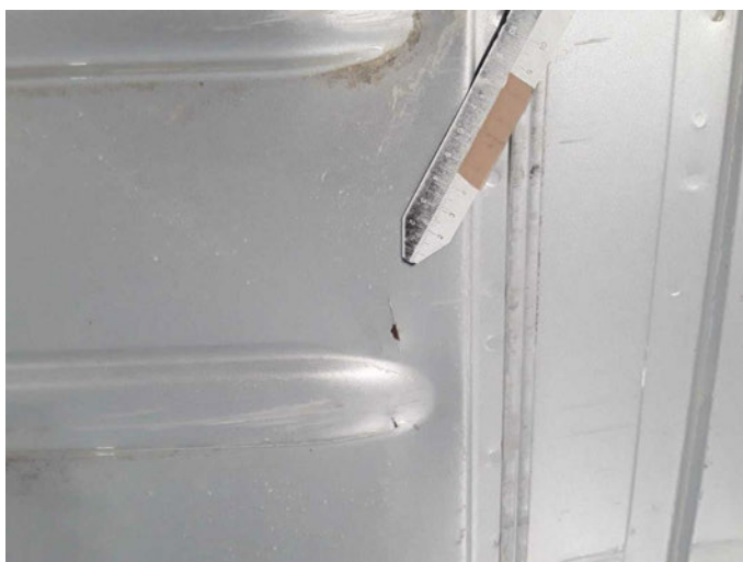
Beschädigung 30: Fahrzeugdach: Dach - verkratzt / verschürft - instandsetzen/lackieren (S3)
