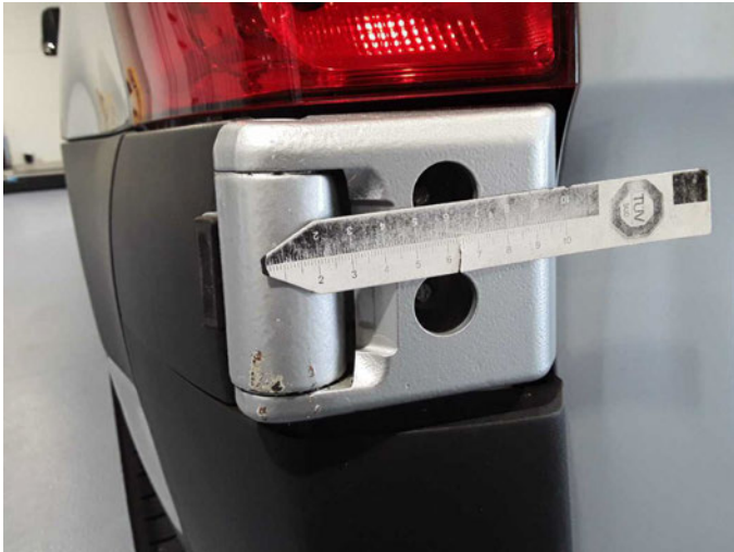
Beschädigung 13: Heckklappe/-tür: Scharnier - verkratzt / verschürft - lackieren
