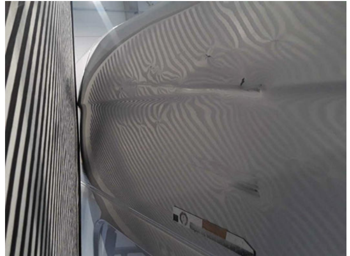
Beschädigung 31: Fahrzeugdach: Dachholm links - beschädigt - erneuern
