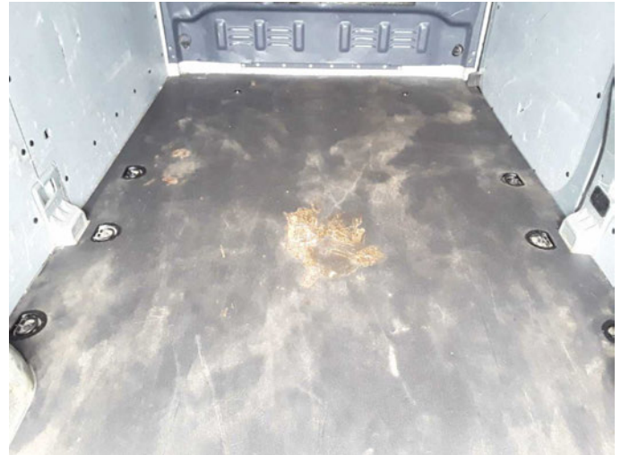
Beschädigung 1: Interieur: Laderaumboden - beschädigt - erneuern
