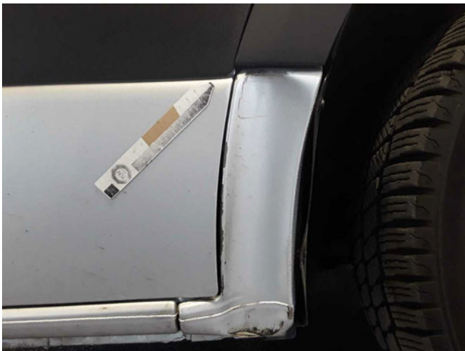
Beschädigung 23: Schweller rechts: Verkleidung - beschädigt - erneuern
