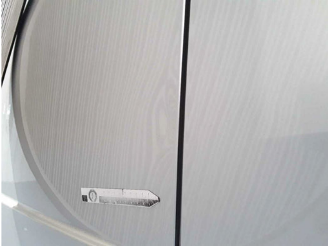
Beschädigung 15: Heckklappe/-tür: Hecktür links - verformt - erneuern
