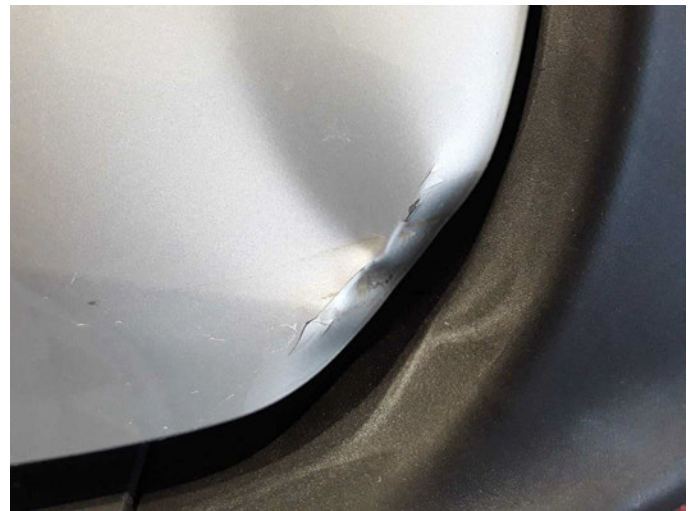
Beschädigung 16: Heckklappe/-tür: Hecktür rechts - verformt - erneuern
