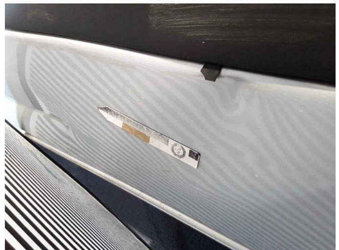
Beschädigung 19: Schiebetür rechts: Schiebetür - verformt - erneuern
