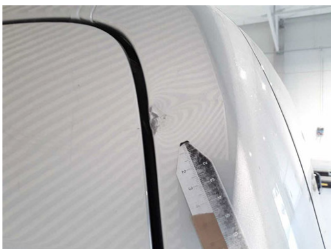
Beschädigung 17: Karosserie: D-Säule rechts - Delle / Lackschaden - instandsetzen/lackieren (S3)
