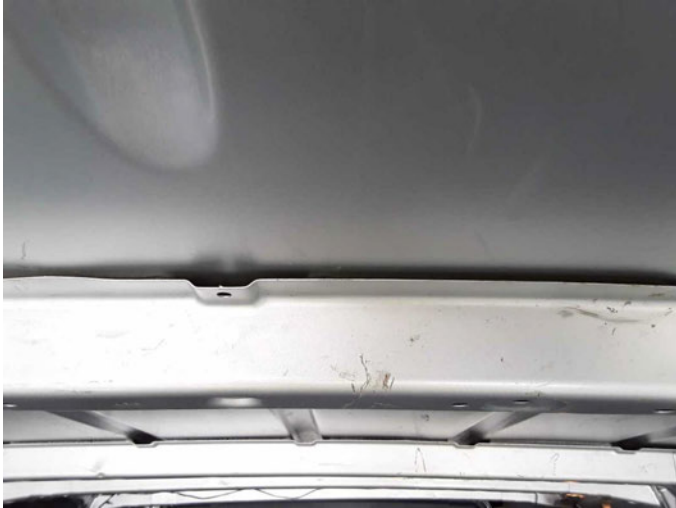
Beschädigung 5: Verkleidungen/Abdeckungen: Dachverkleidung Mitte - entspricht nicht den Herstellervorgaben - instandsetzen und lackieren
