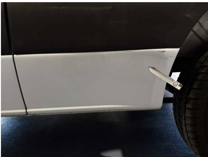
Beschädigung 9: Schweller links: Schweller - beschädigt - erneuern
