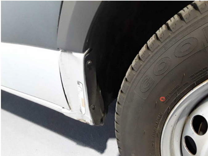
Beschädigung 24: Karosserie: Radhaus vorn rechts - beschädigt - erneuern
