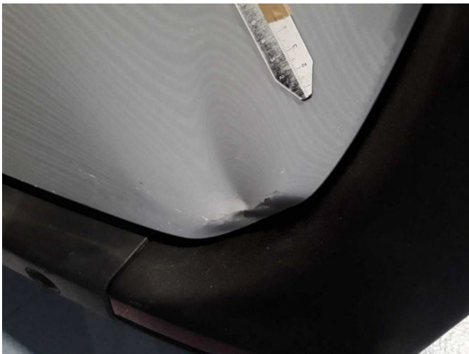
Beschädigung 16: Heckklappe/-tür: Hecktür rechts - verformt - erneuern
