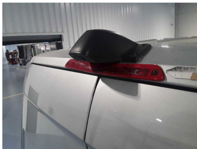
Beschädigung 32: Heckleuchte: Zusatzbremsleuchte - beschädigt - erneuern
