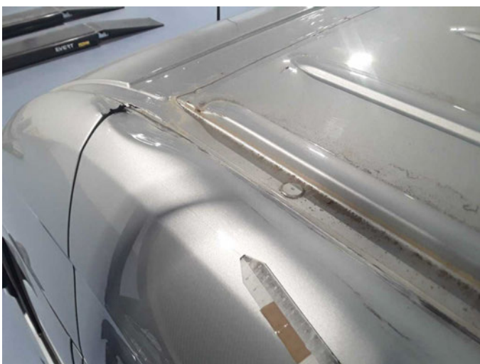
Beschädigung 31: Fahrzeugdach: Dachholm links - beschädigt - erneuern
