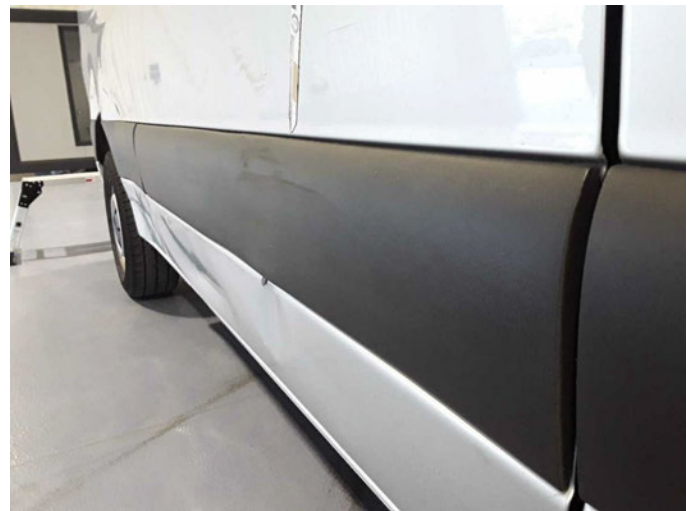
Beschädigung 21: Schiebetür rechts: Schutzleiste - verkratzt / verschürft - erneuern
