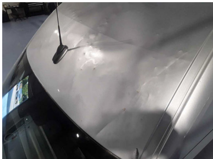
Beschädigung 28: Fahrzeugdach: Dach - beschädigt - erneuern
