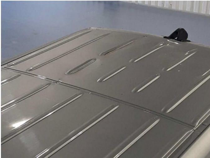
Beschädigung 30: Fahrzeugdach: Dach - verkratzt / verschürft - instandsetzen/lackieren (S3)
