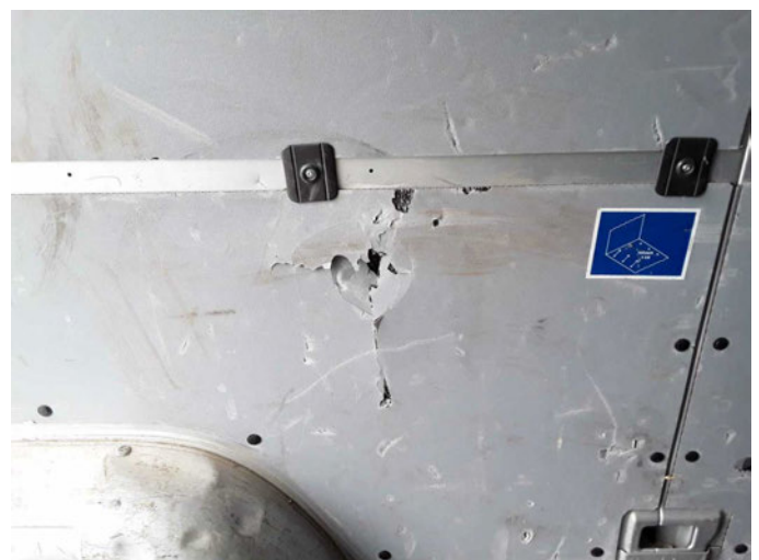
Beschädigung 3: Verkleidungen/Abdeckungen: Laderaumverkleidung links - beschädigt - erneuern
