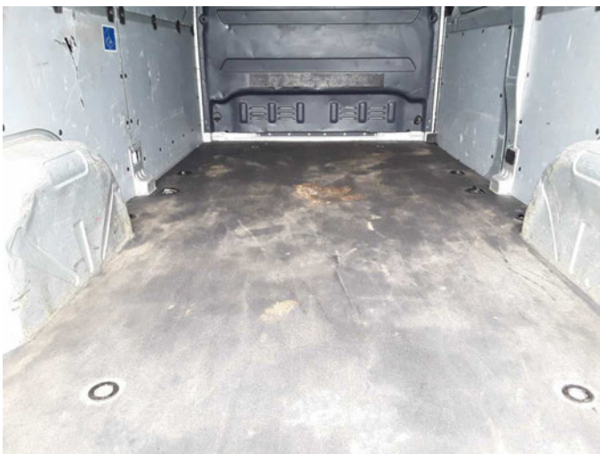
Beschädigung 1: Interieur: Laderaumboden - beschädigt - erneuern
