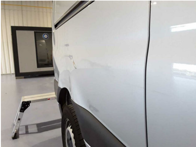
Beschädigung 18: Seitenwand rechts: Seitenwand - verformt - instandsetzen/lackieren (S3)
