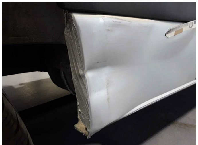
Beschädigung 20: Schweller rechts: Schweller - verformt - erneuern
