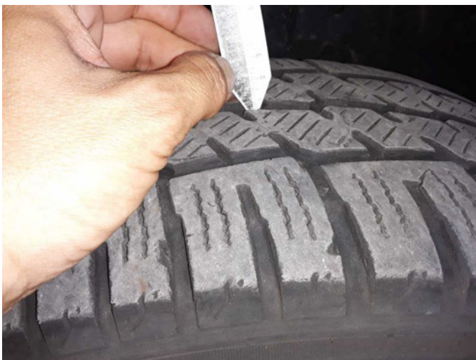
Beschädigung 7: Rad/Reifen: Reifen vorn links - verschlissen - erneuern
