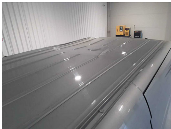
Beschädigung 33: Fahrzeugdach: Dach - Korrosion - erneuern
