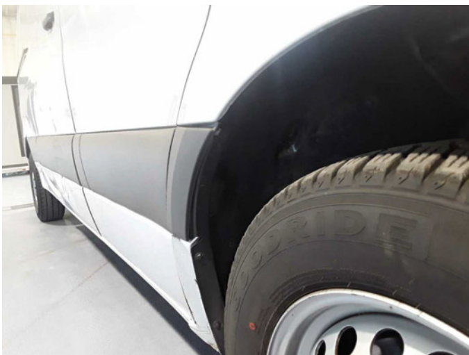
Beschädigung 25: Kotflügel rechts: Zierleiste, -gitter - beschädigt - erneuern
