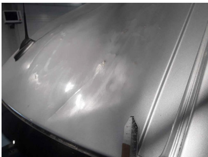
Beschädigung 28: Fahrzeugdach: Dach - beschädigt - erneuern
