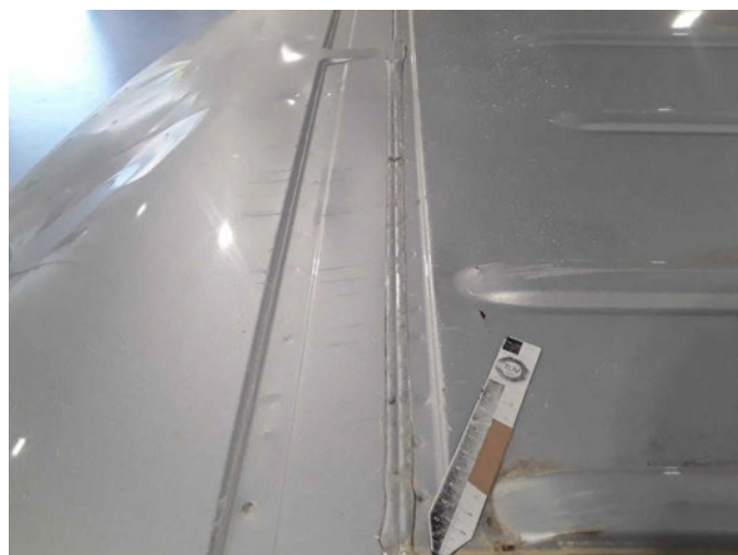
Beschädigung 29: Fahrzeugdach: Dach - beschädigt - instandsetzen/lackieren (S3)
