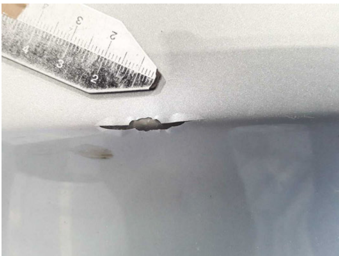
Beschädigung 16: Heckklappe/-tür: Hecktür rechts - verformt - erneuern
