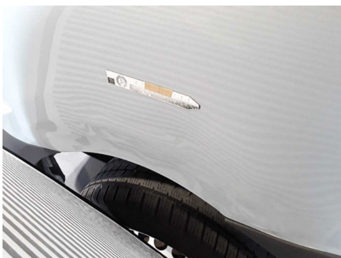
Beschädigung 18: Seitenwand rechts: Seitenwand - verformt - instandsetzen/lackieren (S3)
