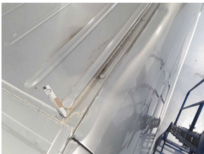
Beschädigung 29: Fahrzeugdach: Dach - beschädigt - instandsetzen/lackieren (S3)
