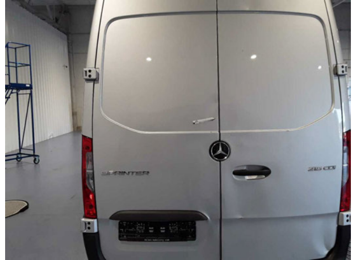
Beschädigung 15: Heckklappe/-tür: Hecktür links - verformt - erneuern
