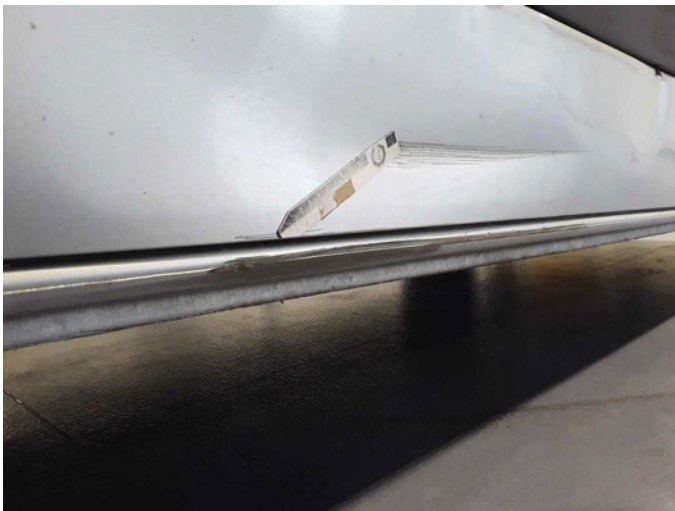
Beschädigung 20: Schweller rechts: Schweller - verformt - erneuern
