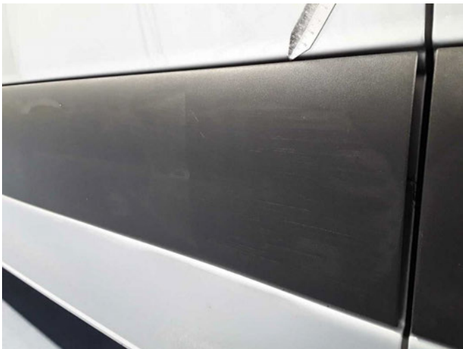
Beschädigung 11: Seitenwand links: Schutzleiste - verkratzt / verschürft - erneuern
