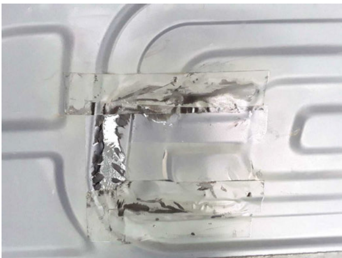
Beschädigung 4: Fahrerhaus: Rückwand - beschädigt - erneuern
