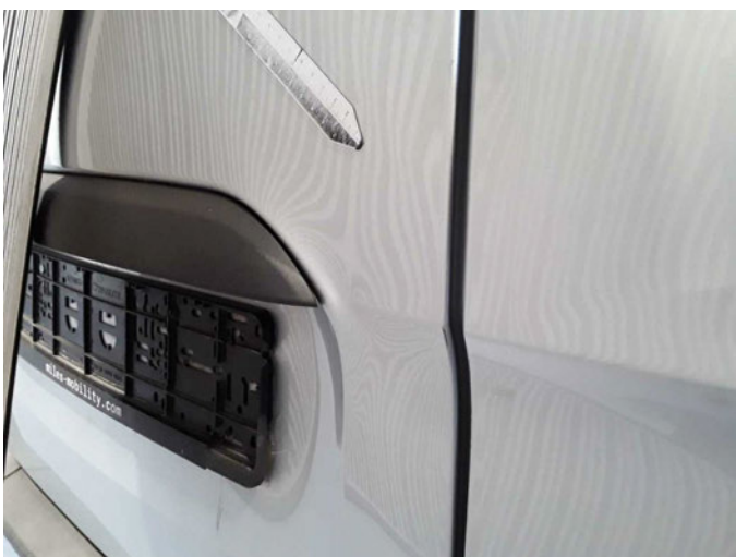
Beschädigung 15: Heckklappe/-tür: Hecktür links - verformt - erneuern
