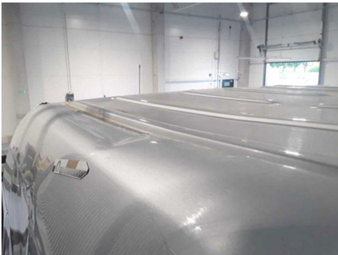
Beschädigung 31: Fahrzeugdach: Dachholm links - beschädigt - erneuern
