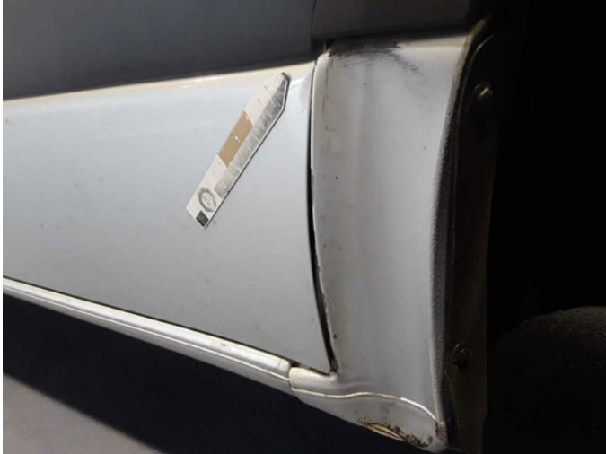
Beschädigung 22: Tür vorn rechts: Tür - beschädigt - erneuern
