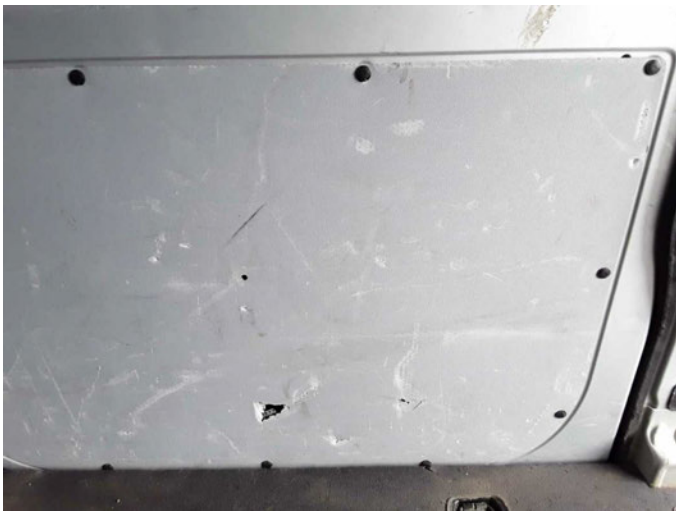
Beschädigung 6: Schiebetür rechts: Verkleidung Sperrholz unten - beschädigt - erneuern
