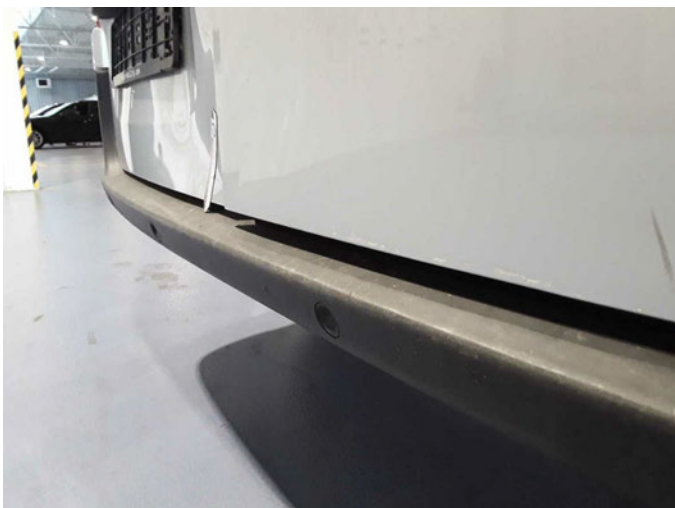
Beschädigung 14: Stossfänger hinten: Stossfänger hinten (unlackiert) - verkratzt / verschürft - instandsetzen und lackieren
