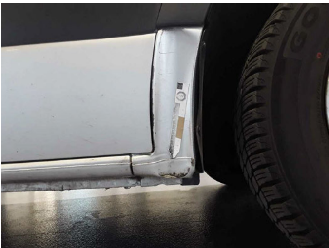
Beschädigung 23: Schweller rechts: Verkleidung - beschädigt - erneuern
