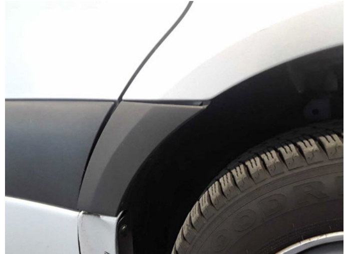
Beschädigung 25: Kotflügel rechts: Zierleiste, -gitter - beschädigt - erneuern
