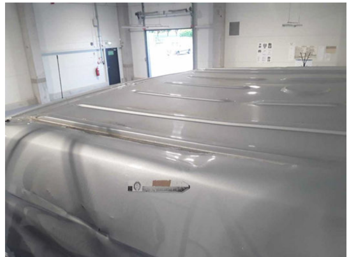
Beschädigung 31: Fahrzeugdach: Dachholm links - beschädigt - erneuern
