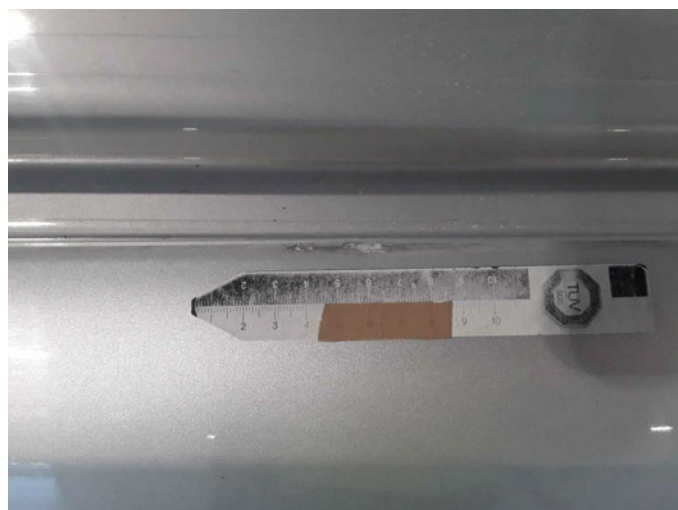
Beschädigung 34: Fahrzeugdach: Dachholm rechts - verkratzt / verschürft - instandsetzen/lackieren (S3)
