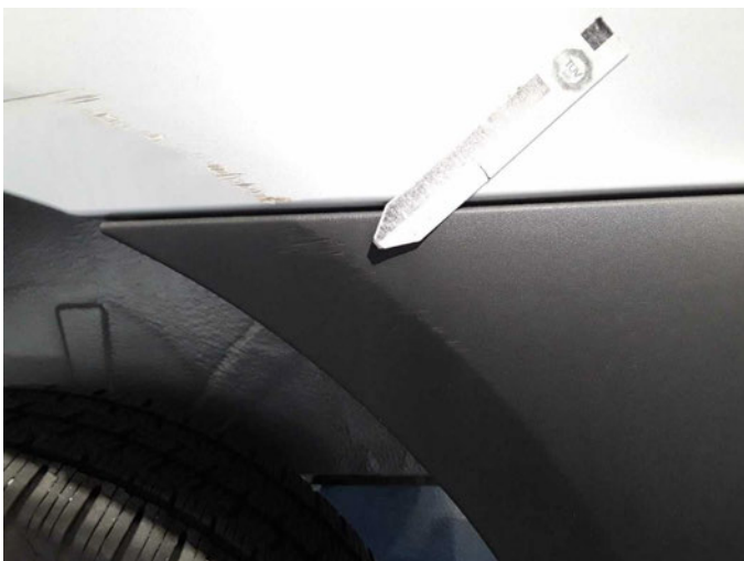
Beschädigung 12: Seitenwand links: Schutzleiste - verkratzt / verschürft - erneuern
