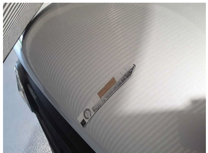
Beschädigung 27: Motorhaube: Motorhaube - Delle(n) - sanft instandsetzen
