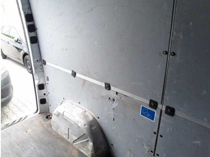
Beschädigung 3: Verkleidungen/Abdeckungen: Laderaumverkleidung links - beschädigt - erneuern
