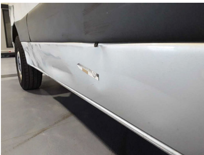
Beschädigung 19: Schiebetür rechts: Schiebetür - verformt - erneuern
