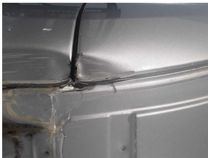
Beschädigung 28: Fahrzeugdach: Dach - beschädigt - erneuern
