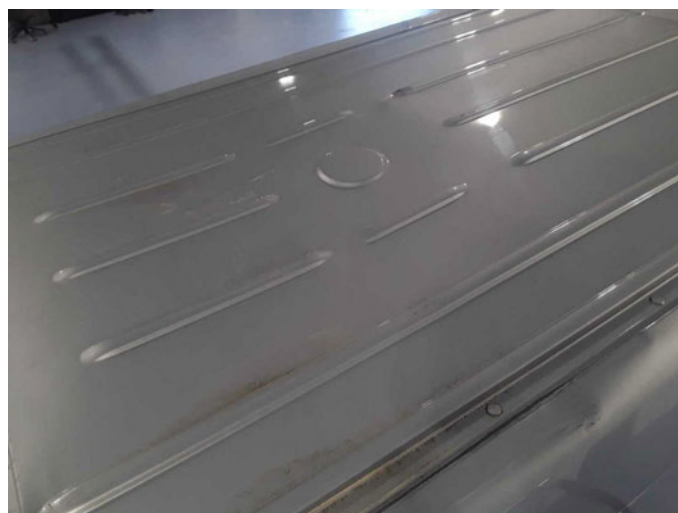
Beschädigung 30: Fahrzeugdach: Dach - verkratzt / verschürft - instandsetzen/lackieren (S3)
