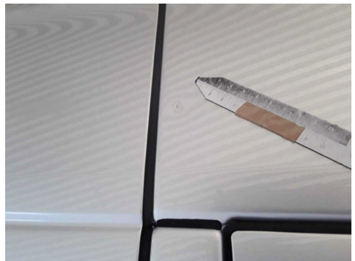
Beschädigung 26: Fahrzeugdach: Dachholm rechts - Delle / Lackschaden - instandsetzen/lackieren (S3)
