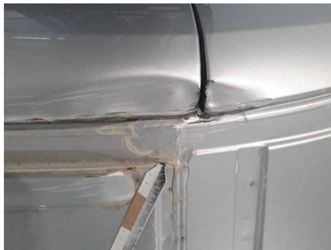
Beschädigung 29: Fahrzeugdach: Dach - beschädigt - instandsetzen/lackieren (S3)
