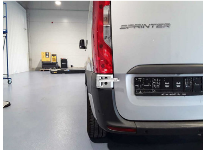
Beschädigung 13: Heckklappe/-tür: Scharnier - verkratzt / verschürft - lackieren
