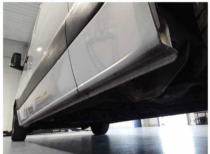
Beschädigung 9: Schweller links: Schweller - beschädigt - erneuern
