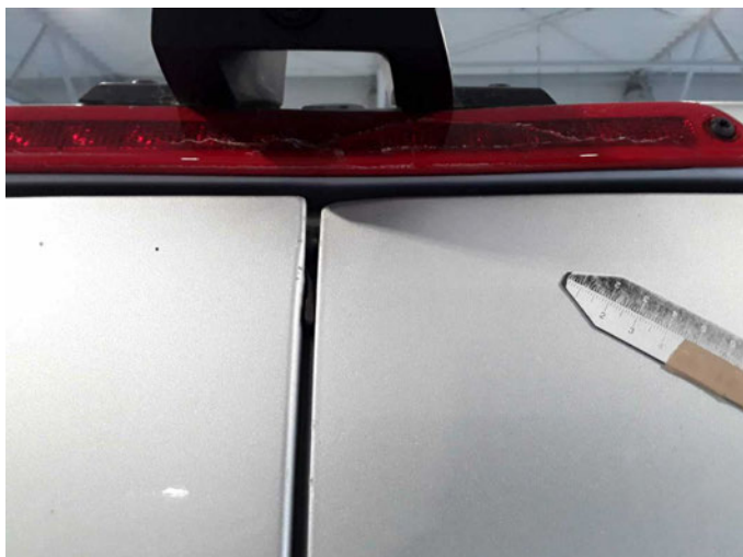
Beschädigung 16: Heckklappe/-tür: Hecktür rechts - verformt - erneuern
