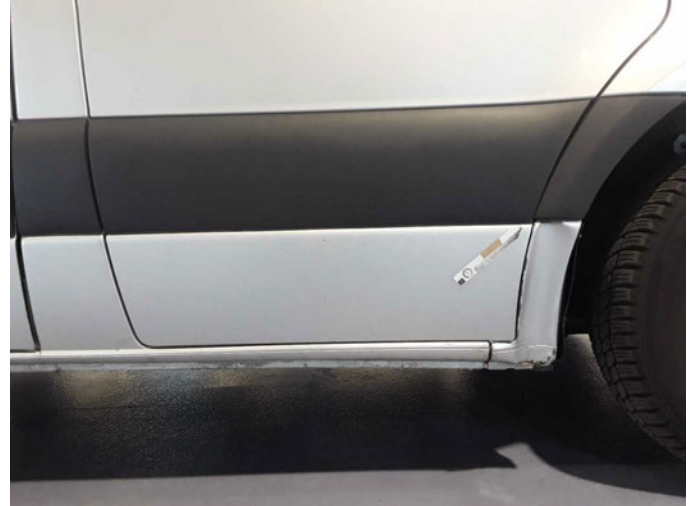
Beschädigung 22: Tür vorn rechts: Tür - beschädigt - erneuern
