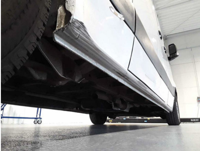
Beschädigung 20: Schweller rechts: Schweller - verformt - erneuern
