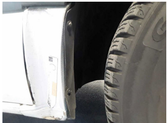
Beschädigung 24: Karosserie: Radhaus vorn rechts - beschädigt - erneuern
