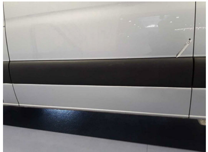
Beschädigung 11: Seitenwand links: Schutzleiste - verkratzt / verschürft - erneuern
