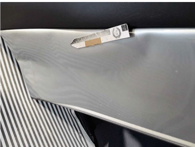
Beschädigung 20: Schweller rechts: Schweller - verformt - erneuern
