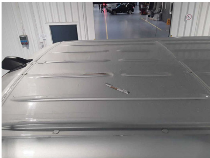
Beschädigung 33: Fahrzeugdach: Dach - Korrosion - erneuern
