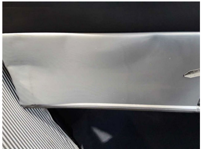
Beschädigung 20: Schweller rechts: Schweller - verformt - erneuern
