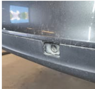
10.3.2 - Övrigt Tryckmärke på stötfångare bak + täcklock saknas
