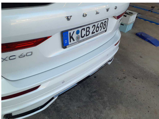
Beschädigung #2: Stossfänger hinten: Stossfänger hinten (Ladekant... - Kratzer - Smart Repair
