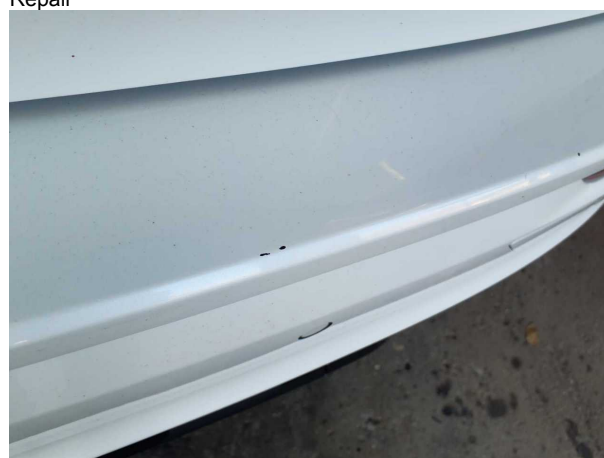
Beschädigung #2: Stossfänger hinten: Stossfänger hinten (Ladekante) - Kratzer - Smart Repair
