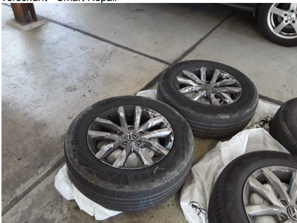
Beschädigung #7: 2.Radsatz: 2 Reifen - verschlissen - erneuern
