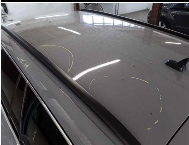
Beschädigung #8: Fahrzeugdach: Dach - Delle(n) - sanft instandsetzen
