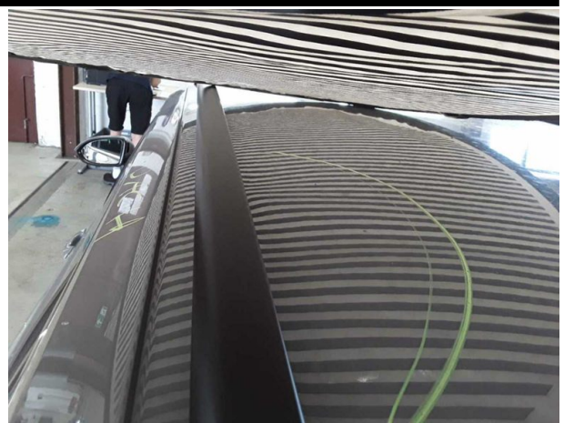
Beschädigung #8: Fahrzeugdach: Dach - Delle(n) - sanft instandsetzen
