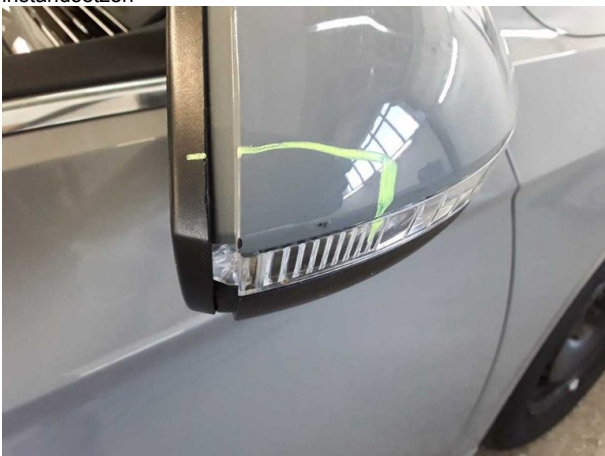
Beschädigung #4: Außenspiegel rechts: Abdeckkappe - verkratzt / verschürft - Smart Repair
