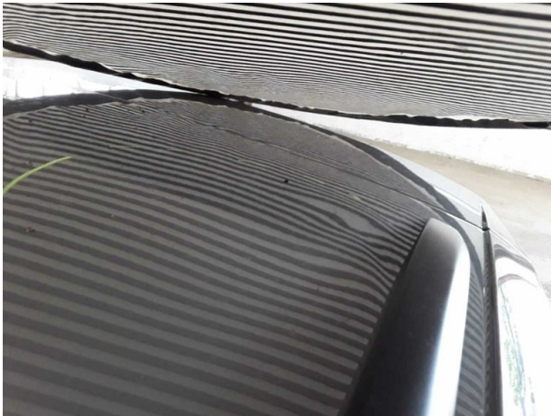
Beschädigung #8: Fahrzeugdach: Dach - Delle(n) - sanft instandsetzen
