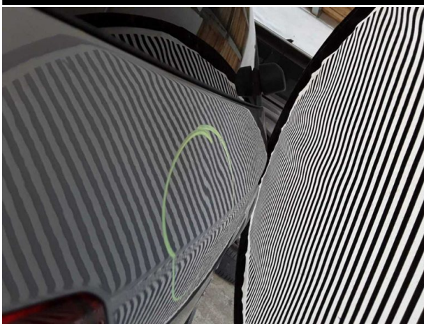
Beschädigung #5: Heckklappe/-tür: Heckklappe - Delle(n) - sanft instandsetzen
