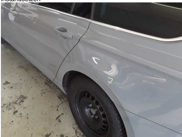
Beschädigung #9: Seitenwand links: Seitenwand - Delle / Lackschaden - instandsetzen und lackieren
