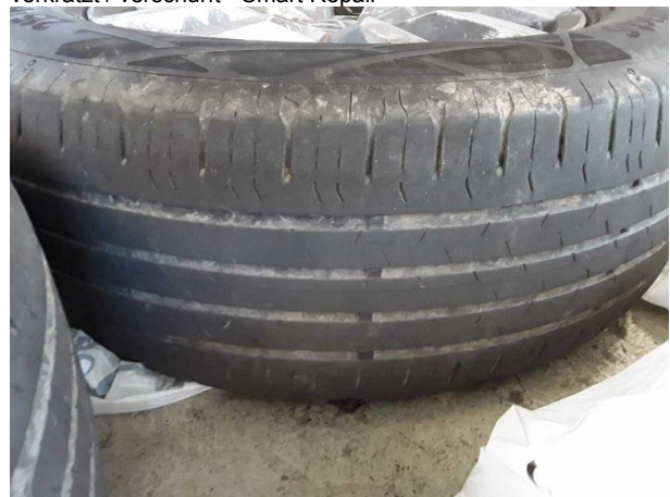
Beschädigung #7: 2.Radsatz: 2 Reifen - verschlissen - erneuern
