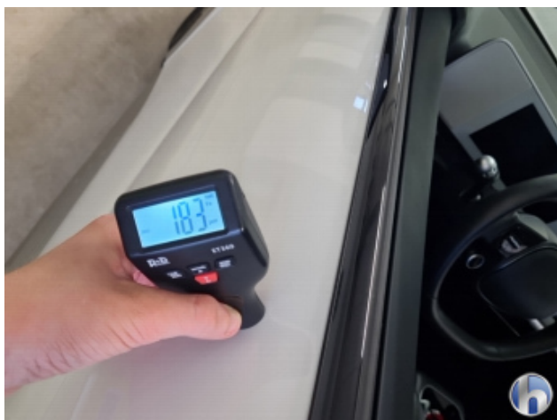
1. Tür Vorne - Links Nachlackiert - Ohne Reparatur
