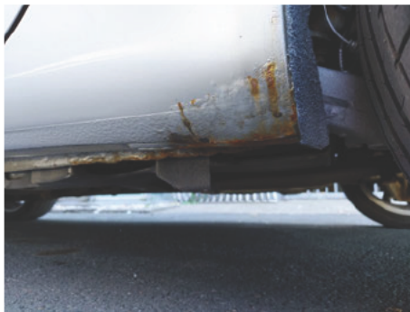
Schweller / Links / Rost
