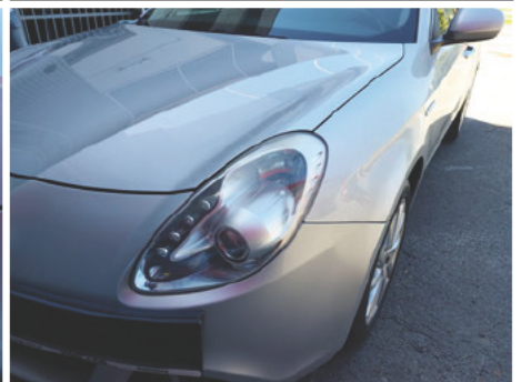
Scheinwerfer / Vorne Links / Verschlissen
