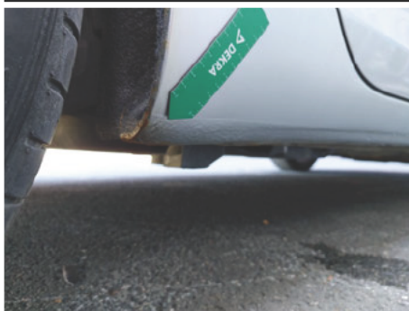
Schweller / Rechts / Rost
