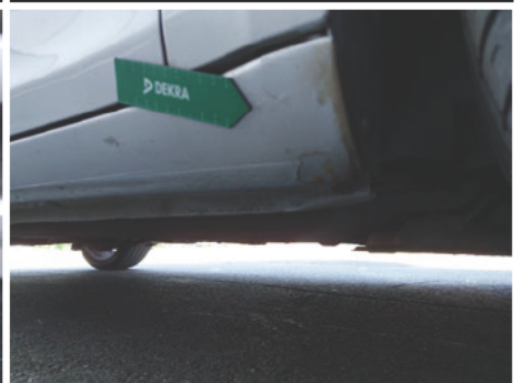
Schweller / Rechts / Rost
