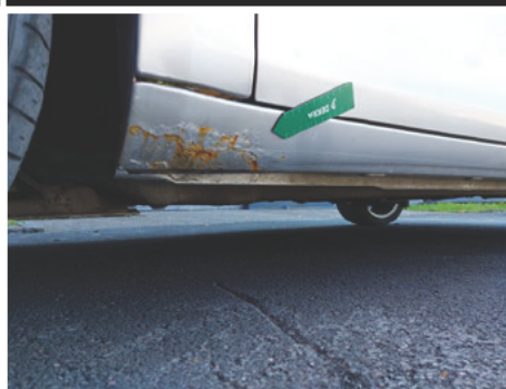
Schweller / Links / Rost
