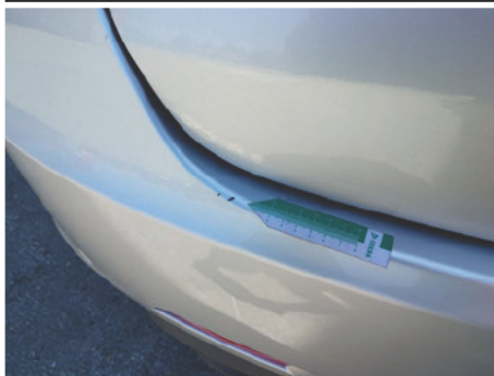
Stoßfänger / Hinten / Abgewetzt
