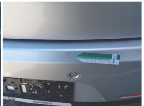
Stoßfänger / Hinten / Abgewetzt
