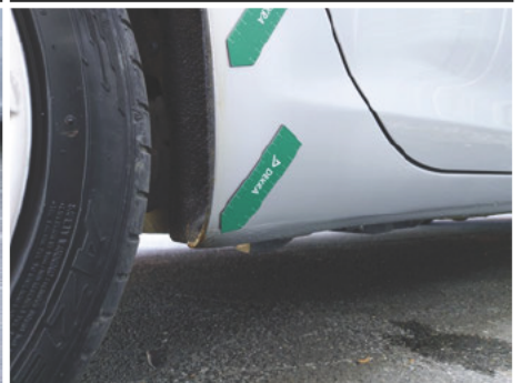
Schweller / Rechts / Rost
