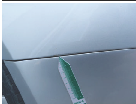
Kotflügel / Vorne Rechts / Kratzer
