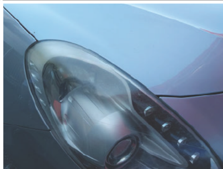
Scheinwerfer / Vorne Rechts / Verschlissen
