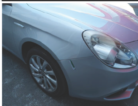
Kotflügel / Vorne Rechts / Kratzer
