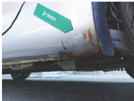
Schweller / Links / Rost
