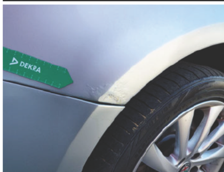
Kotflügel / Vorne Links / Rost
