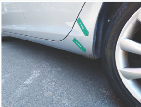
Schweller / Links / Rost
