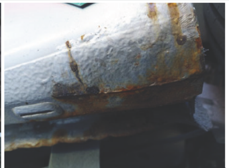
Schweller / Links / Rost
