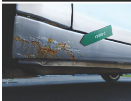
Schweller / Links / Rost
