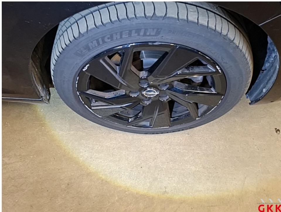
Bild 18 LM-Rad, vorne rechts, Materialabtrag, ersetzen
