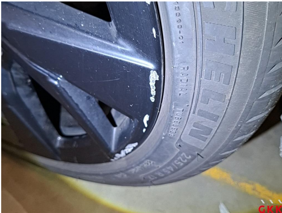
Bild 40 LM-Rad, hinten links, Materialabtrag, ersetzen
