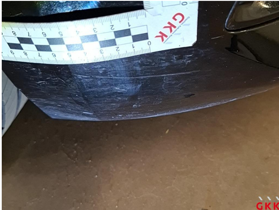
Bild 21 Stoßfänger vorne, Verkleidung -lackiert-, verkratzt, lackieren
