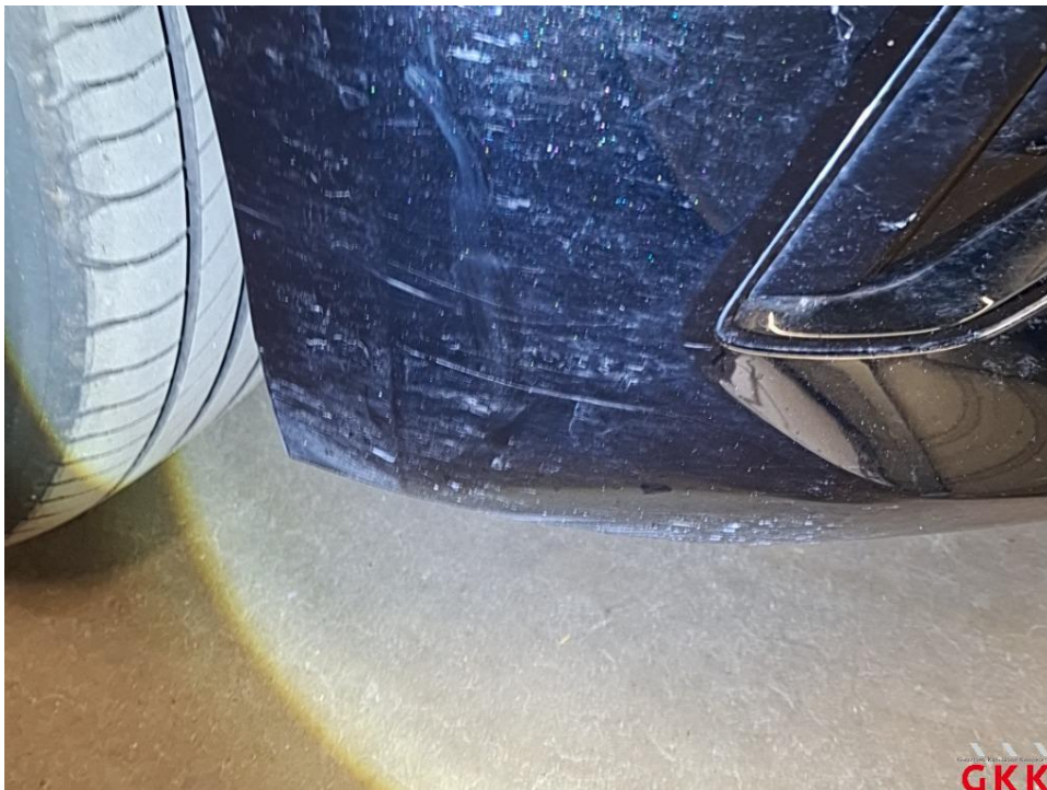
Bild 20 Stoßfänger vorne, Verkleidung -lackiert-, verkratzt, lackieren
