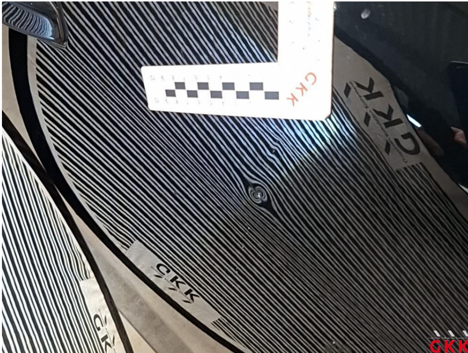
Bild 51 Tür vorne rechts, beschädigt, instand setzen - lackieren
