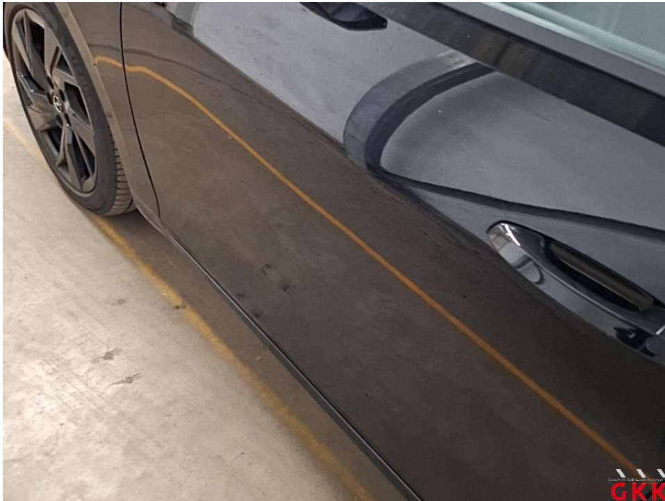
Bild 25 Tür vorne links, beschädigt, kalt drücken
