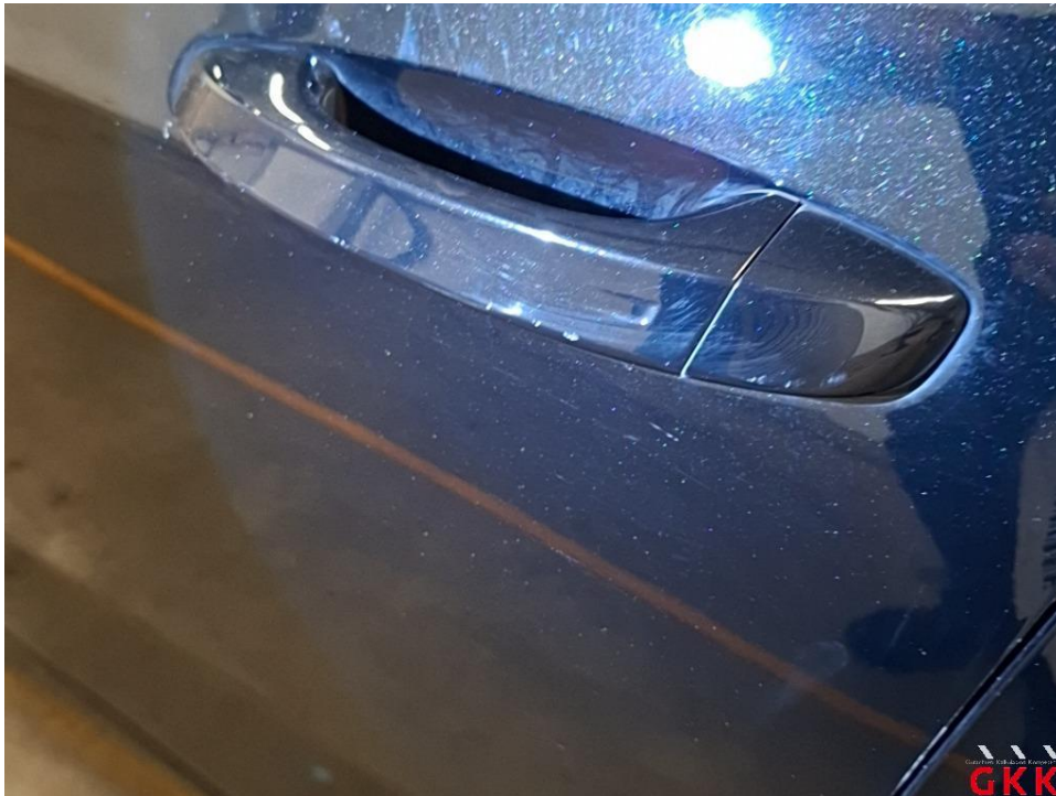
Bild 53 Tür vorne links, Griff, verkratzt, lackieren
