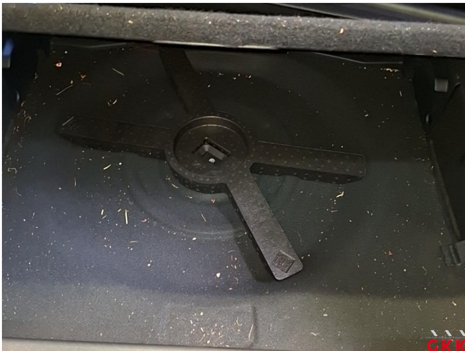
Bild 16 Reifenreparaturset, komplett, fehlt, ersetzen
