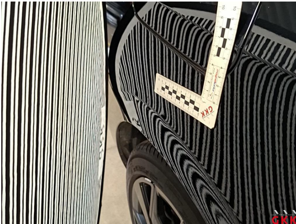
Bild 48 Seitenwand rechts, beschädigt, instand setzen - lackieren
