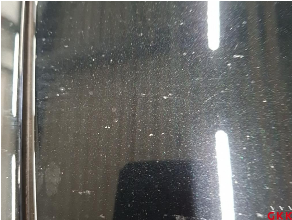
Bild 23 Motorhaube, Steinschlag, lackieren
