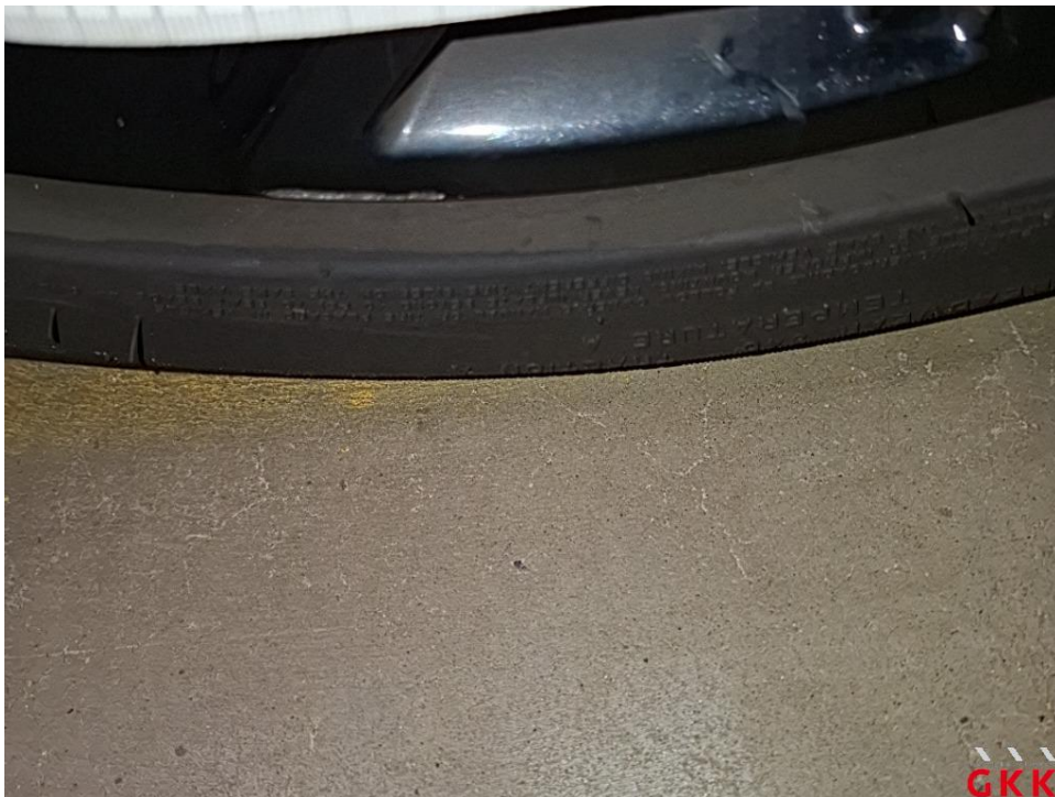
Bild 24 LM-Rad, vorne links, verkratzt, Smartrepair
