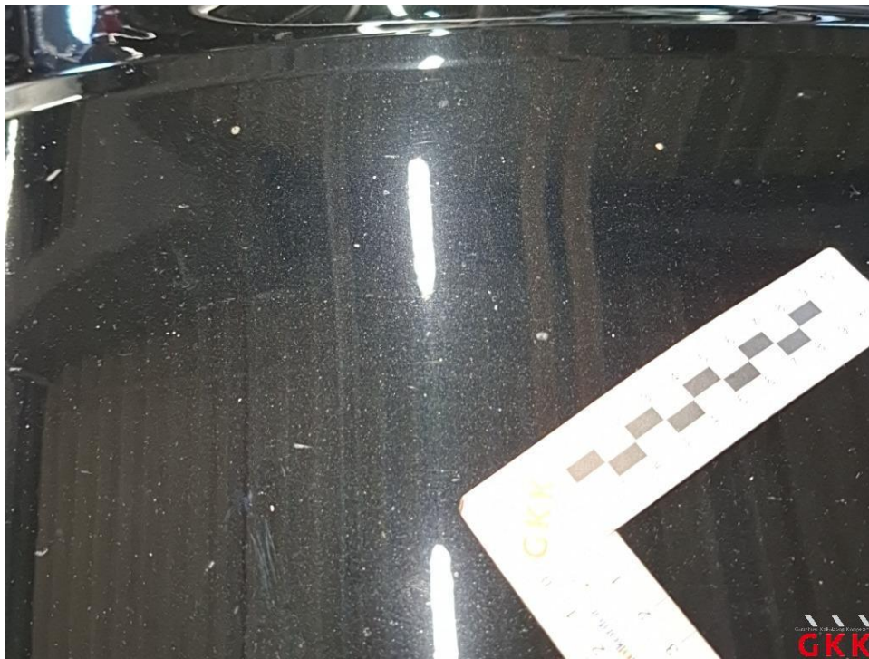
Bild 22 Motorhaube, Steinschlag, lackieren
