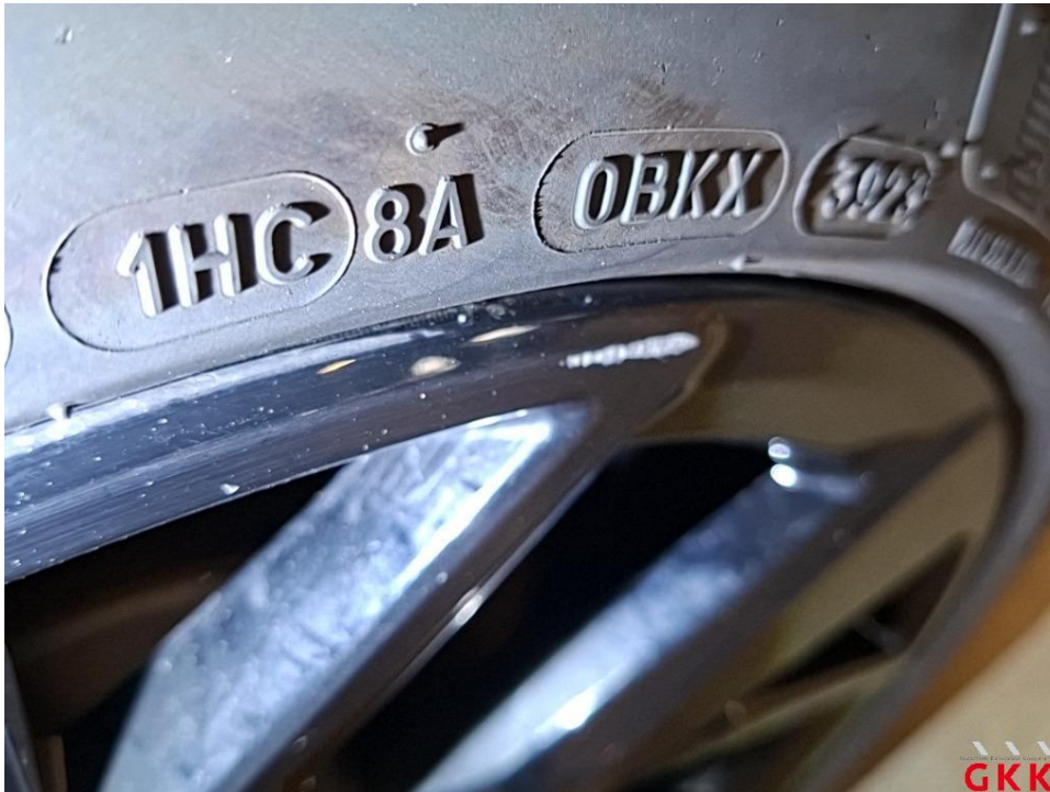
Bild 45 LM-Rad, hinten rechts, Materialabtrag, ersetzen
