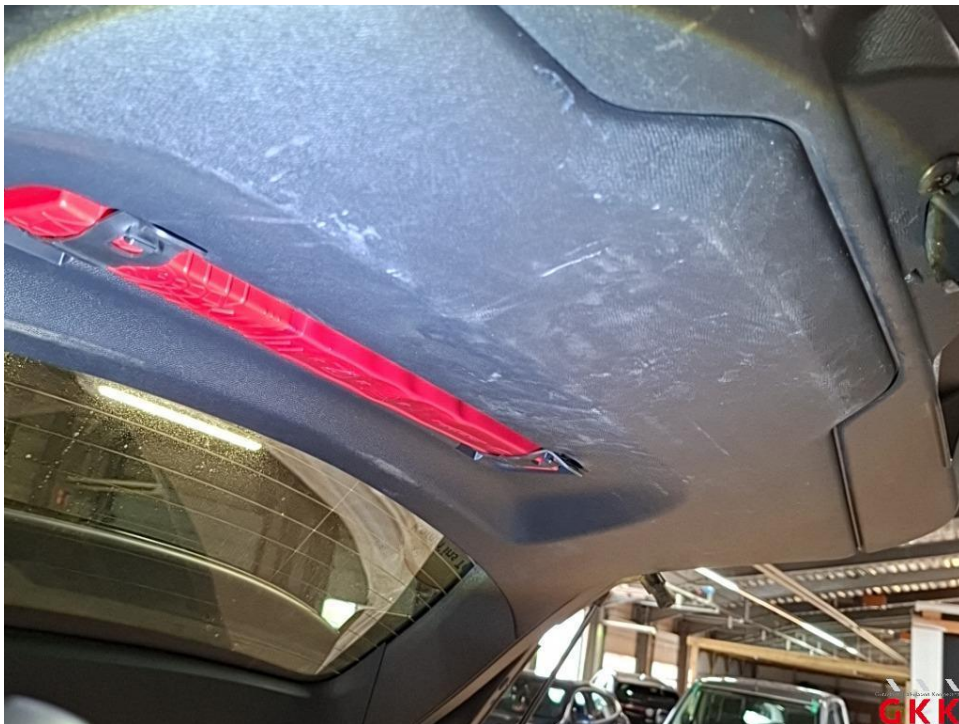
Bild 30 Fahrzeug, innen, verkratzt und verschmutzt, aufbereiten
