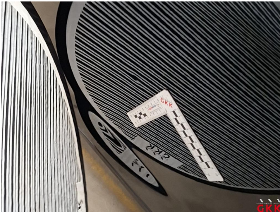
Bild 26 Tür vorne links, beschädigt, kalt drücken
