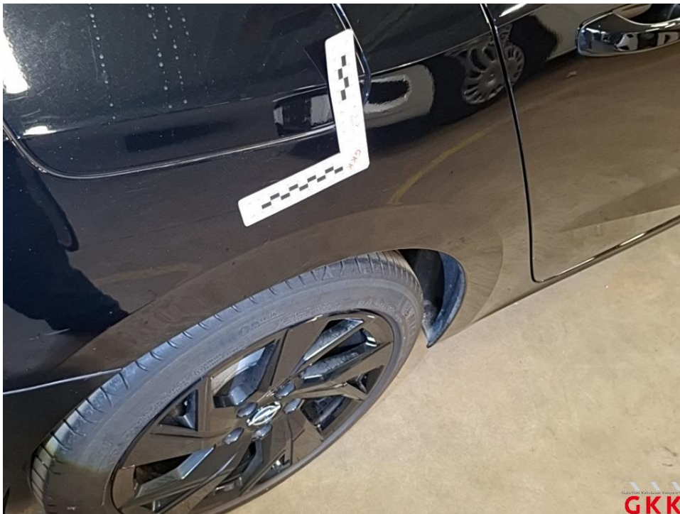
Bild 46 Seitenwand rechts, beschädigt, instand setzen - lackieren
