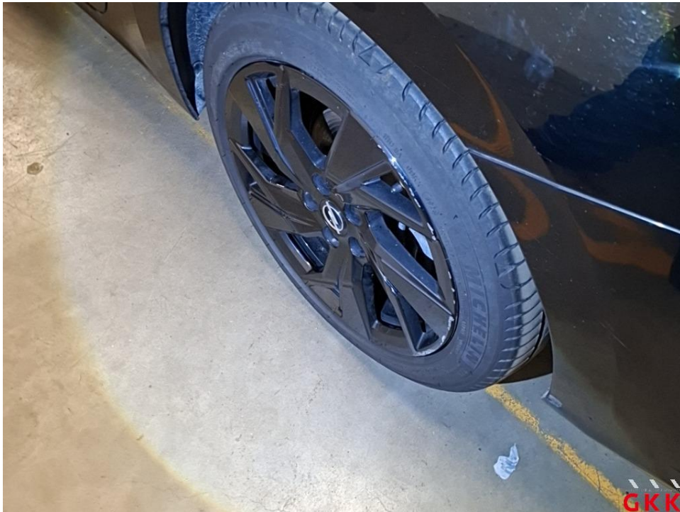
Bild 39 LM-Rad, hinten links, Materialabtrag, ersetzen
