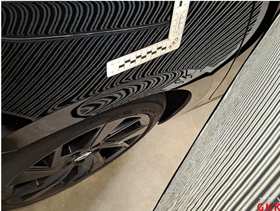
Bild 47 Seitenwand rechts, beschädigt, instand setzen - lackieren
