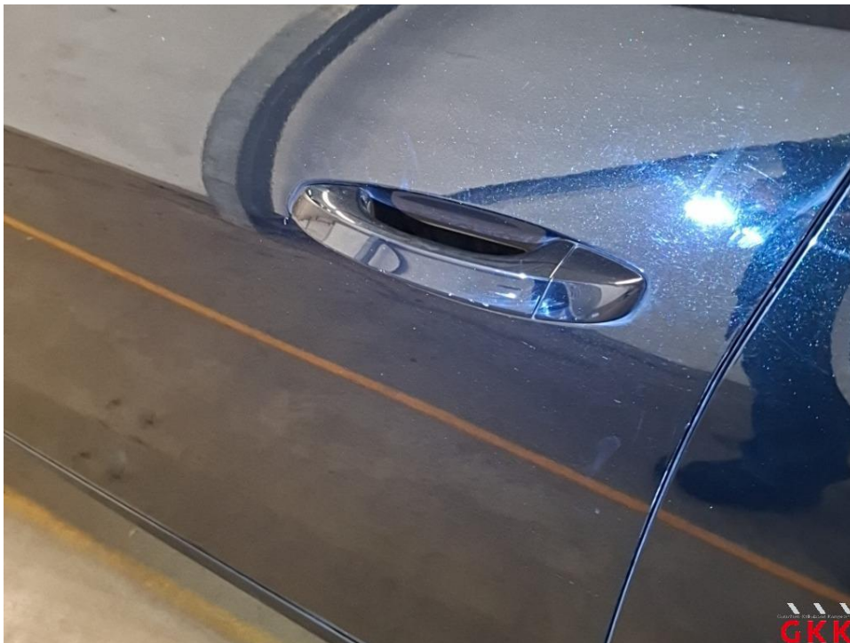
Bild 52 Tür vorne links, Griff, verkratzt, lackieren
