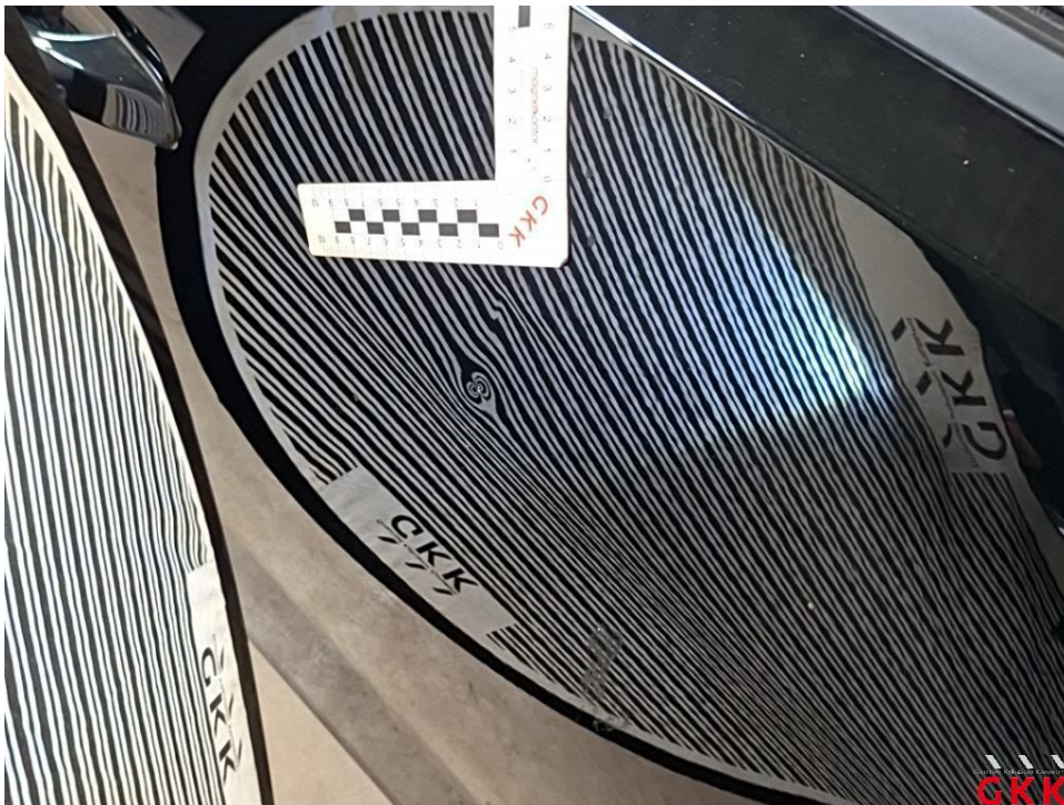
Bild 50 Tür vorne rechts, beschädigt, instand setzen - lackieren
