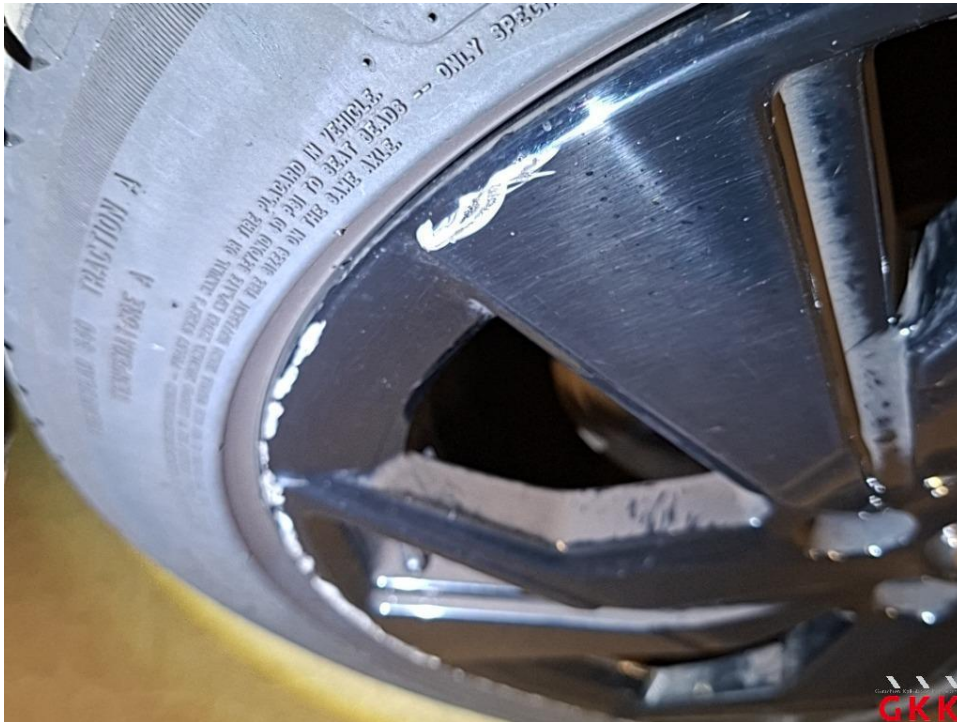
Bild 19 LM-Rad, vorne rechts, Materialabtrag, ersetzen
