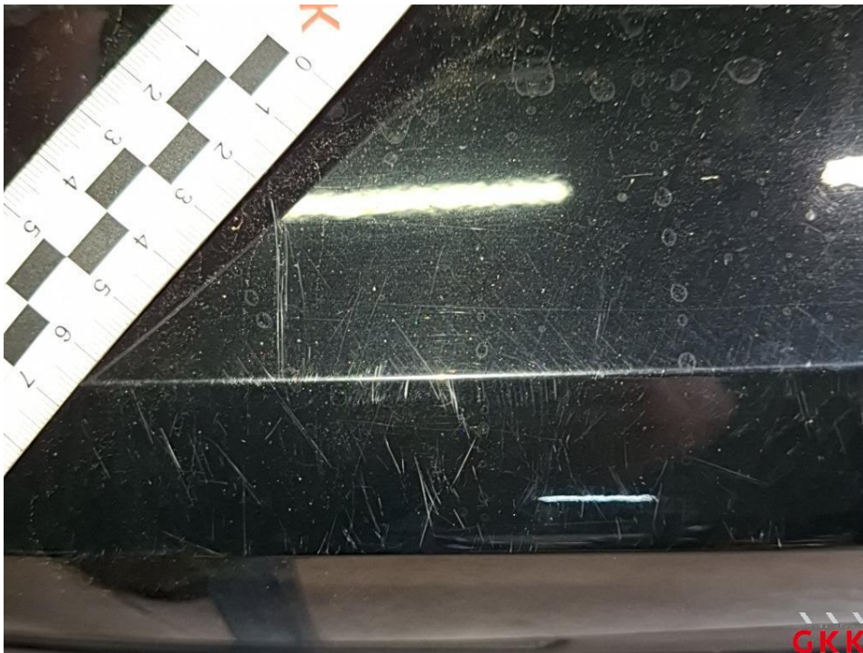
Bild 38 Stoßfänger hinten, Verkleidung -lackiert-, verkratzt, lackieren
