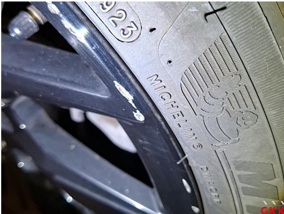
Bild 41 LM-Rad, hinten links, Materialabtrag, ersetzen
