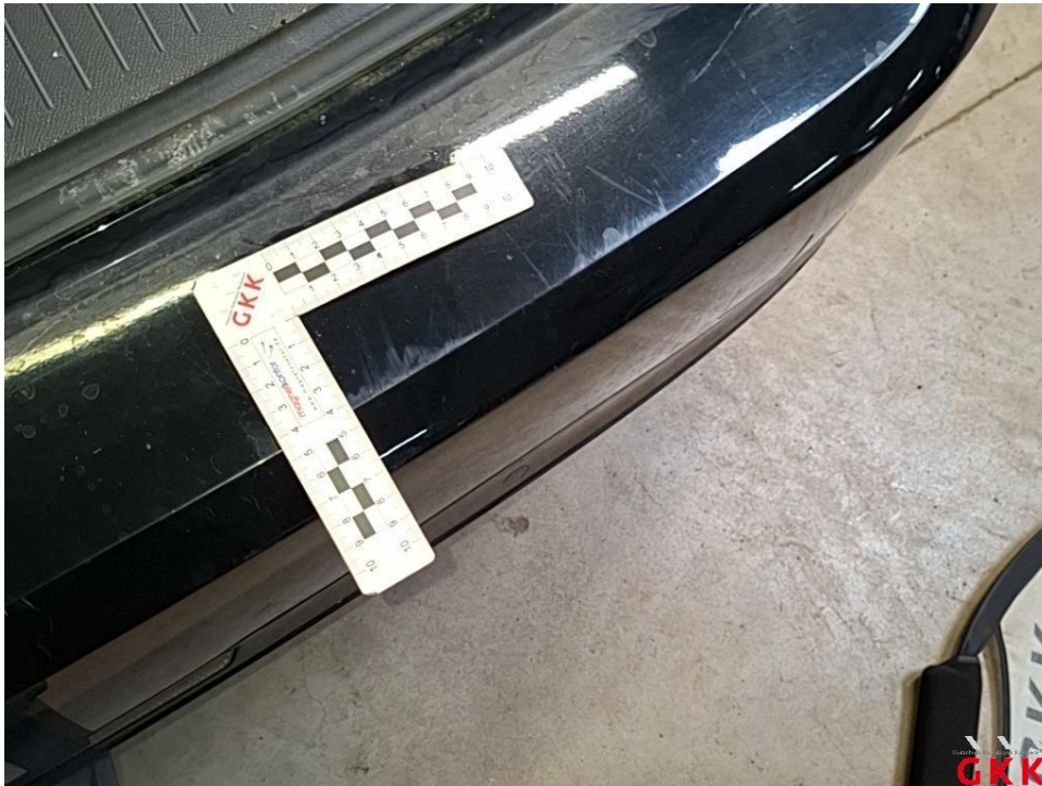
Bild 37 Stoßfänger hinten, Verkleidung -lackiert-, verkratzt, lackieren
