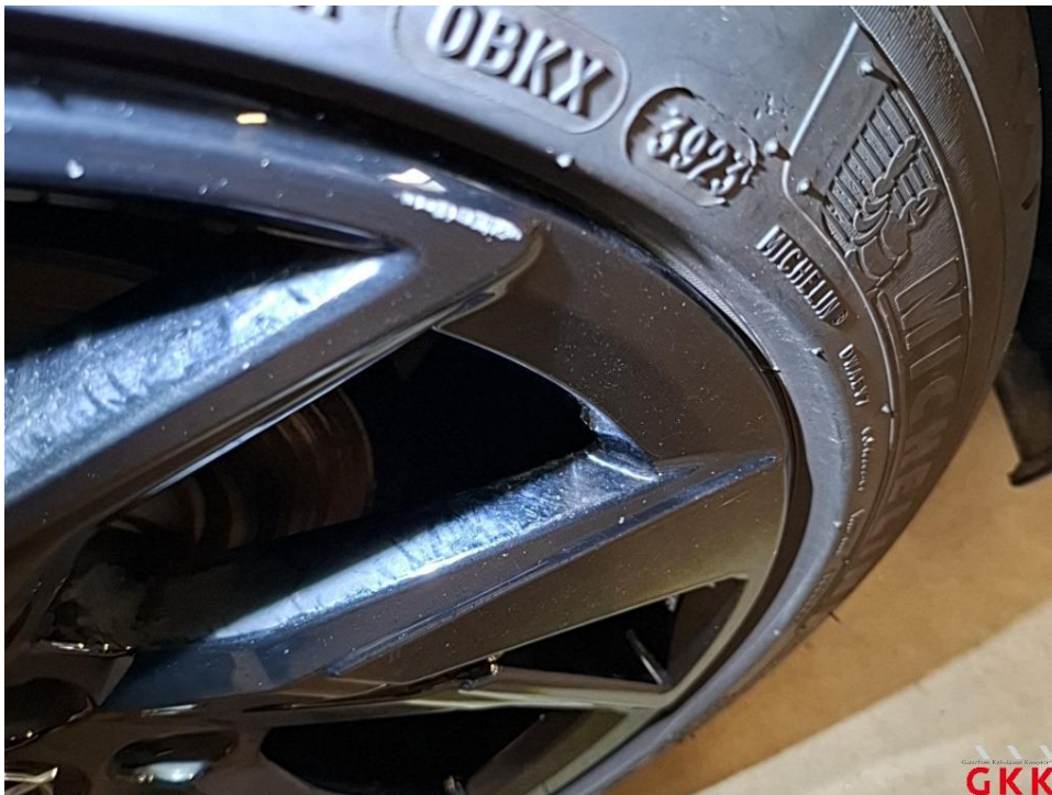
Bild 44 LM-Rad, hinten rechts, Materialabtrag, ersetzen
