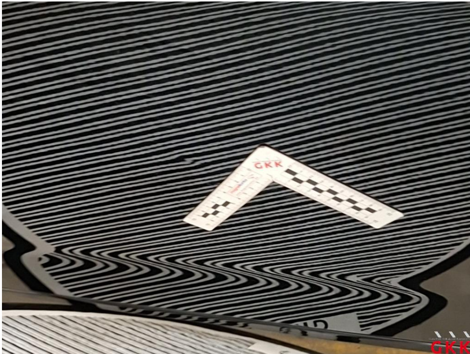
Bild 27 Tür vorne links, beschädigt, kalt drücken
