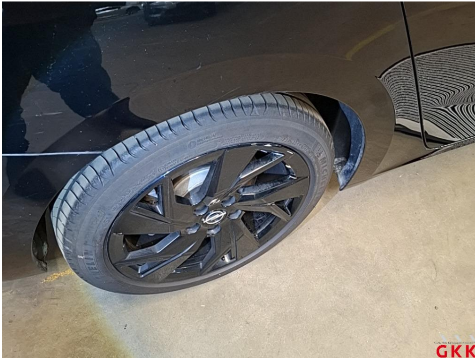
Bild 43 LM-Rad, hinten rechts, Materialabtrag, ersetzen
