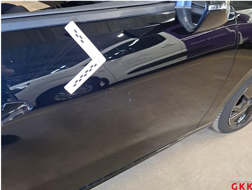
Bild 49 Tür vorne rechts, beschädigt, instand setzen - lackieren
