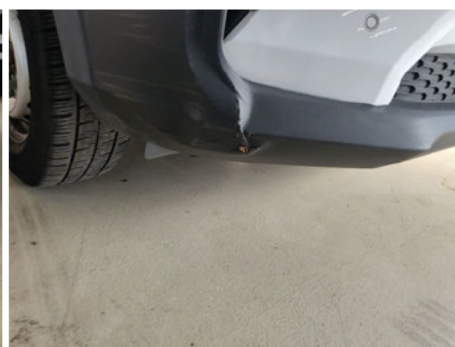
Stoßfänger unterhalb / Vorne / Delle
