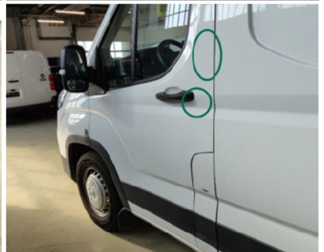
Tür / Vorne Links / Delle
