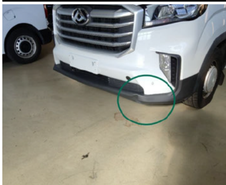
Stoßfänger unterhalb / Vorne / Delle
