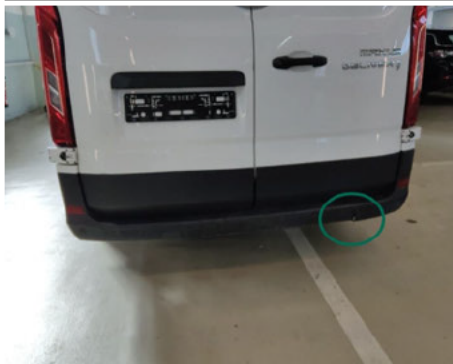
Stoßfänger / Hinten / Gebrochen
