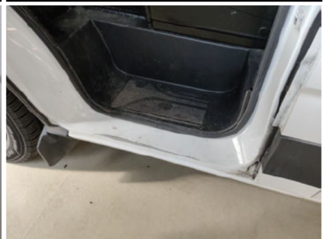
Türeinstieg / Vorne Links / Kratzer
