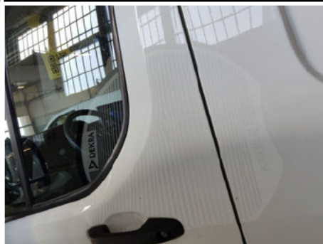
Tür / Vorne Links / Delle
