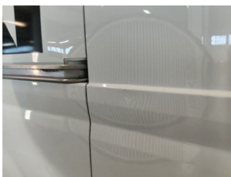
Tür / Rechts / Delle
