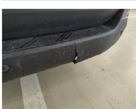
Stoßfänger / Hinten / Gebrochen
