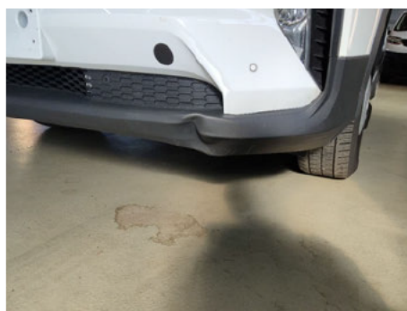
Stoßfänger unterhalb / Vorne / Delle
