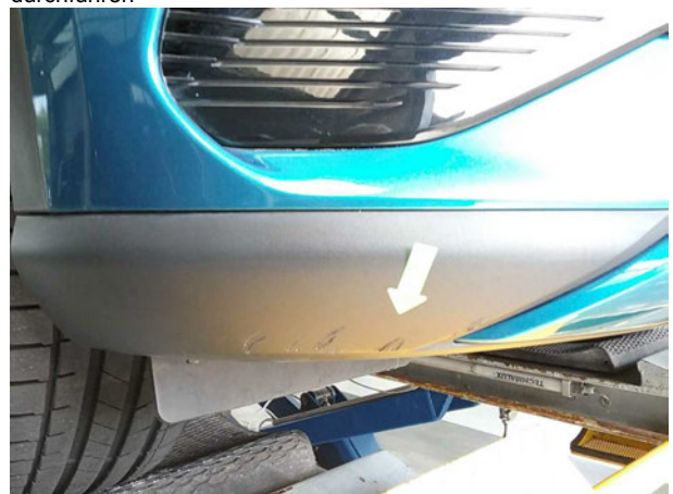
Beschädigung #3: Stossfänger vorn: Spoiler (Materialabtrag) - verkratzt / verschürft - erneuern
