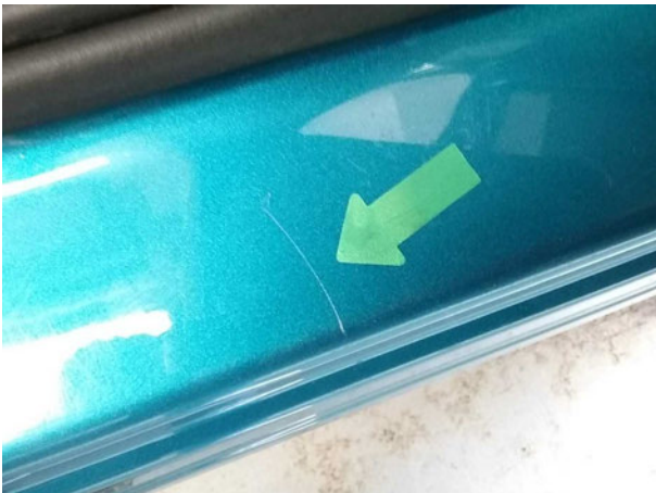
Beschädigung #1: Schweller rechts: Einstieg - Kratzer - Smart Repair
