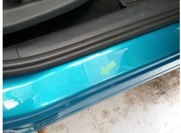
Beschädigung #1: Schweller rechts: Einstieg - Kratzer - Smart Repair
