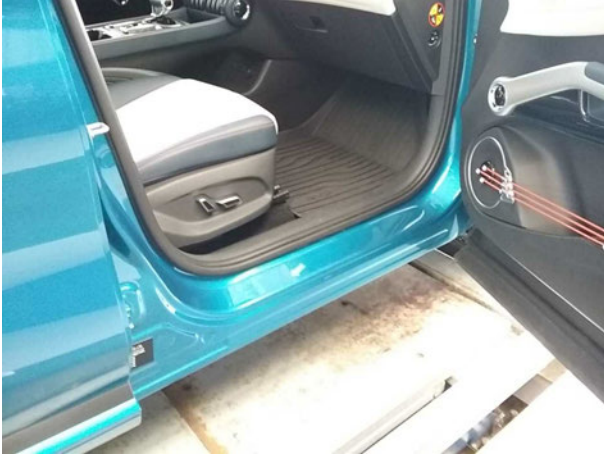
Beschädigung #1: Schweller rechts: Einstieg - Kratzer - Smart Repair
