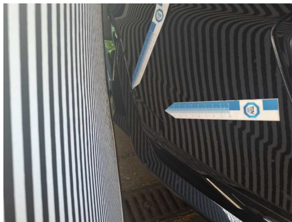
Beschädigung #7: Stossfänger vorn: Stossfänger vorn - verformt - erneuern
