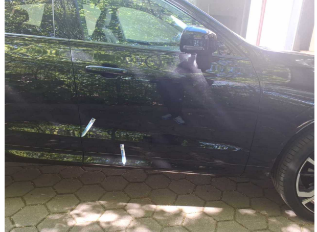
Beschädigung #2: Tür vorn rechts: Zierleiste unten - verkratzt / verschürft - Smart Repair
