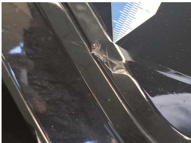
Beschädigung #7: Stossfänger vorn: Stossfänger vorn - verformt - erneuern
