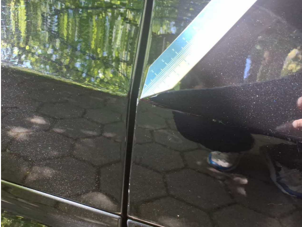
Beschädigung #1: Tür vorn rechts: Türkante - Kratzer - Smart Repair
