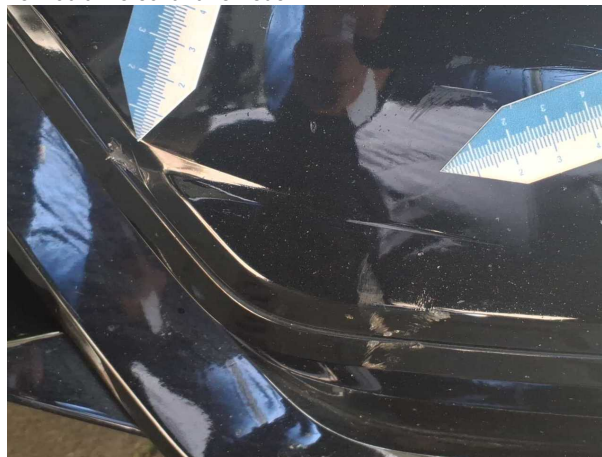
Beschädigung #7: Stossfänger vorn: Stossfänger vorn - verformt - erneuern
