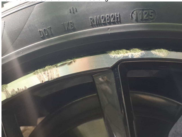
Beschädigung #5: Rad/Reifen: Leichtmetallfelge vorn rechts - verkratzt / verschürft - erneuern
