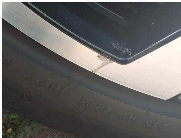
Beschädigung #4: Rad/Reifen: Leichtmetallfelge hinten links - verkratzt / verschürft - Wertminderung
