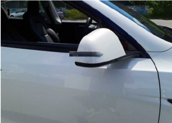
Beschädigung #1: Außenspiegel rechts: Abdeckkappe - Kratzer - Smart Repair
