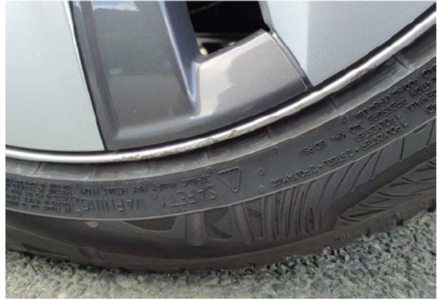
Beschädigung #5: Rad/Reifen: Leichtmetallfelge hinten links (Materialabtrag Verkehrsrelevant) - verkratzt / verschürft - erneuern
