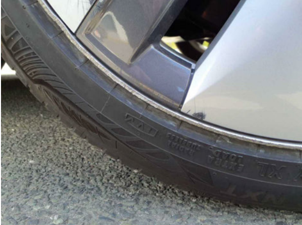
Beschädigung #4: Rad/Reifen: Leichtmetallfelge vorn rechts (Materialabtrag Verkehrsrelevant) - verkratzt / verschürft - erneuern
