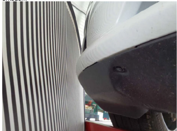
Beschädigung #6: Stossfänger vorn: Stossfänger vorn - verformt - erneuern
