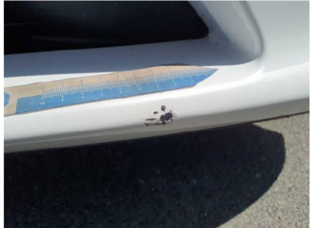
Beschädigung #6: Stossfänger vorn: Stossfänger vorn - verformt - erneuern
