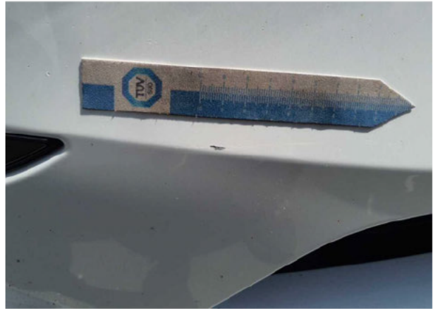
Beschädigung #6: Stossfänger vorn: Stossfänger vorn - verformt - erneuern
