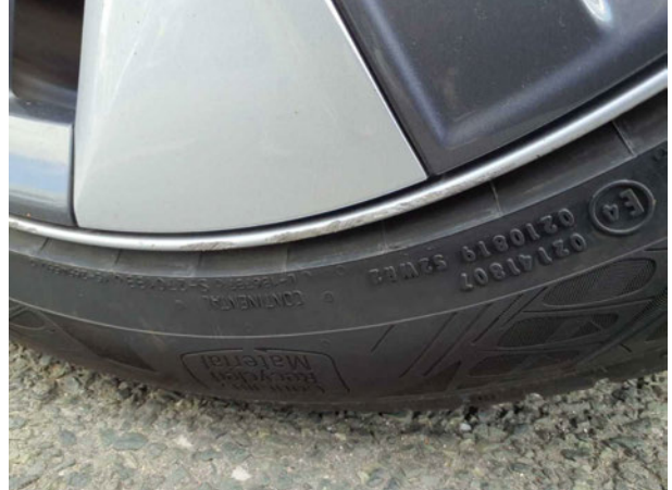
Beschädigung #3: Rad/Reifen: Leichtmetallfelge hinten rechts (Materialabtrag Verkehrsrelevant) - verkratzt / verschürft - erneuern
