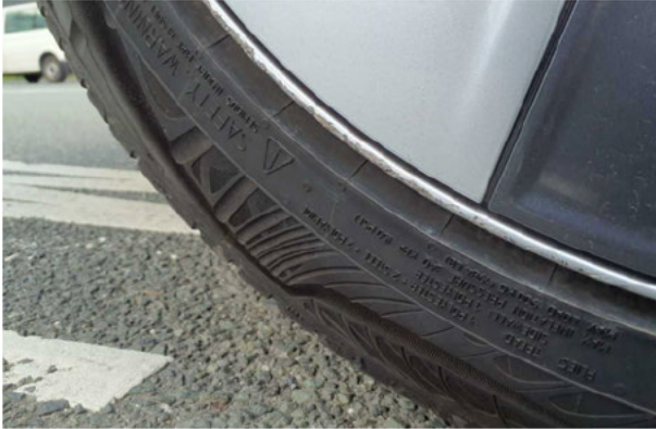
Beschädigung #3: Rad/Reifen: Leichtmetallfelge hinten rechts (Materialabtrag Verkehrsrelevant) - verkratzt / verschürft - erneuern
