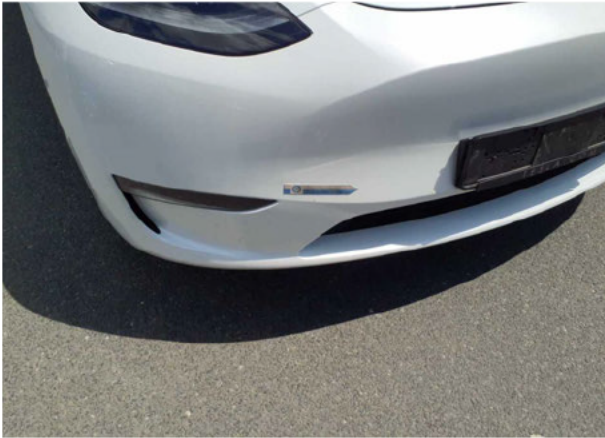
Beschädigung #6: Stossfänger vorn: Stossfänger vorn - verformt - erneuern
