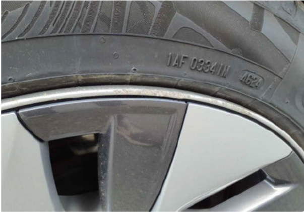
Beschädigung #5: Rad/Reifen: Leichtmetallfelge hinten links (Materialabtrag Verkehrsrelevant) - verkratzt / verschürft - erneuern
