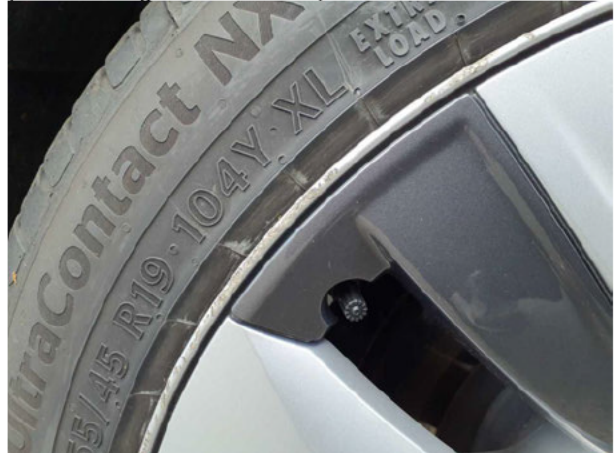
Beschädigung #5: Rad/Reifen: Leichtmetallfelge hinten links (Materialabtrag Verkehrsrelevant) - verkratzt / verschürft - erneuern
