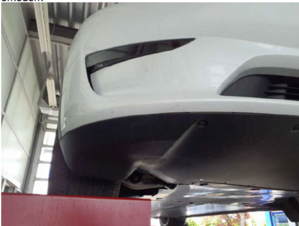
Beschädigung #6: Stossfänger vorn: Stossfänger vorn - verformt - erneuern
