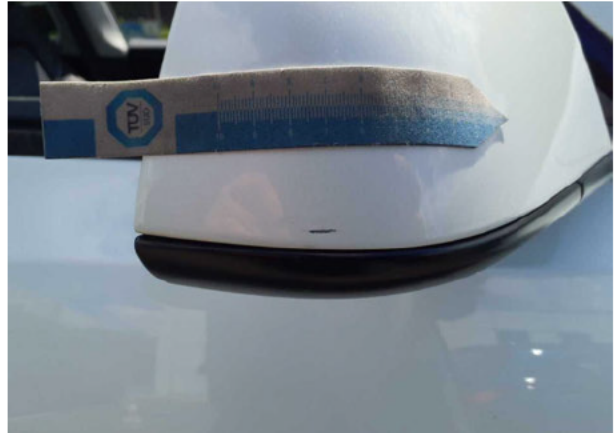
Beschädigung #1: Außenspiegel rechts: Abdeckkappe - Kratzer - Smart Repair
