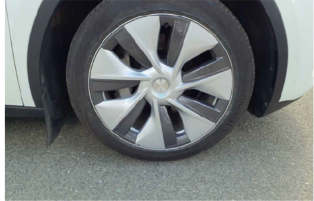
Beschädigung #4: Rad/Reifen: Leichtmetallfelge vorn rechts (Materialabtrag Verkehrsrelevant) - verkratzt / verschürft - erneuern
