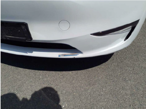
Beschädigung #6: Stossfänger vorn: Stossfänger vorn - verformt - erneuern
