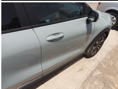
Puerta / Delantero Derecho / Abolladura
