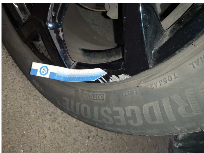
Damage 4: Wheel / tyres: Alloy rim - front right side (Mit Materialabtrag) - Scratched - Replace
