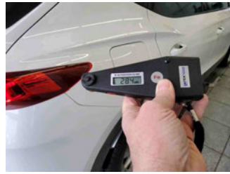
Lackstärke Seitenwand hinten rechts
