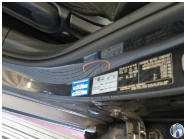
5. Türeinstieg Vorne - Links 1 Delle - Sanft Instandsetzen
