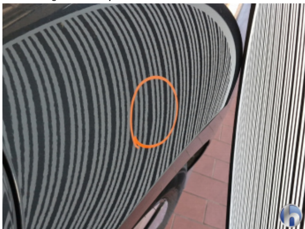
4. Seitenwand - Hinten - Links Delle Bis 20 Mm Ohne Lackschaden - Sanft Instandsetzen
