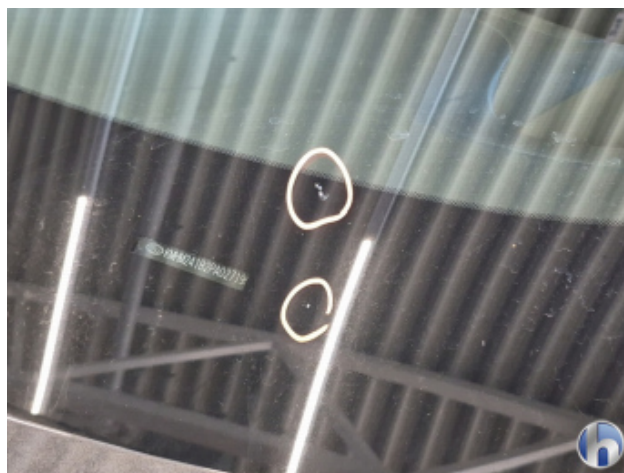
3. Windschutzscheibe Steinschlag - Smart Repair
