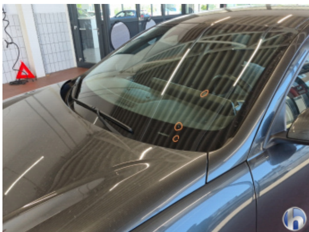
3. Windschutzscheibe Steinschlag - Smart Repair
