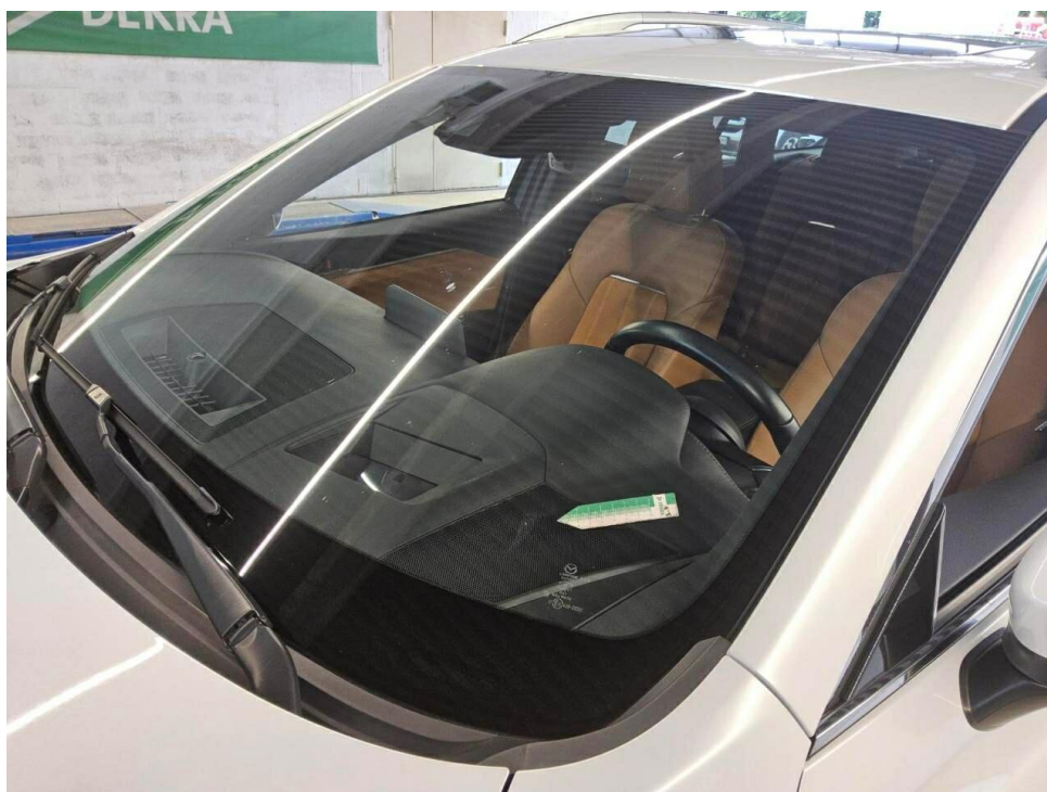
Bild 18 : Frontscheibe, Steinschlag, Gebrauchsspur
