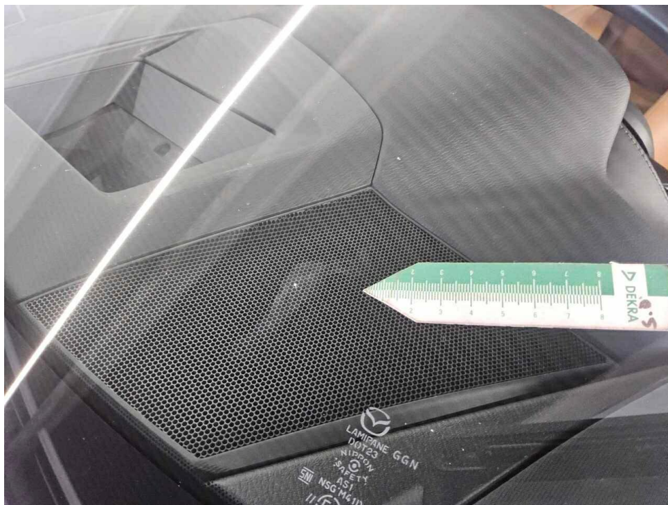
Bild 19 : Frontscheibe, Steinschlag, Gebrauchsspur
