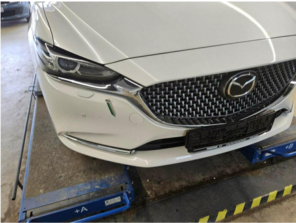
Bild 14 : Stoßfänger vorne Lackierung, Steinschlag, Gebrauchsspur
