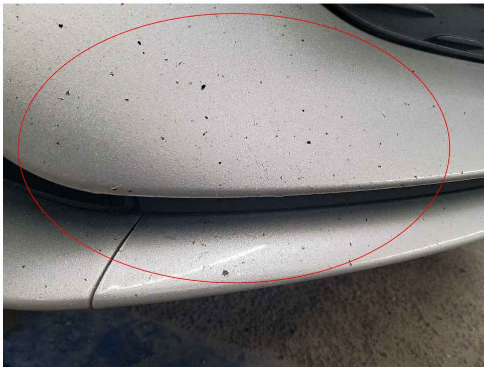
Bild 22 : Stoßfänger vorne Lackierung, viele Steinschläge, lackieren mit Lackaufbau
