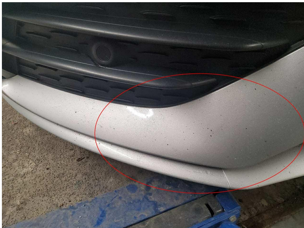
Bild 18 : Stoßfänger vorne Lackierung, viele Steinschläge, lackieren mit Lackaufbau
