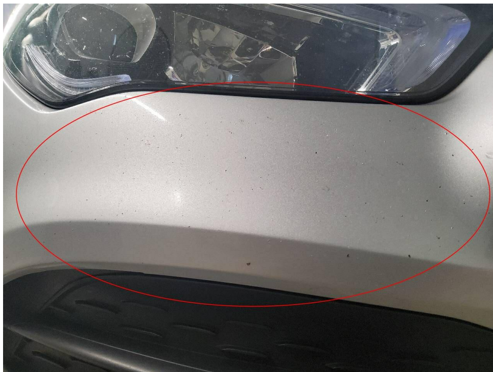
Bild 19 : Stoßfänger vorne Lackierung, viele Steinschläge, lackieren mit Lackaufbau
