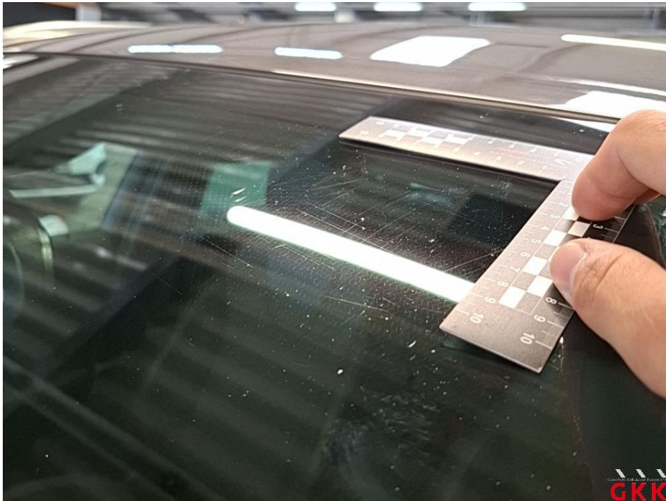
Bild 21 Frontscheibe, verkratzt, ersetzen
