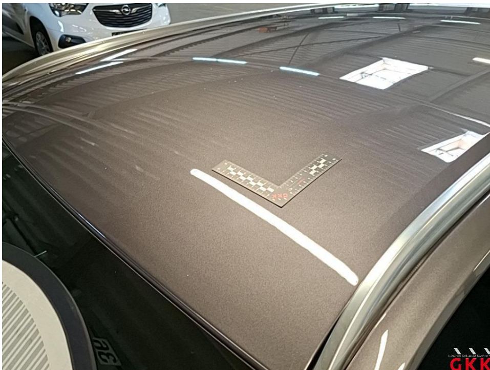
Bild 16 Dach, beschädigt, instand setzen - lackieren
