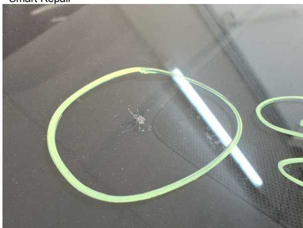
Beschädigung #4: Verglasung: Frontscheibe - Steinschlag - erneuern
