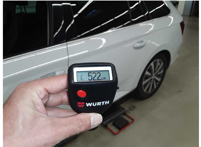
Door - rear left side: 522 µm
