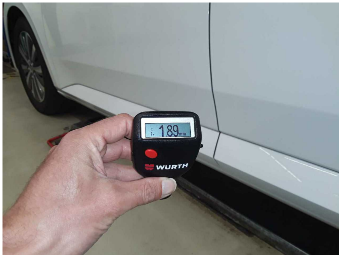
Door - front left side: 1,890 µm
