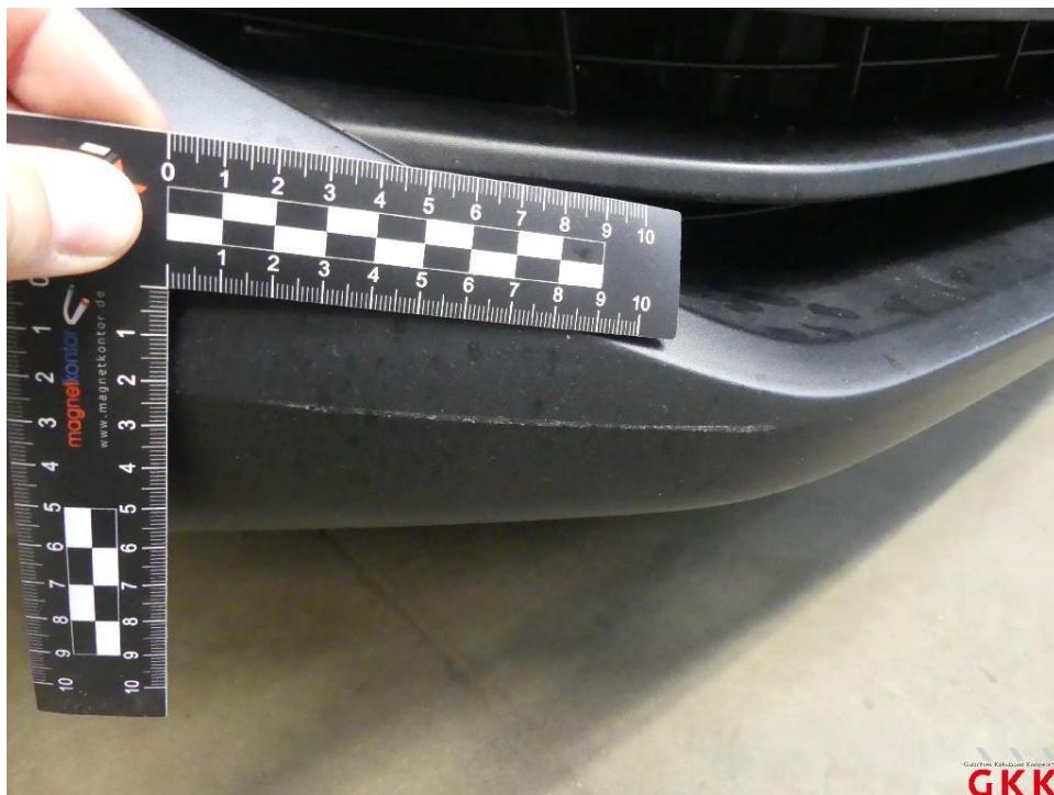
Bild 14 Stoßfänger vorne, Verkleidung -unlackiert-, verkratzt, ersetzen
