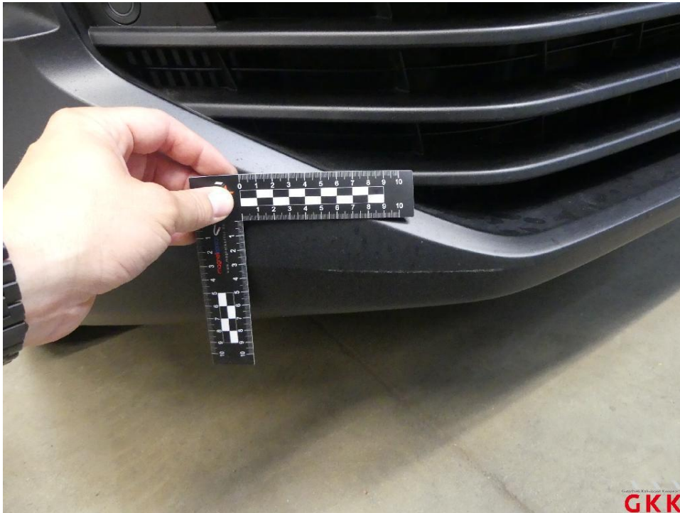
Bild 13 Stoßfänger vorne, Verkleidung -unlackiert-, verkratzt, ersetzen
