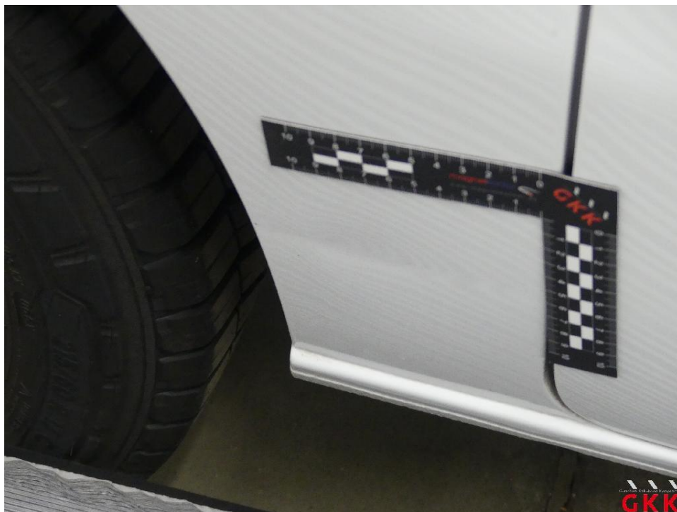
Bild 20 Seitenwand rechts, beschädigt, instand setzen - lackieren
