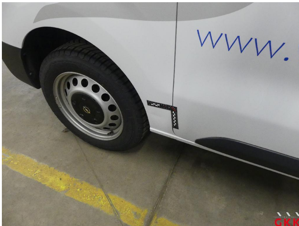
Bild 19 Seitenwand rechts, beschädigt, instand setzen - lackieren
