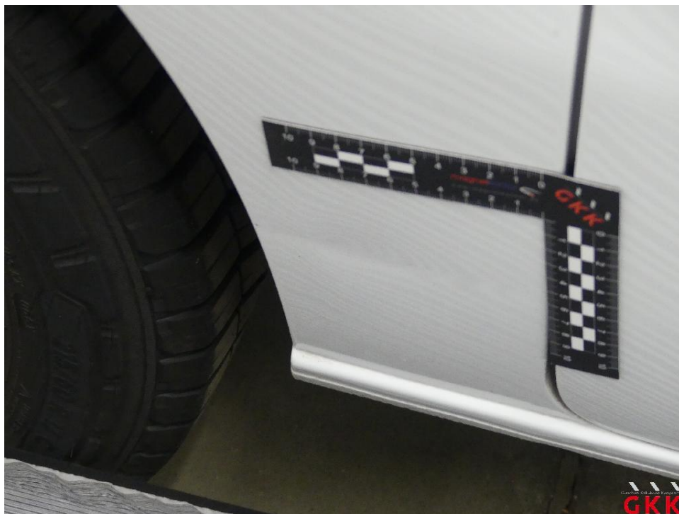
Bild 20 Seitenwand rechts, beschädigt, instand setzen - lackieren
