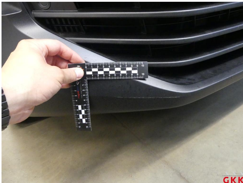
Bild 13 Stoßfänger vorne, Verkleidung -unlackiert-, verkratzt, ersetzen
