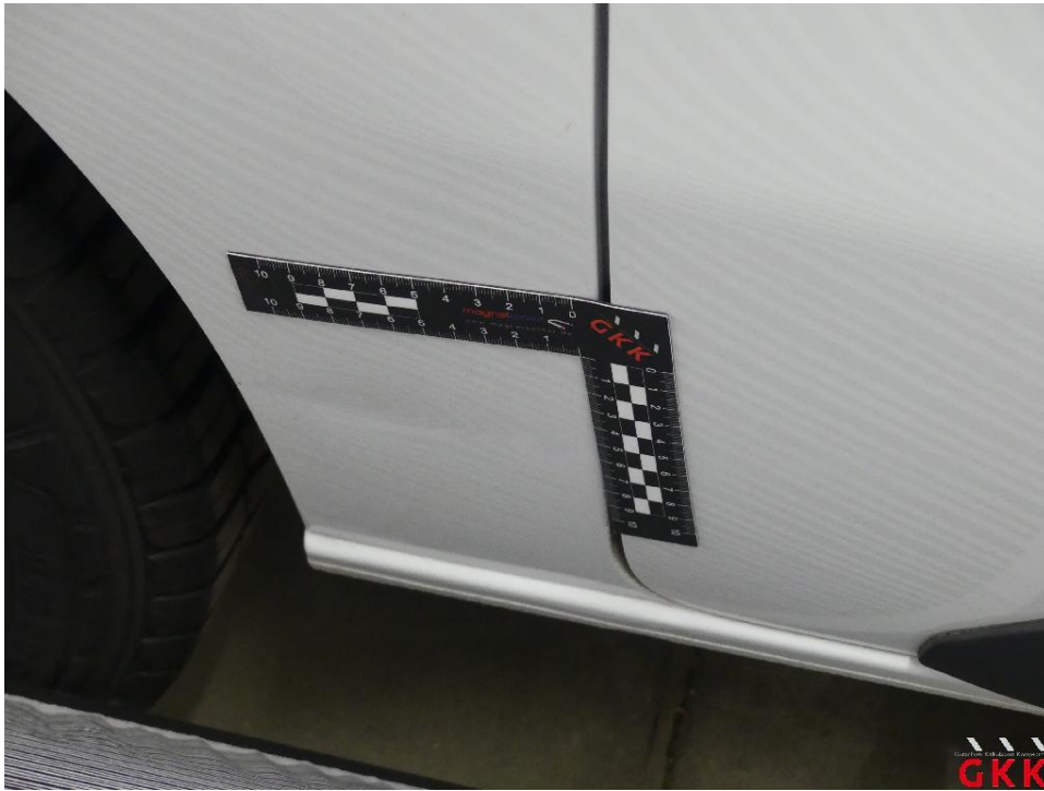
Bild 21 Seitenwand rechts, beschädigt, instand setzen - lackieren
