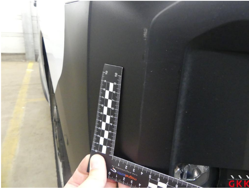
Bild 15 Stoßfänger vorne, Verkleidung -unlackiert-, verkratzt, ersetzen
