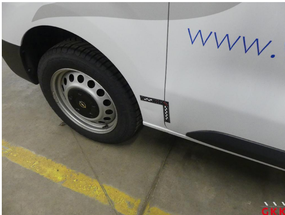
Bild 19 Seitenwand rechts, beschädigt, instand setzen - lackieren
