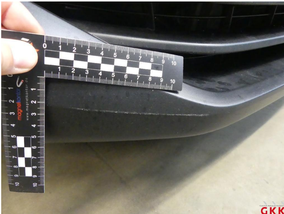
Bild 14 Stoßfänger vorne, Verkleidung -unlackiert-, verkratzt, ersetzen
