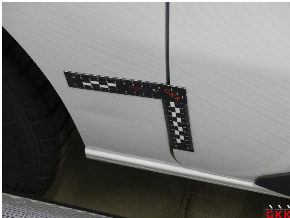
Bild 21 Seitenwand rechts, beschädigt, instand setzen - lackieren
