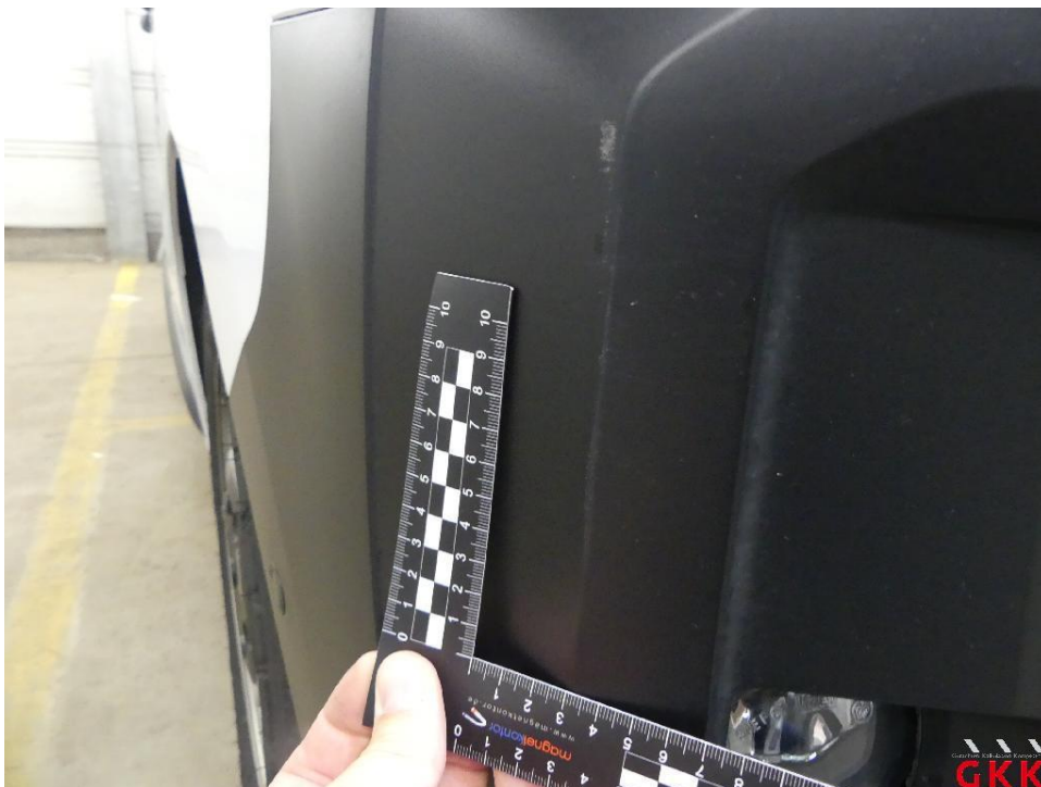
Bild 15 Stoßfänger vorne, Verkleidung -unlackiert-, verkratzt, ersetzen
