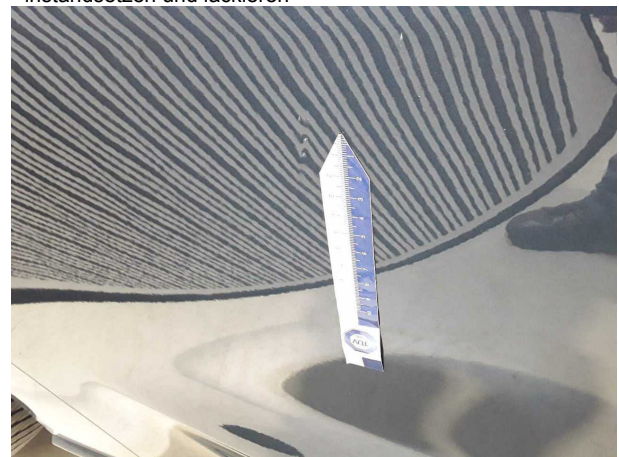
Beschädigung #7: Tür hinten rechts: Tür - Delle / Lackschad... - instandsetzen und lackieren
