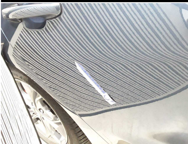
Beschädigung #7: Tür hinten rechts: Tür - Delle / Lackschaden - instandsetzen und lackieren
