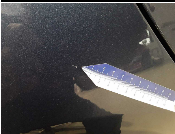
Beschädigung #6: Seitenwand rechts: Seitenwand - Kratzer - lackieren
