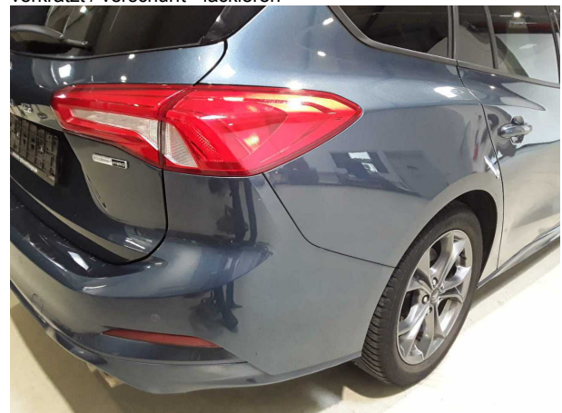
Beschädigung #6: Seitenwand rechts: Seitenwand - Kratzer - lackieren
