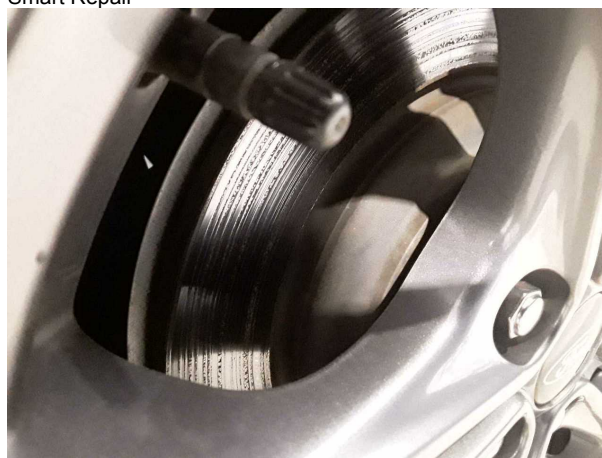
Beschädigung #4: Bremsanlage: Bremsscheiben hinten (Tragbild mangelhaft) - verschlissen - erneuern
