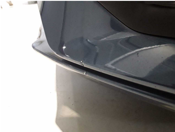
Beschädigung #8: Stossfänger vorn: Stossfänger vorn - verformt - instandsetzen und lackieren
