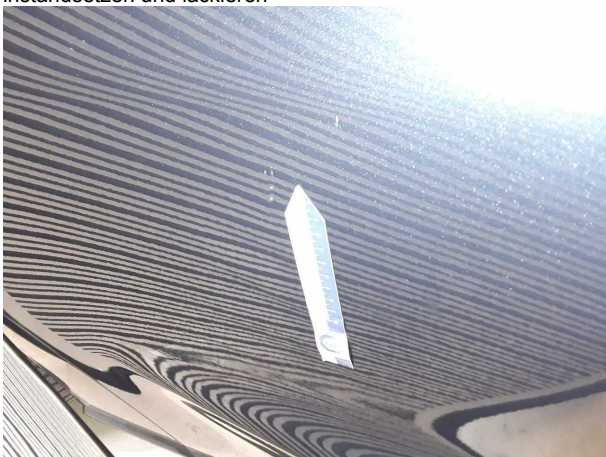
Beschädigung #7: Tür hinten rechts: Tür - Delle / Lackschaden - instandsetzen und lackieren
