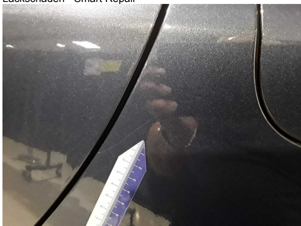
Beschädigung #3: Seitenwand links: Seitenwand - Kratzer - Smart Repair
