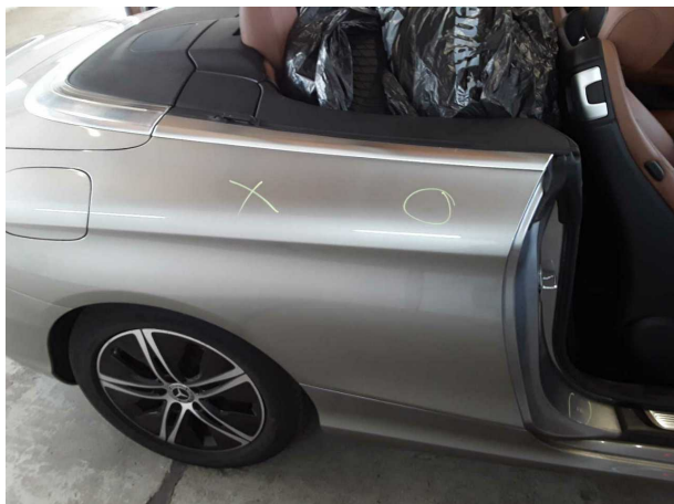
Beschädigung #1: Seitenwand rechts: Seitenwand - Delle(n) - sanft instandsetzen
