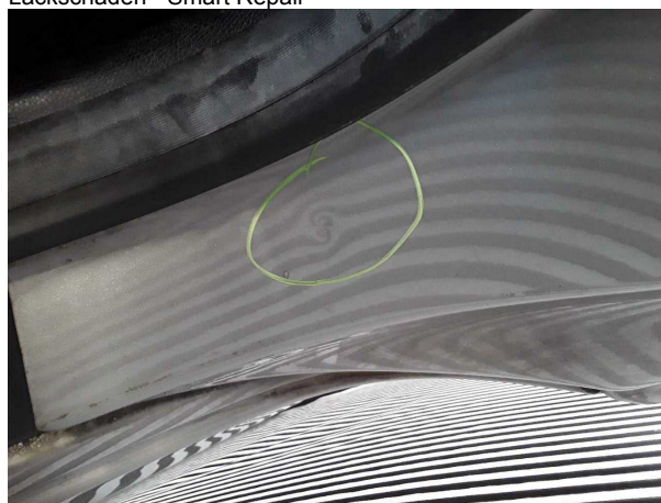
Beschädigung #3: Seitenwand links: Einstieg - Delle(n) - Smart Repair
