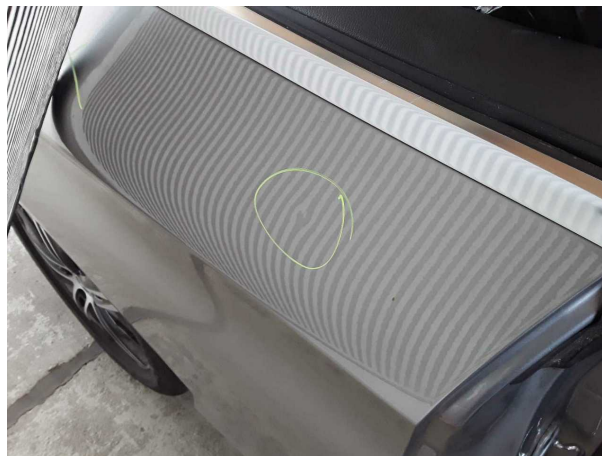
Beschädigung #1: Seitenwand rechts: Seitenwand - Delle(n) - sanft instandsetzen
