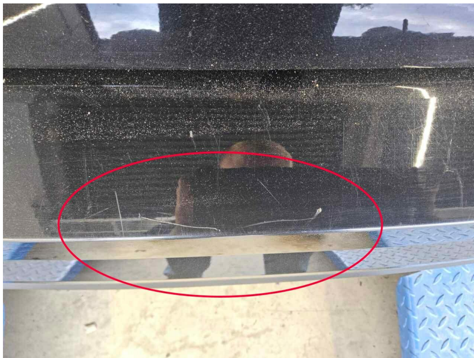
Bild 14 : Stoßfänger hinten Lackierung, zerkratzt, smart repair
