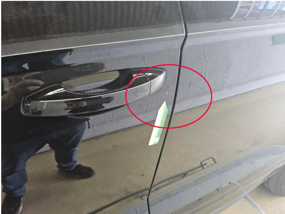
Bild 28 : Tür vorne links, mehrfach eingedellt, drücken
