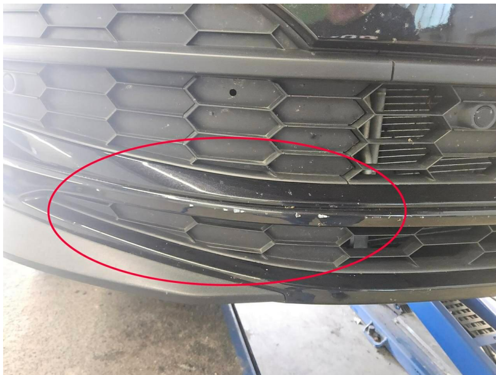
Bild 26 : Stoßfänger vorne Lackierung, verschrammt, smart repair
