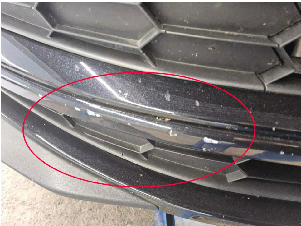
Bild 25 : Stoßfänger vorne Lackierung, verschrammt, smart repair
