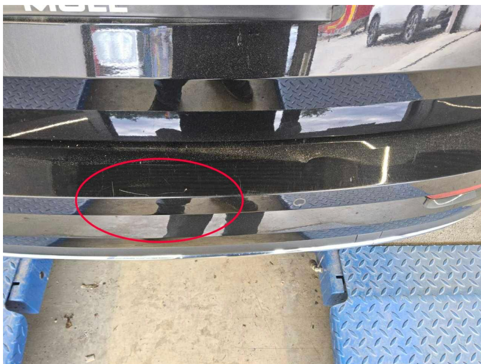
Bild 15 : Stoßfänger hinten Lackierung, zerkratzt, smart repair
