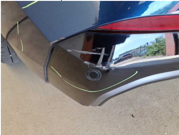
Beschädigung #8: Stossfänger hinten: Spoiler - verkratzt / verschürft - erneuern
