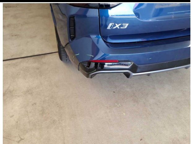
Beschädigung #8: Stossfänger hinten: Spoiler - verkratzt / verschürft - erneuern
