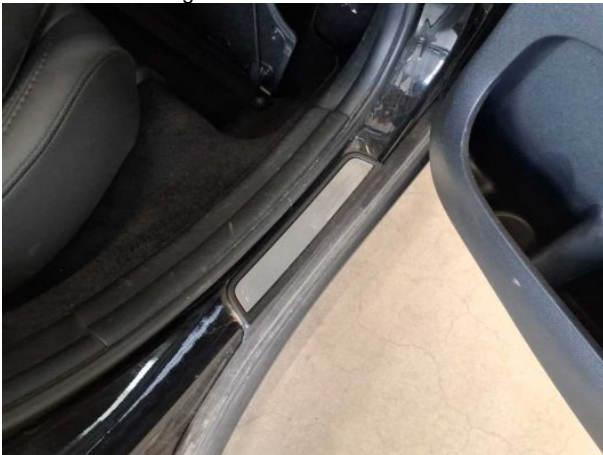
Beschädigung #2: Verkleidungen/Abdeckungen: Verkleidungen/Abdeckungen (Einstiegsleiste hinten rechts) - Delle(n) - erneuern
