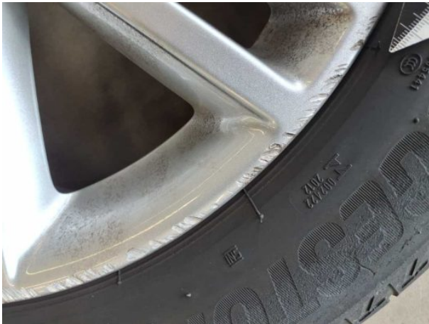
Beschädigung #6: 2.Radsatz: 1 Leichtmetallfelge - verkratzt / verschürft - Wertminderung
