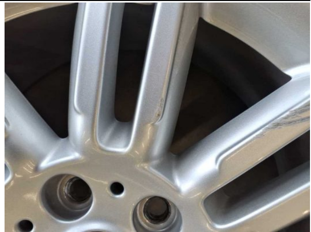
Beschädigung #7: 2.Radsatz: 1 Leichtmetallfelge - Kratzer - Wertminderung
