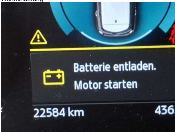
Beschädigung #8: elektrisches System: Batterie - Funktion / Zulässigkeit - Diagnose durchführen
