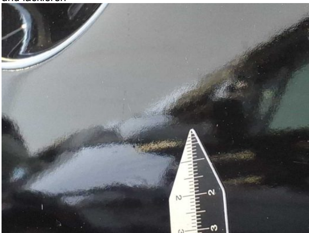
Beschädigung #15: Tür vorn links: Tür - Kratzer - instandsetzen und lackieren
