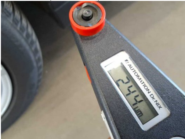
Nachlackierung 1: Kotflügel links, Kotflügel rechts, Motorhaube, Seitenwand links, Tür hinten links, Tür vorne links
