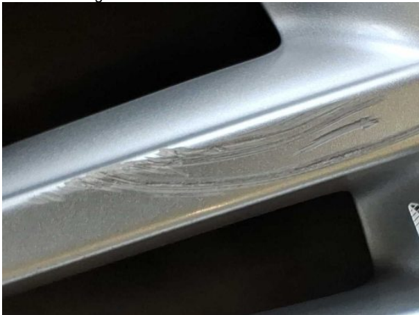
Beschädigung #7: 2.Radsatz: 1 Leichtmetallfelge - Kratzer - Wertminderung
