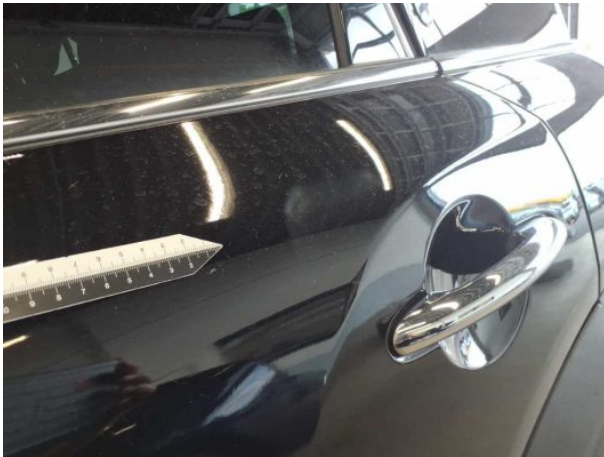
Beschädigung #13: Tür hinten links: Tür - nicht fachgerecht instandgesetzt - instandsetzen und lackieren
