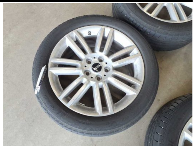
Beschädigung #6: 2.Radsatz: 1 Leichtmetallfelge - verkratzt / verschürft - Wertminderung
