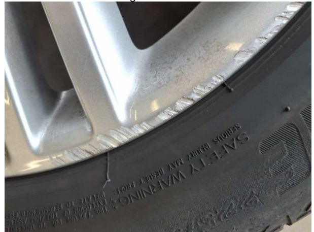
Beschädigung #6: 2.Radsatz: 1 Leichtmetallfelge - verkratzt / verschürft - Wertminderung
