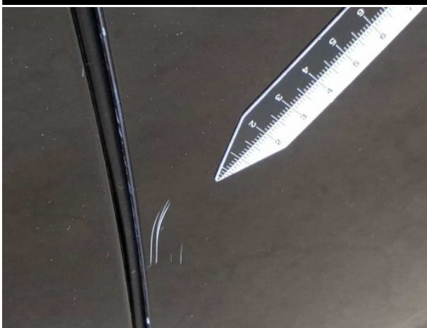
Beschädigung #14: Tür vorn rechts: Tür - Kratzer - instandsetzen und lackieren
