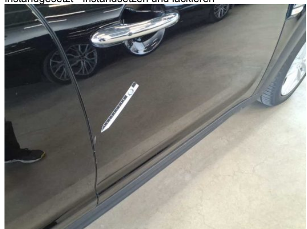
Beschädigung #14: Tür vorn rechts: Tür - Kratzer - instandsetzen und lackieren
