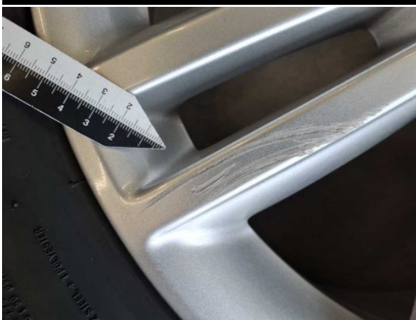
Beschädigung #7: 2.Radsatz: 1 Leichtmetallfelge - Kratzer - Wertminderung
