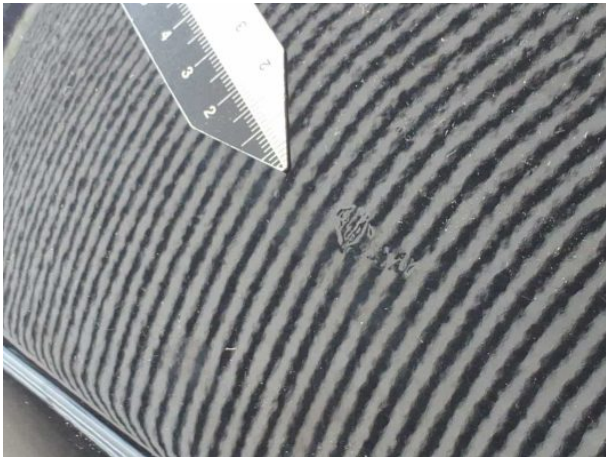
Beschädigung #16: Seitenwand rechts: Seitenwand - Delle(n) - instandsetzen und lackieren
