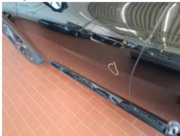
1. Tür Vorne - Links Delle Bis 20 Mm Mit Lackschaden - Smart Repair
