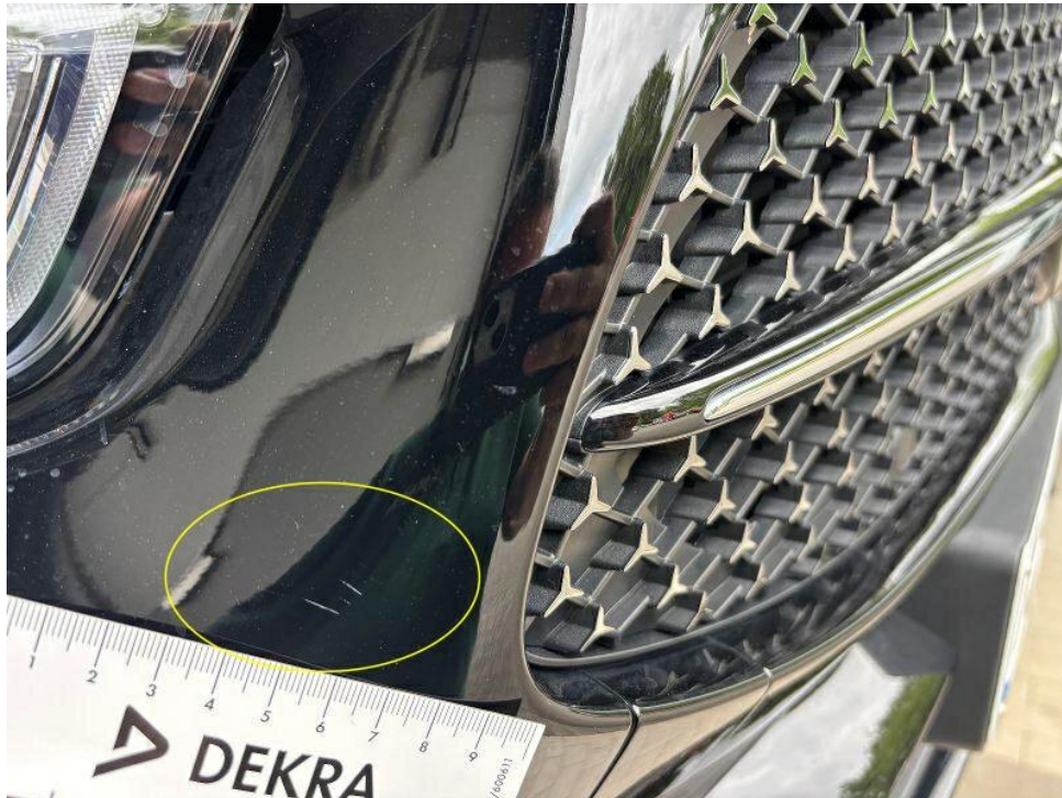
Bild 35 : Stoßfänger vorne Lackierung, zerkratzt, lackieren mit Lackaufbau
