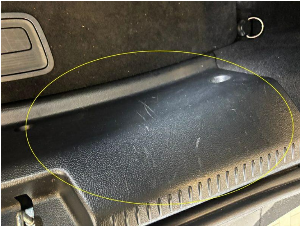
Bild 39 : Ladekantenabdeckung, verschrammt, Gebrauchsspur
