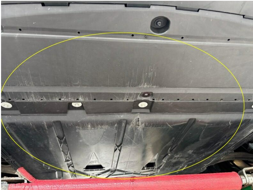
Bild 37 : Unterverkleidung vorne abgeschürft und aufgerissen
