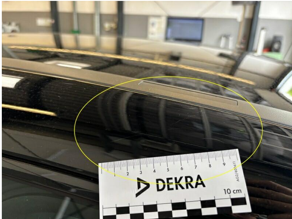
Bild 25 : Dachrahmen rechts Lackierung, verschrammt, polieren
