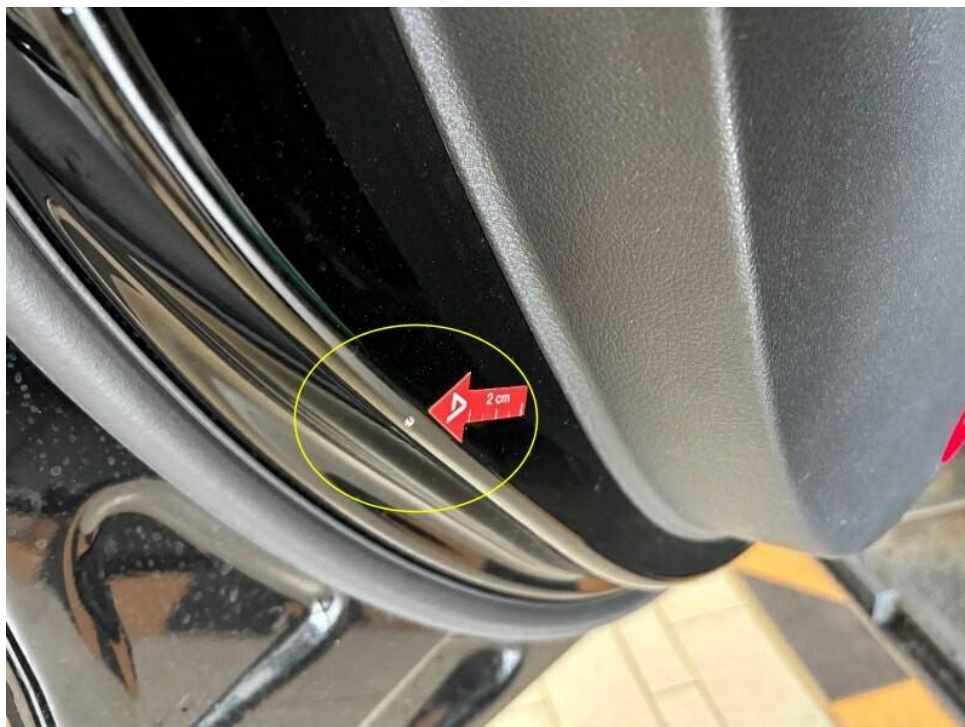
Bild 16 : Tür vorne links Türrahmen Lackierung, zerkratzt, smart repair
