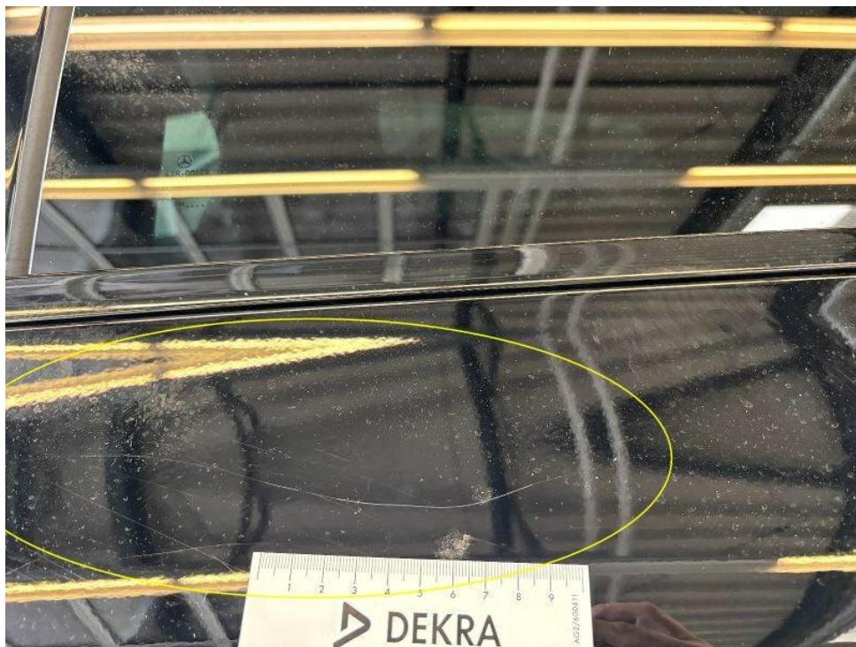
Bild 26 : Tür hinten links Lackierung, zerkratzt, lackieren mit Lackaufbau
