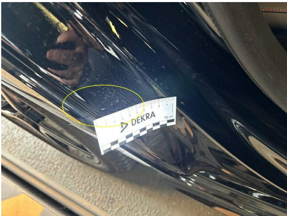
Bild 18 : Tür hinten rechts Einstieg Lackierung, zerkratzt, lackieren mit Lackaufbau
