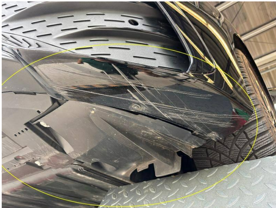
Bild 36 : Stoßfänger vorne Lackierung, zerkratzt, lackieren mit Lackaufbau Unterverkleidung vorne abgeschürft und aufgerissen
