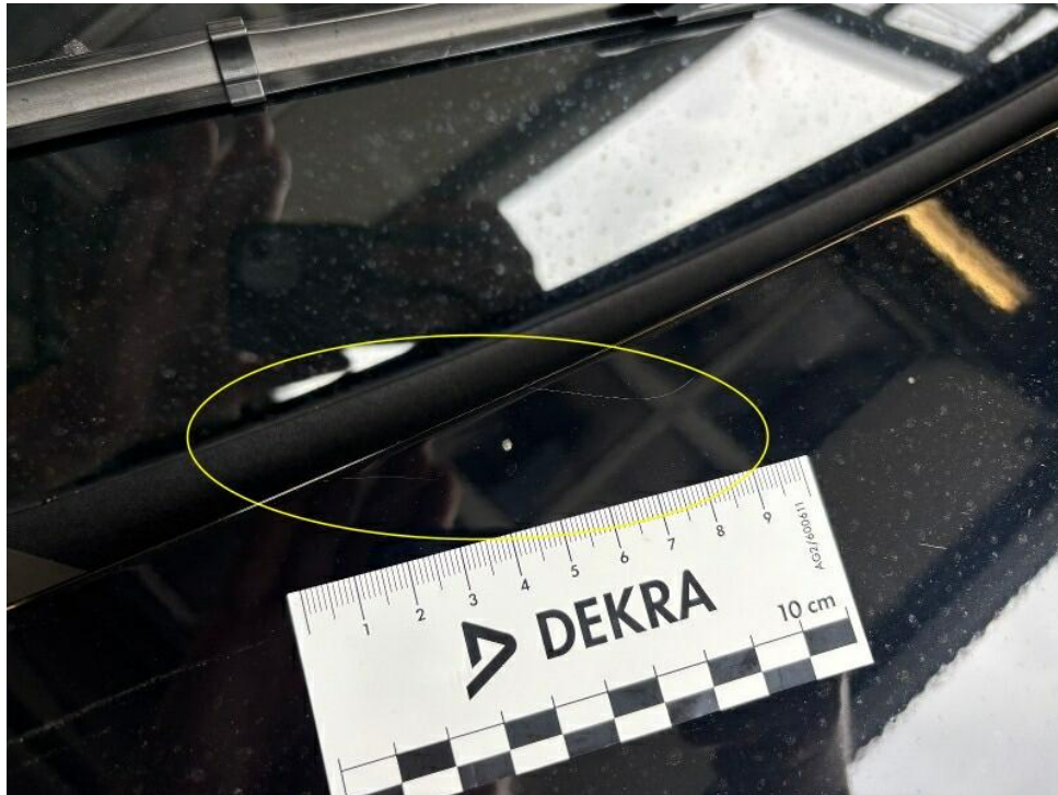
Bild 19 : Motorhaube Lackierung, verschrammt, polieren
