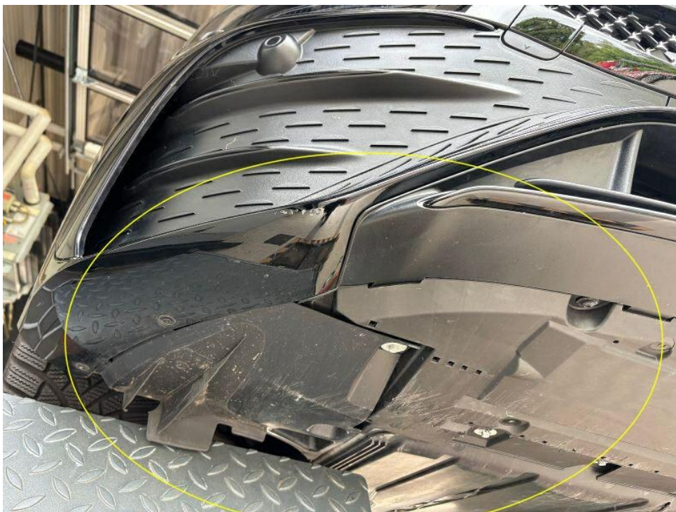
Bild 38 : Stoßfänger vorne Lackierung, zerkratzt, lackieren mit Lackaufbau Unterverkleidung vorne abgeschürft und aufgerissen
