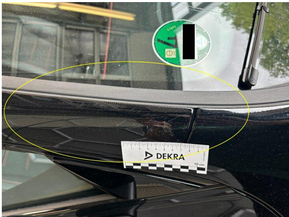
Bild 20 : A-Säule rechts Lackierung oberhalb, zerkratzt, lackieren mit Lackaufbau Kotflügel vorne rechts Lackierung, verschrammt, lackieren
