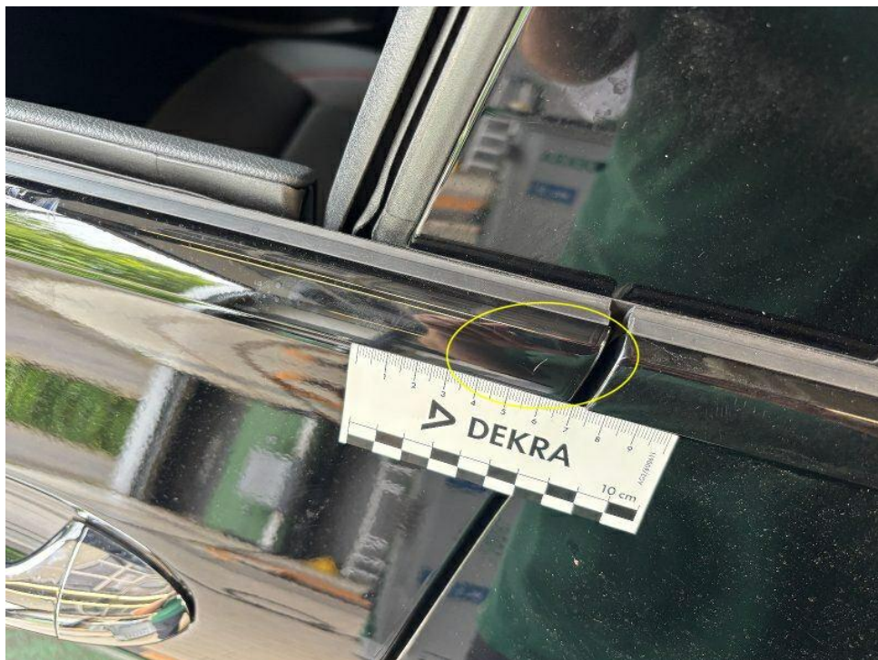
Bild 22 : Tür vorne links Schachtleiste Lackierung, zerkratzt, smart repair
