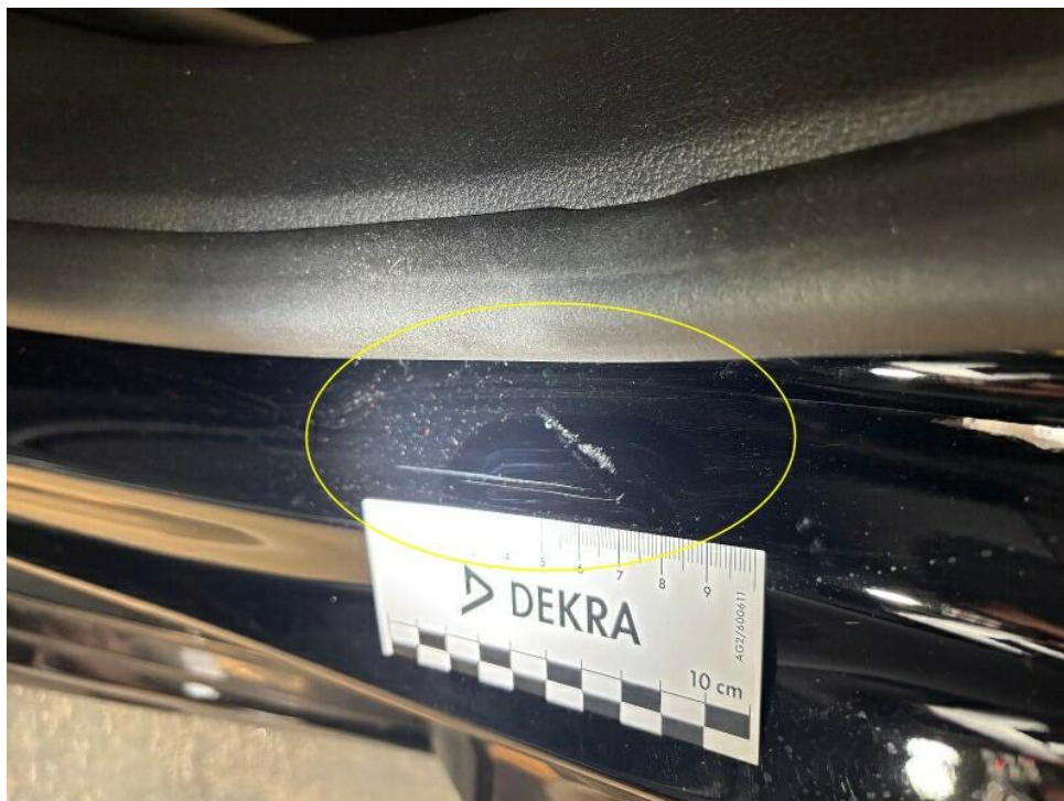
Bild 34 : Tür hinten links Einstieg Lackierung, zerkratzt, lackieren mit Lackaufbau
