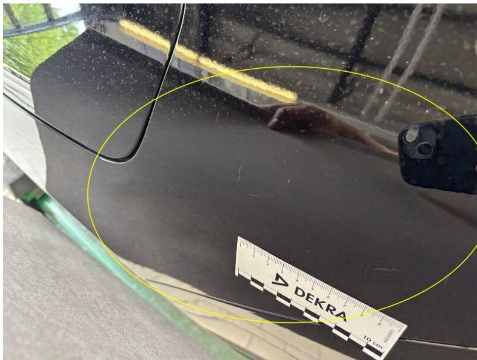
Bild 23 : Seitenteil hinten links Lackierung, verschrammt, polieren
