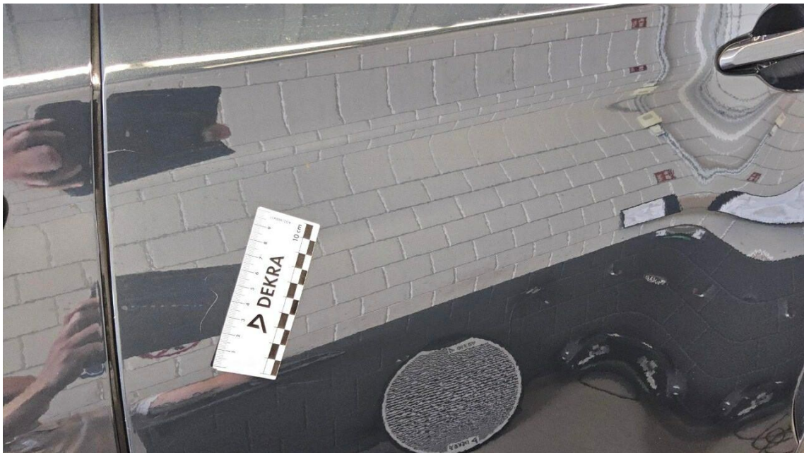
Bild 12 : Tür hinten links Lackierung, zerkratzt, lackieren mit Lackaufbau
