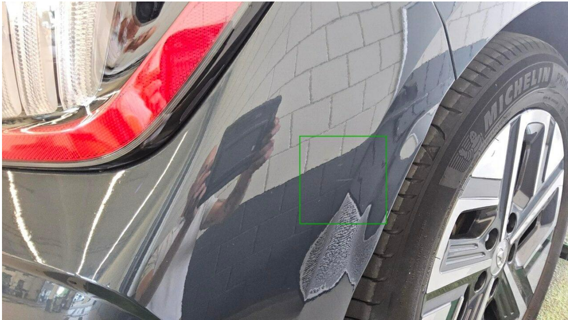
Bild 15 : Stoßfänger hinten Lackierung, verschrämmt, Gebrauchsspur
