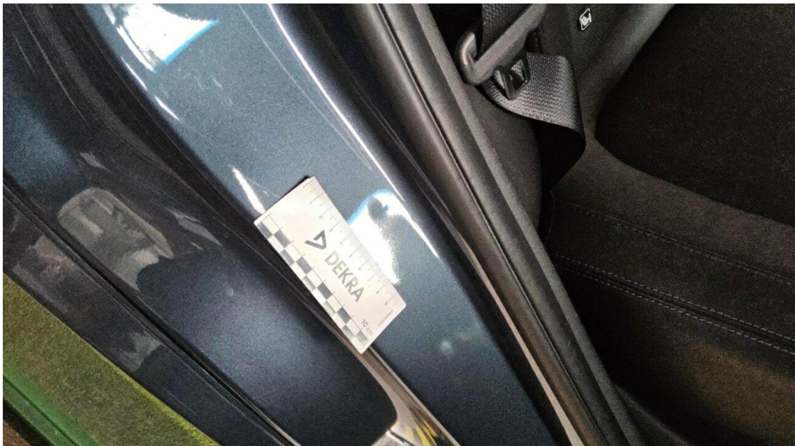
Bild 28 : Tür hinten rechts Einstieg, mehrfach eingedellt, drücken
