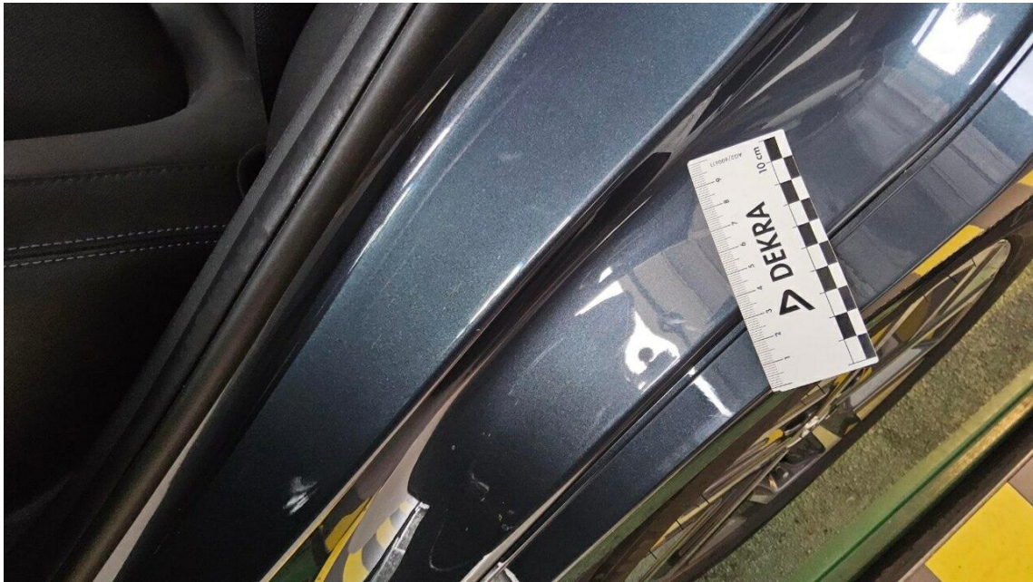
Bild 35 : Tür hinten links Einstieg, mehrfach eingedellt, instandsetzen und lackieren mit Lackaufbau
