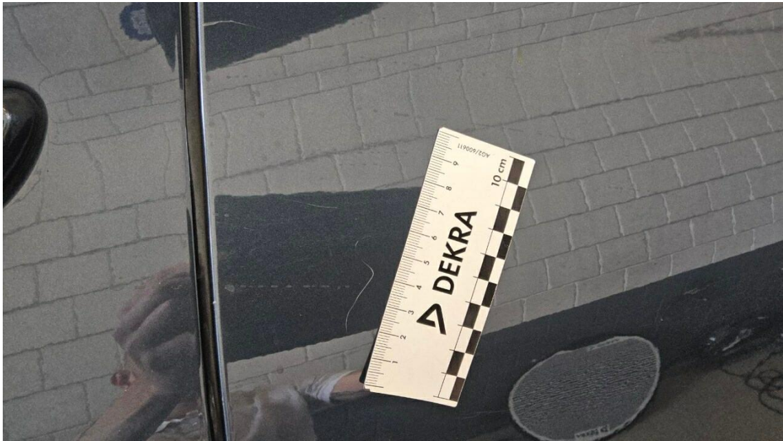
Bild 13 : Tür hinten links Lackierung, zerkratzt, lackieren mit Lackaufbau
