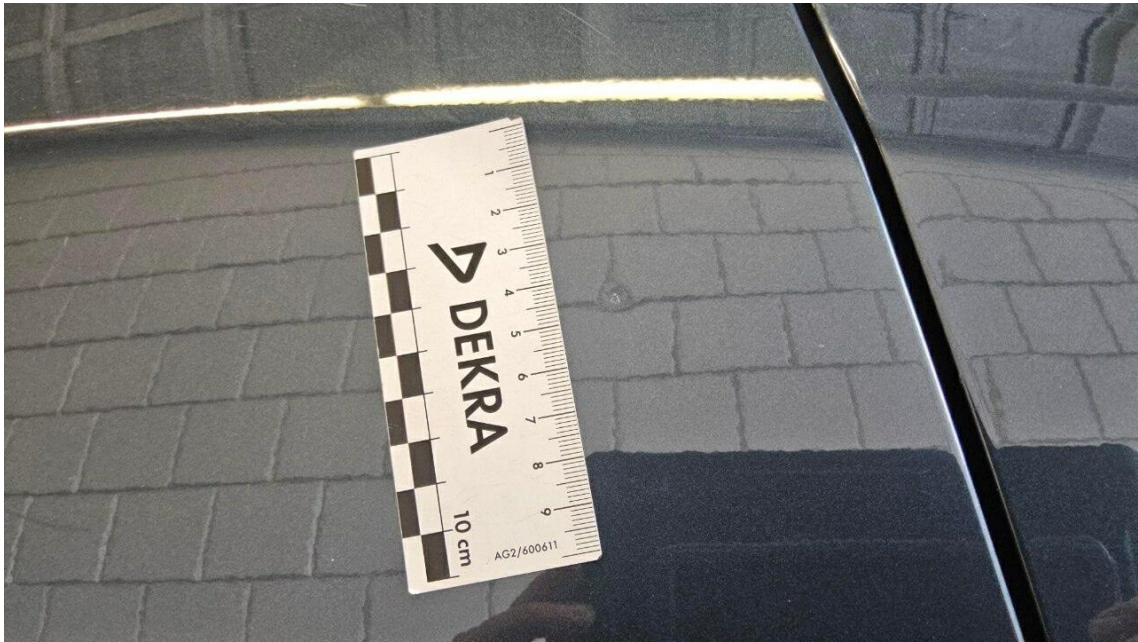
Bild 17 : Seitenteil hinten rechts, eingedellt, smart repair
