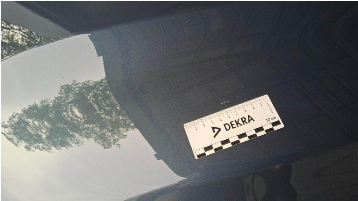
Bild 25 : Motorhaube Lackierung, zerkratzt, lackieren mit Lackaufbau
