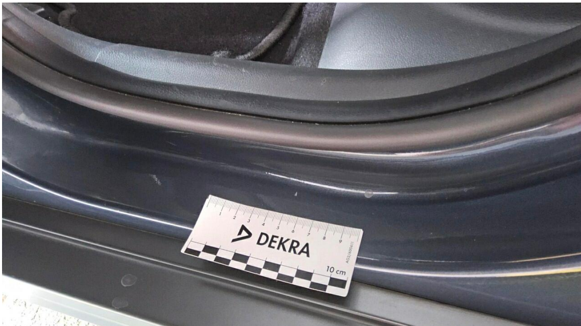
Bild 34 : Tür hinten links Einstieg, mehrfach eingedellt, instandsetzen und lackieren mit Lackaufbau
