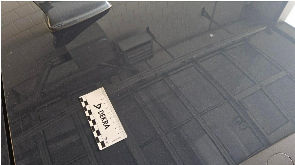
Bild 22 : Dach Lackierung, verschrämmt, Gebrauchsspur
