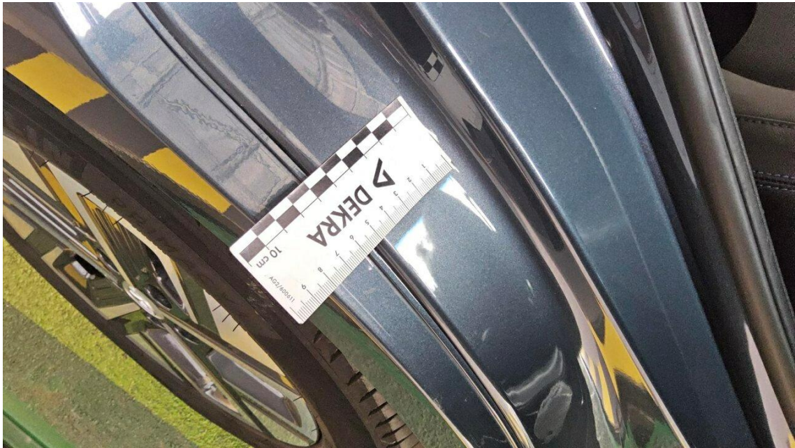
Bild 27 : Tür hinten rechts Einstieg, mehrfach eingedellt, drücken
