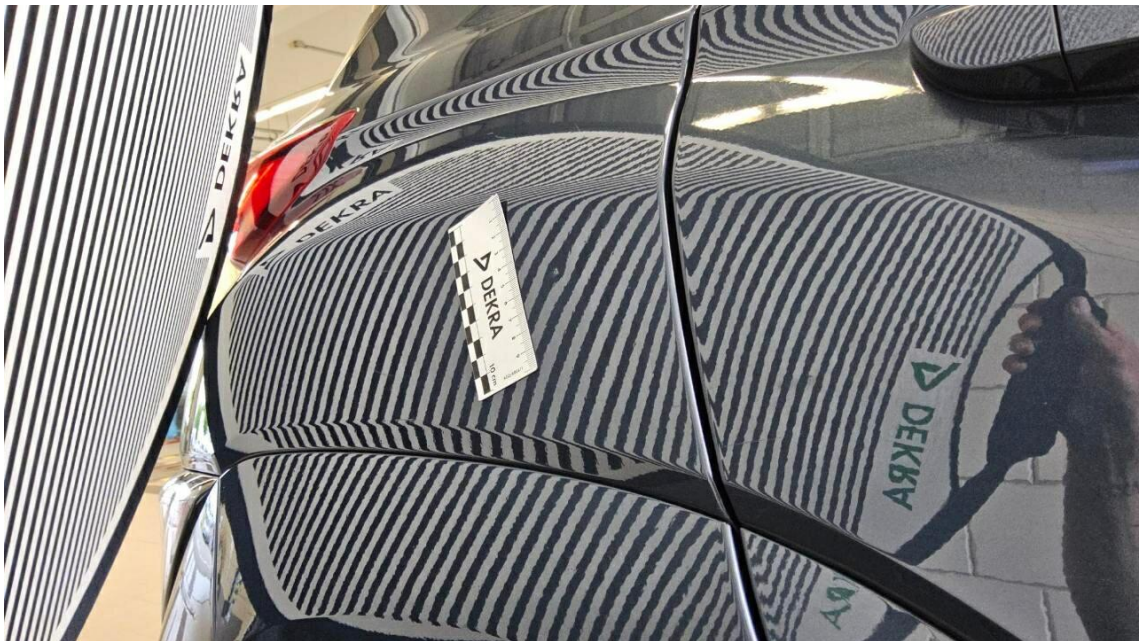
Bild 16 : Seitenteil hinten rechts, eingedellt, smart repair
