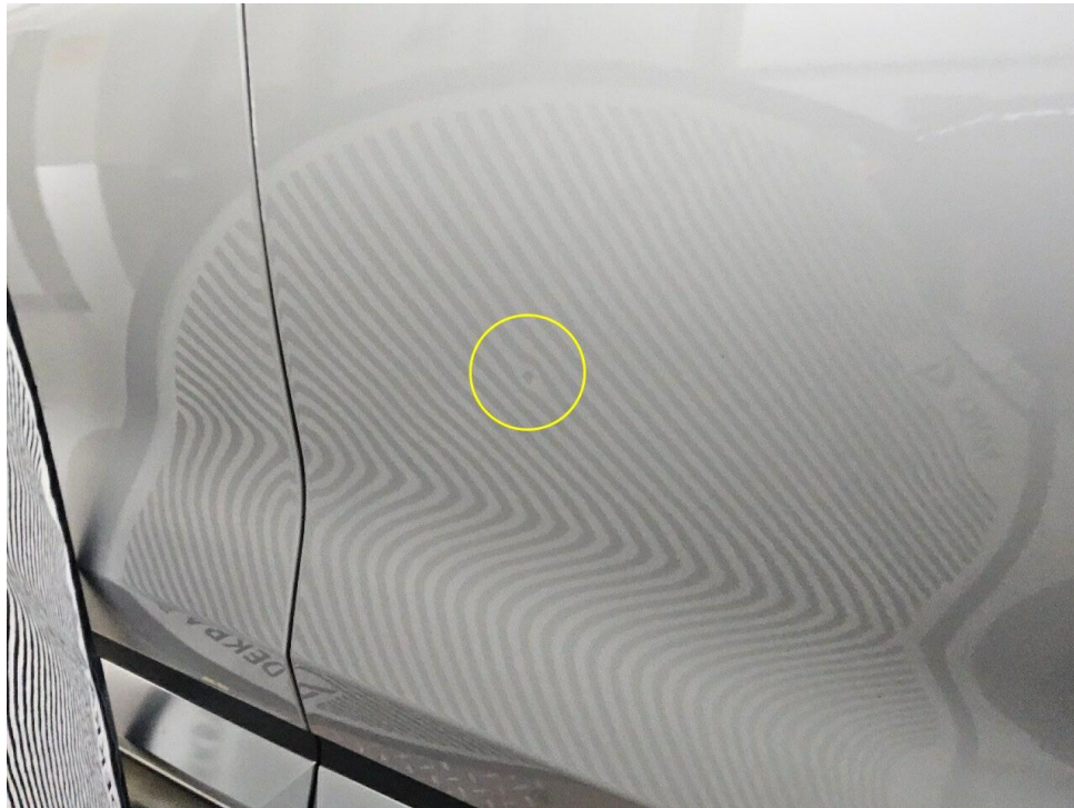
Bild 11 : Tür vorne rechts, eingedellt
