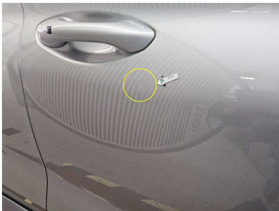
Bild 10 : Tür vorne rechts, eingedellt
