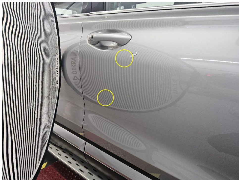
Bild 9 : Tür vorne rechts, eingedellt
