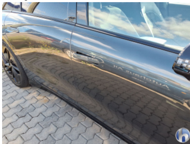
1. Tür Vorne - Rechts Verdellt - Instandsetzen und Lackieren
