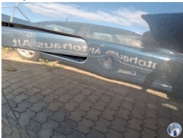
1. Tür Vorne - Rechts Verdellt - Instandsetzen und Lackieren
