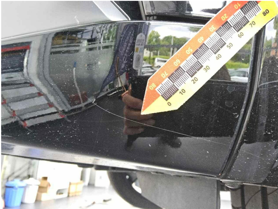
Bild 13 : Stoßfänger vorne links zerkratzt, Poliersversuch, Schadenerweiterung möglich
