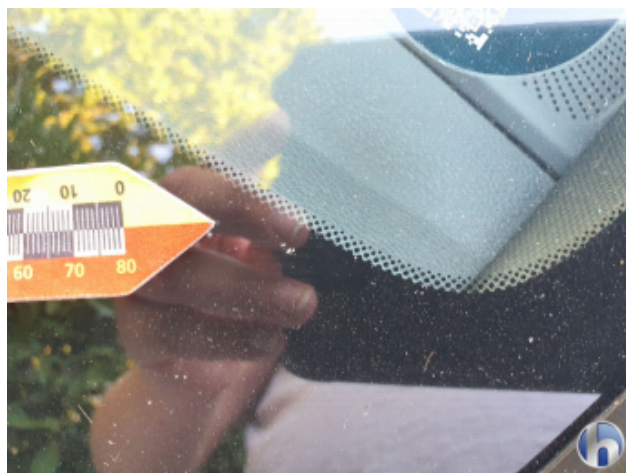
3. Windschutzscheibe Gebrauchsspuren - Ohne Reparatur
