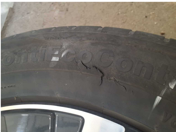
Damage 3: 2nd wheel set: 1 tyre (Flankenbeschädigung) - Broken / torn - Replace
