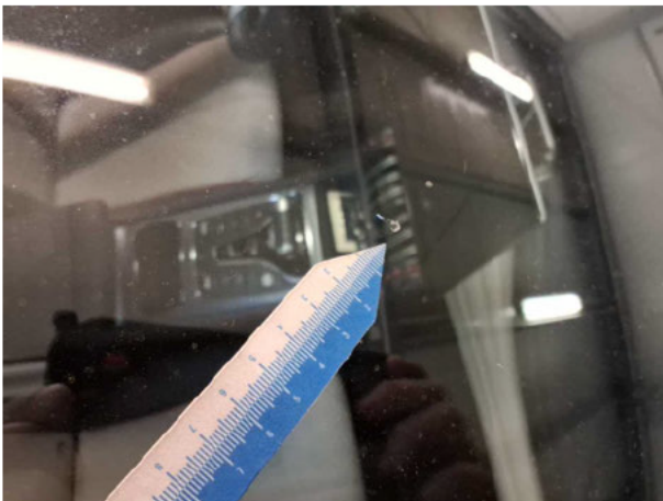
Beschädigung #6: Verglasung: Frontscheibe - Steinschlag - erneuern
