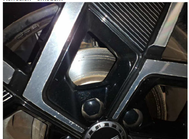
Beschädigung #5: Bremsanlage: Bremsscheiben vorn - Korrosion - erneuern
