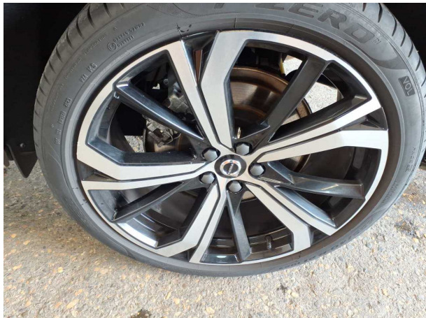
Beschädigung #1: Rad/Reifen: Leichtmetallfelge hinten links - Kratzer - Wertminderung
