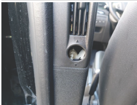
Lüftungsgitter / Hinten Links / Fehlt
