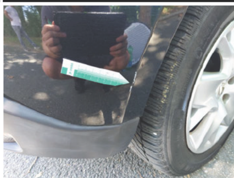
Stoßfänger / Hinten Rechts / Kratzer
