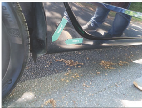
Schweller / Rechts / Rost
