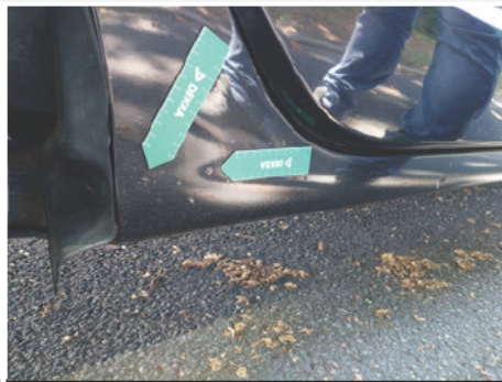
Schweller / Rechts / Rost
