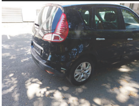
Stoßfänger / Hinten Rechts / Kratzer
