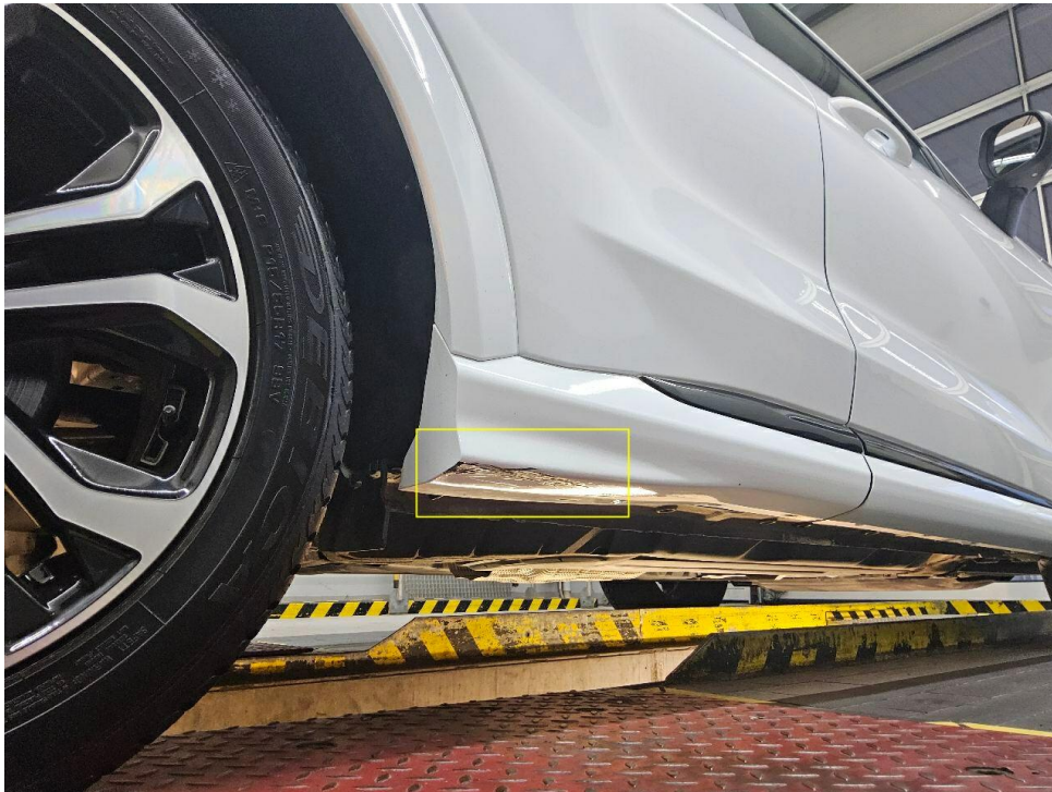
Bild 7 : Tür hinten rechts Schutzleiste, zerkratzt
