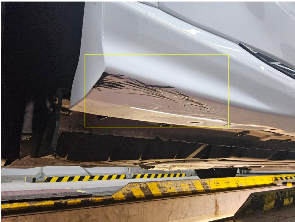
Bild 8 : Tür hinten rechts Schutzleiste, zerkratzt
