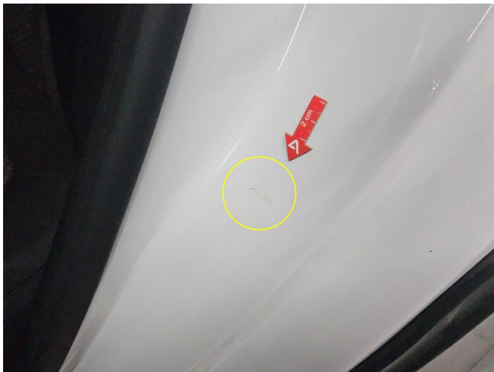
Bild 10 : Tür hinten links Einstieg, zerkratzt
