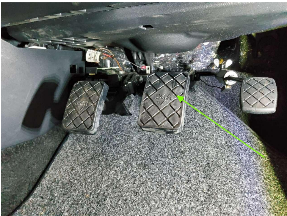
Bild 14 : Ehemaliges Fahrschulfahrzeug, zusätzliche Pedalerie und Schalter sowie Spiegel verbaut
