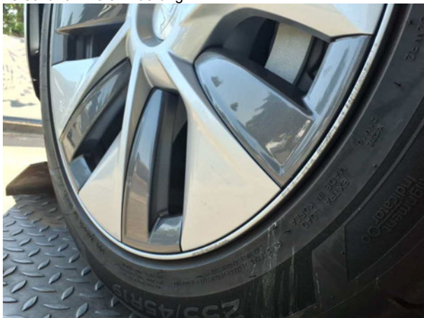
Beschädigung #4: Rad/Reifen: Leichtmetallfelge vorn links - verkratzt... verschürft - Wertminderung
