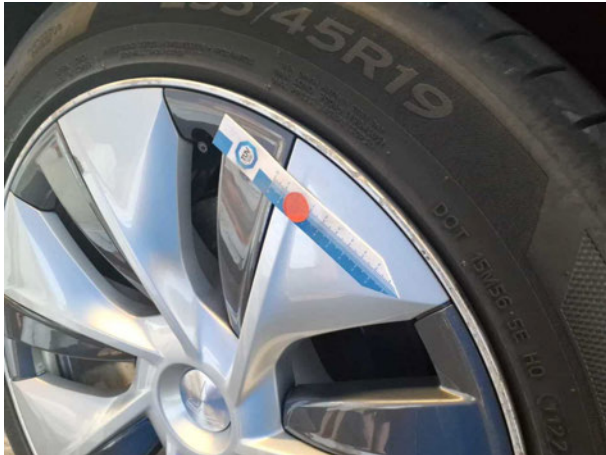
Beschädigung #3: Rad/Reifen: Leichtmetallfelge hinten rechts - Kratzer - Wertminderung
