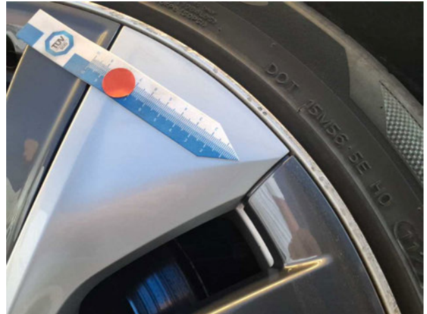
Beschädigung #3: Rad/Reifen: Leichtmetallfelge hinten rechts - Kratzer - Wertminderung
