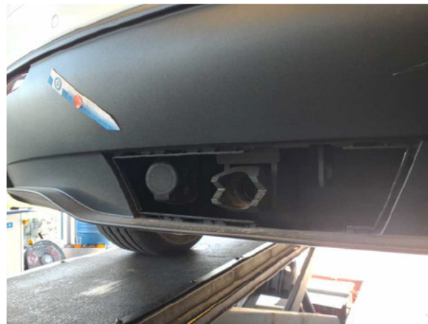
Beschädigung #1: Stossfänger hinten: Stossfänger hinten (Blende AHK) - fehlt - erneuern
