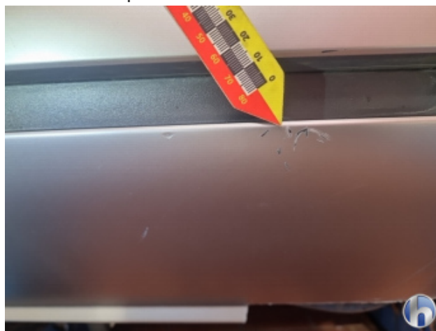
6. Stoßfänger Hinten Kratzer - Lackieren
