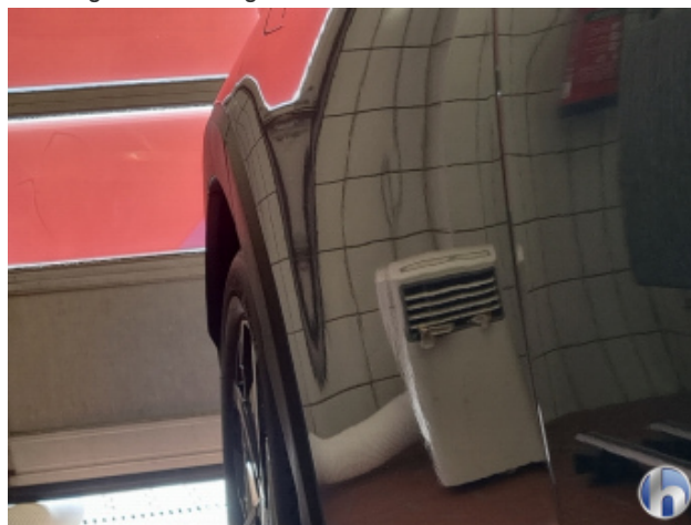
1. Tür Hinten - Rechts Unsachgemäß Instandgesetzt - Instandsetzen und Lackieren
