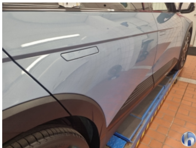
1. Tür Hinten - Rechts Unsachgemäß Instandgesetzt - Instandsetzen und Lackieren
