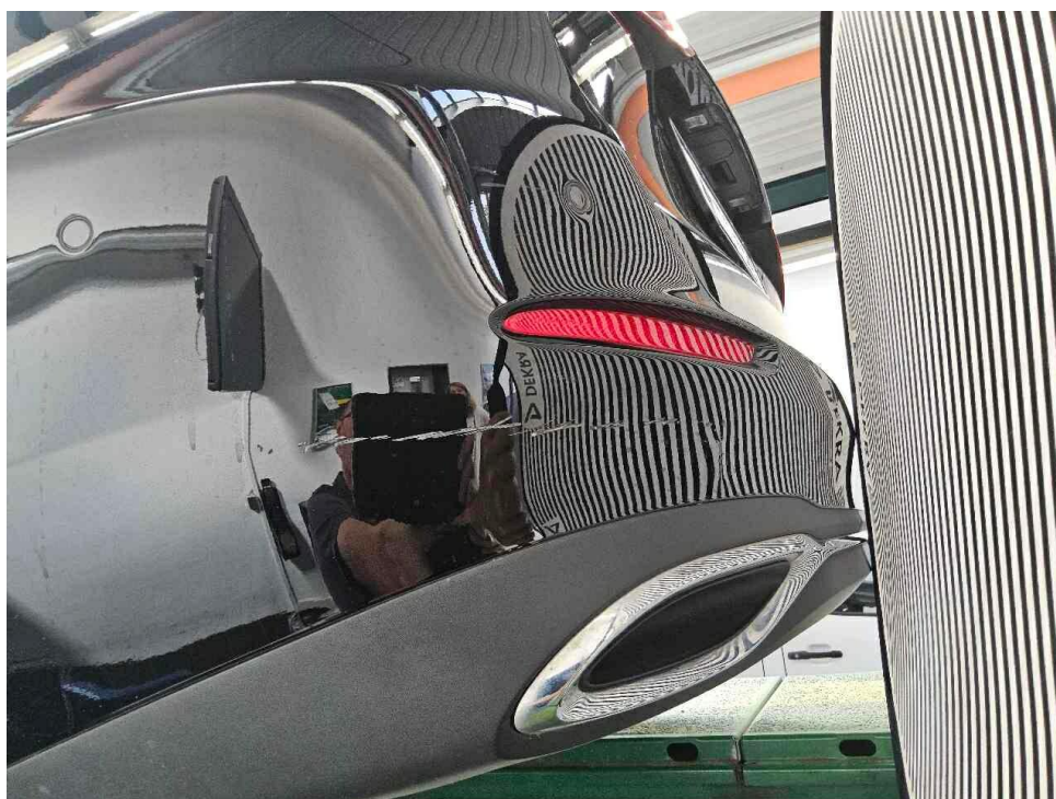
Bild 16 : Stoßfänger hinten linksseitig verschürft und verformt
