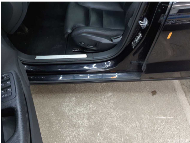
Beschädigung #19: Tür vorn links: Türdichtung - beschädigt - erneuern
