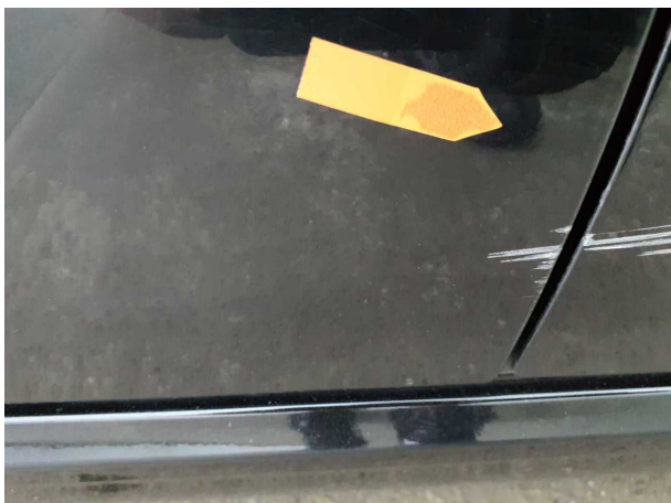
Beschädigung #23: Tür hinten rechts: Tür - Kratzer - lackieren
