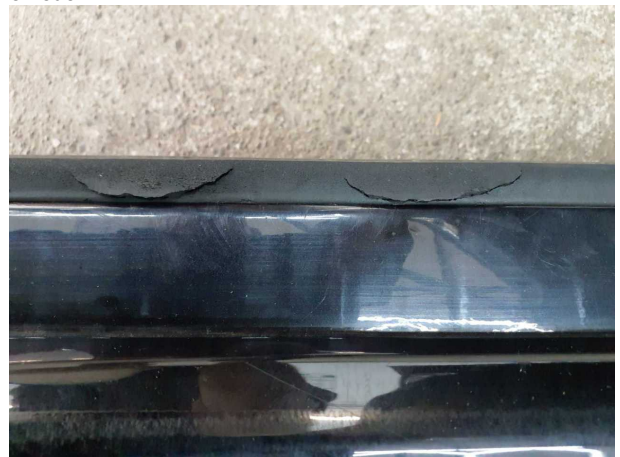
Beschädigung #19: Tür vorn links: Türdichtung - beschädigt - erneuern
