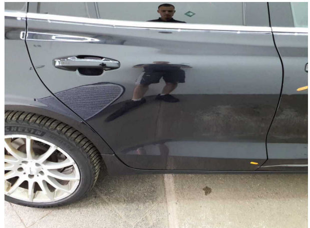
Beschädigung #23: Tür hinten rechts: Tür - Kratzer - lackieren
