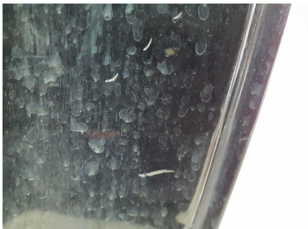
Beschädigung #9: Seitenwand links: Einstieg - Kratzer - Smart Repair
