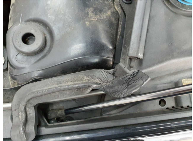
Beschädigung #6: Motorhaube: Dämmmatte (Füllstoff rechts und links) - verformt - Wertminderung
