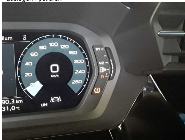
Beschädigung #5: Instrumententafel: Kontrollleuchte (Riefendruck) - Befund festlegen - befunden ggf. instandsetzen
