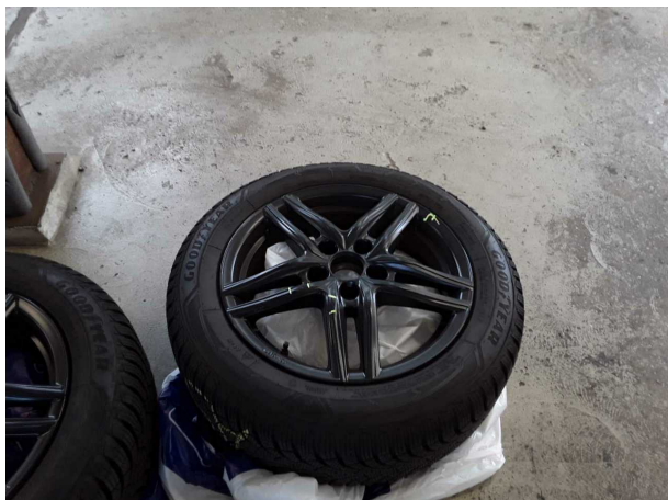
Beschädigung #2: 2.Radsatz: 1 Leichtmetallfelge - verkratzt / verschürft - kein Abzug
