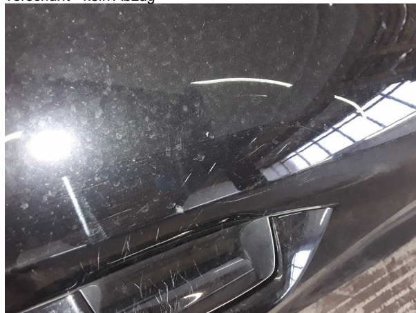
Beschädigung #3: Tür hinten rechts: Tür - verkratzt / versch... - auslegen / polieren
