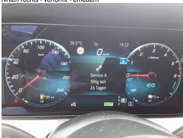
Beschädigung #7: Sonstiges: Inspektion/Wartung - fällig - erneuern
