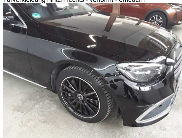
Beschädigung #8: Kotflügel rechts: Kotflügel rechts - verformt - instandsetzen und lackieren
