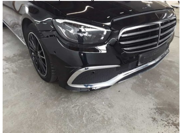
Beschädigung #11: Stossfänger vorn: Stossfänger mit Parktronic (Laut Ga.) - beschädigt - erneuern
