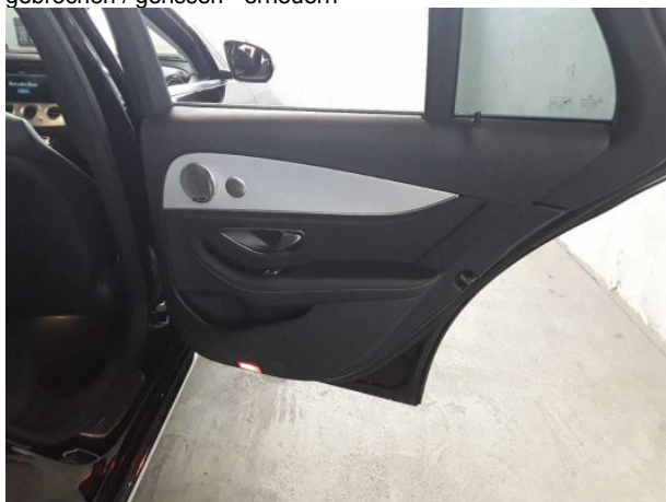
Beschädigung #6: Verkleidungen/Abdeckungen: Türverkleidung hinten rechts - verformt - erneuern
