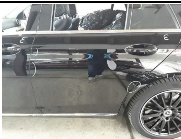
Beschädigung #9: Tür hinten links: Tür - verkratzt / verschürft... lackieren
