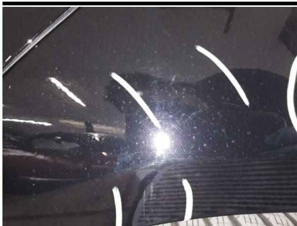
Beschädigung #10: Seitenwand links: Seitenwand - Delle / Lackschaden - instandsetzen und lackieren
