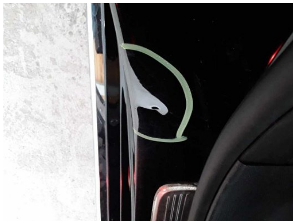
Beschädigung #1: Seitenwand rechts: Einstieg - Delle / Lackschaden - Smart Repair
