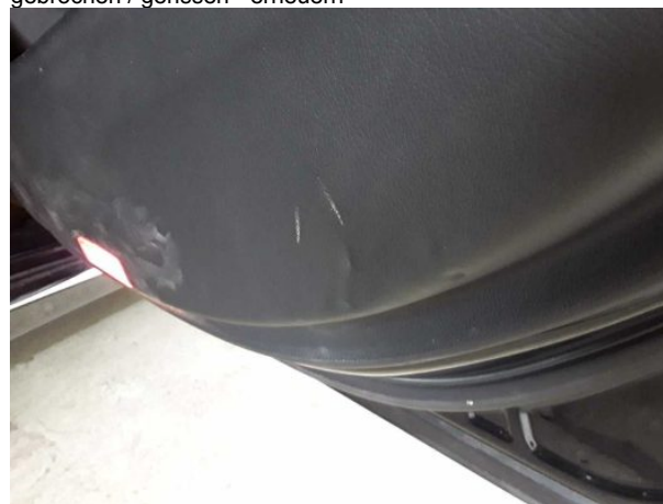
Beschädigung #6: Verkleidungen/Abdeckungen: Türverkleidung hinten rechts - verformt - erneuern
