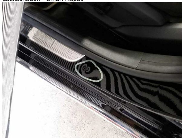
Beschädigung #2: Schweller links: Einstieg - Delle(n) - Smart Repair
