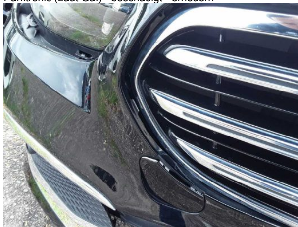
Beschädigung #11: Stossfänger vorn: Stossfänger mit Parktronic (Laut Ga.) - beschädigt - erneuern
